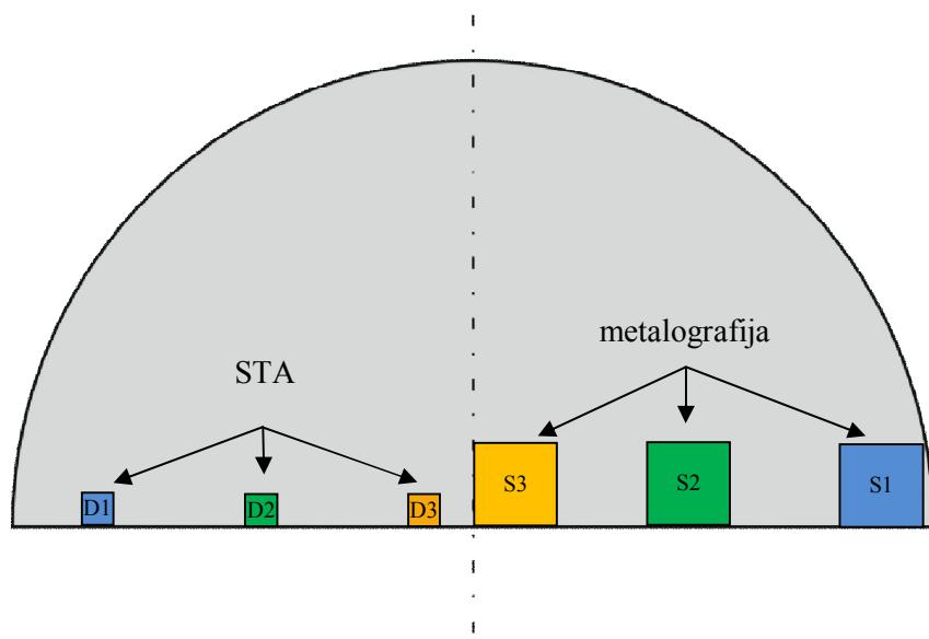
Slika 3.25 Shematski prikaz uzimanja uzorka za STA analizu
