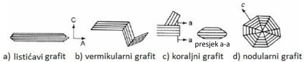
Slika 2.18 Rast različitih tipova grafita [68]
