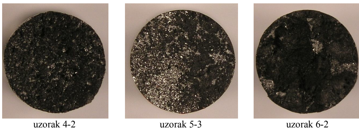
Slika 4.74 Prijelomne površine epruveta za statičko vlačno ispitivanje
