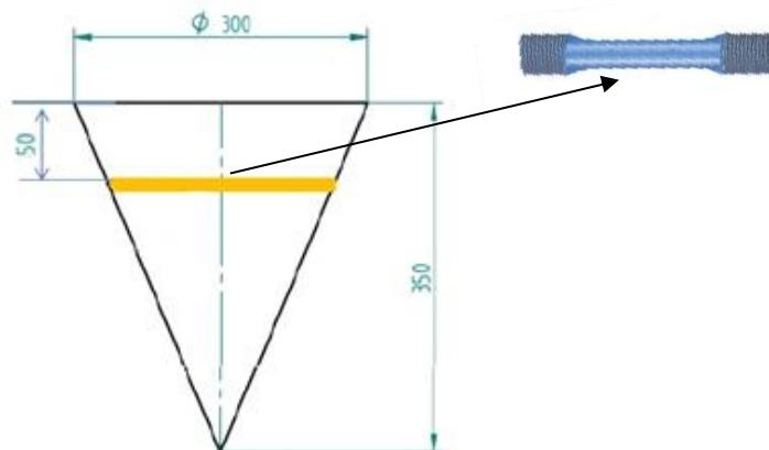
Slika 3.26 Mjesta uzimanja epruveta za statičko vlačno ispitivanje
