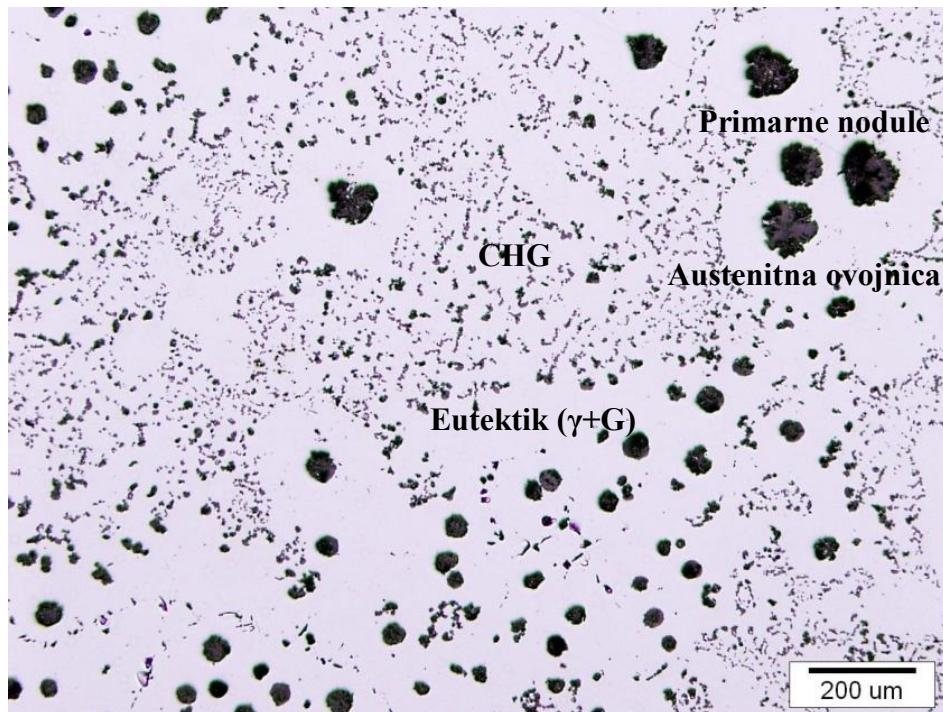
Slika 4.37 Različite morfologije grafita uočene u mikrostrukturi uzorka 7-S2, polirano stanje
