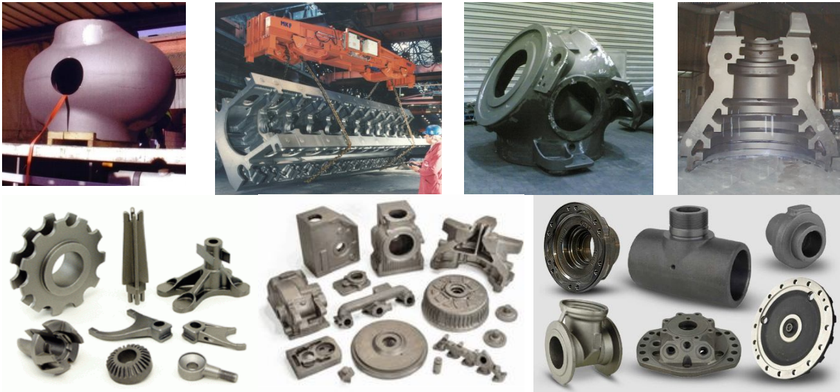
Slika 2.2 Primjeri odljevaka od nodularnog lijeva [30]
