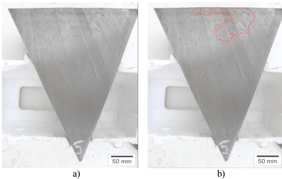
Slika 4.15 Određivanje udjela CHG područja na poprečnom presjeku stošca 5 a) makroslika
