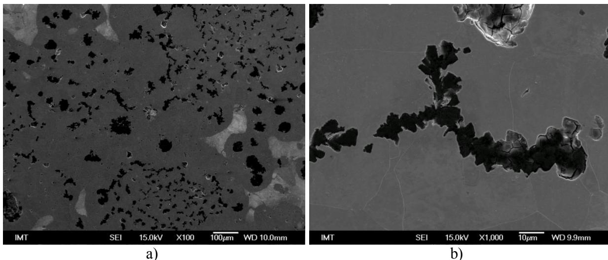
Slika 4.38 SEM slika grubljeg oblika chunky grafita u graničnom području čelija chunky grafita (uzorak 11-S2): a) manje povećanje, b) veće povećanje (izdvojena nit)
