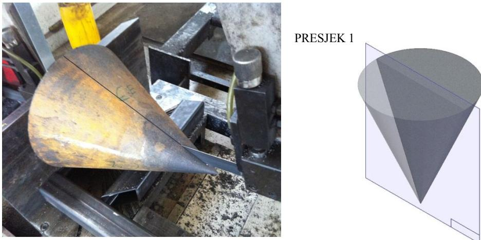
Slika 3.18 Poprečni presjek kroz sredinu stošca uzduž vertikalne ravnine simetrije
