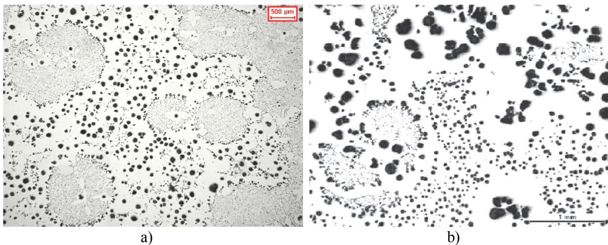
Slika 2.37 Chunky grafit (svjetlosni mikroskop, polirano stanje):
