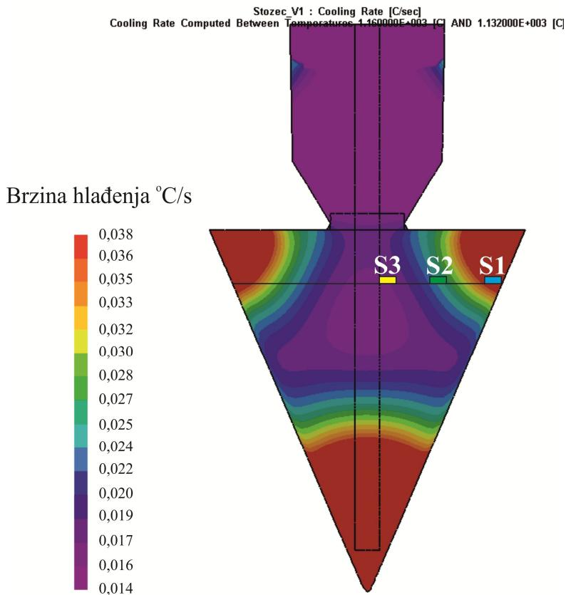
Slika 3.20 Određivanje mesta uzimanja uzorka za metalografsku analizu prema brzini hlađenja dobivenoj simulacijom skrućivanja (softver ProCAST®)
