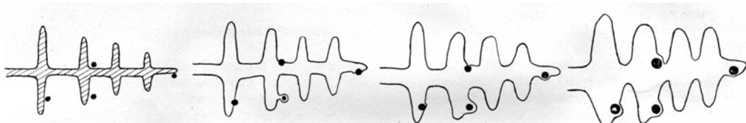
Slika 2.27 Slijed skrućivanja eutektičkog nodularnog lijeva prema Engleru i Ellerbroku [84]
