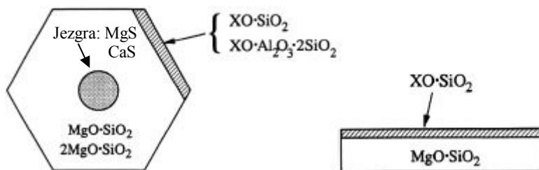
Slika 2.16 Promjena sastava na površini uključaka nakon cijepljenja [66]
