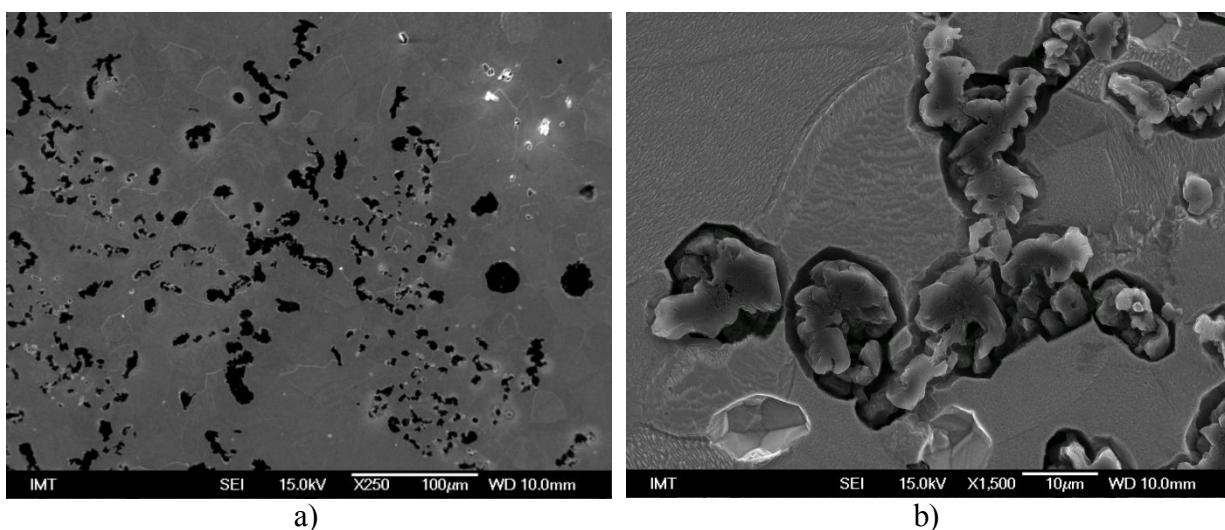
Slika 4.36 SEM slika graničnih područja ćelija chunky grafta s grublјim oblikom CHG (uzorak 7-S2): a) manje povećanje, b) veće povećanje, duboko nagrizanje
