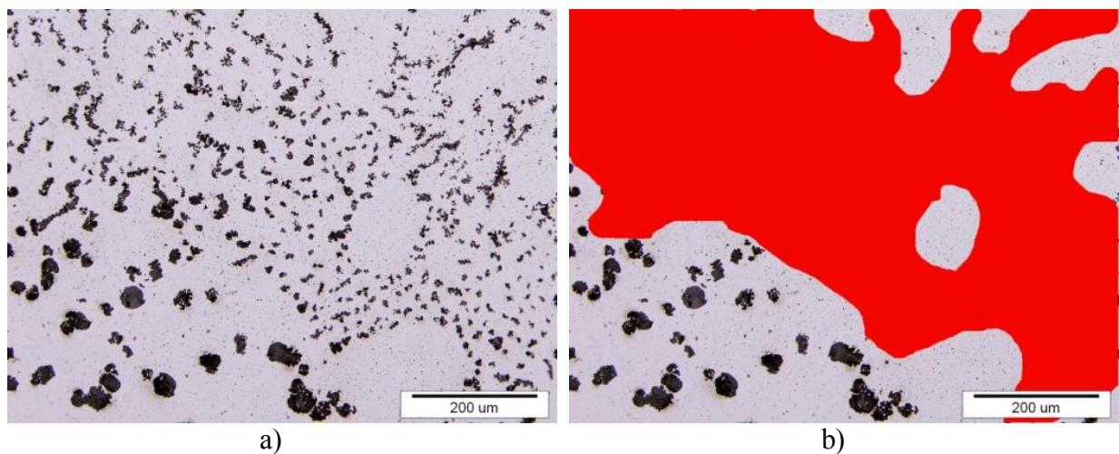
Slika 4.42 Određivanje udjela područja chunky grafića na slikama mikrostrukture:
