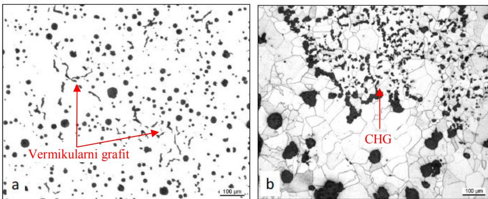
Slika 2.40 Mikrostruktura vermkularnog (a) i chunky grafita (b) u nodularnom lijevu [10]
