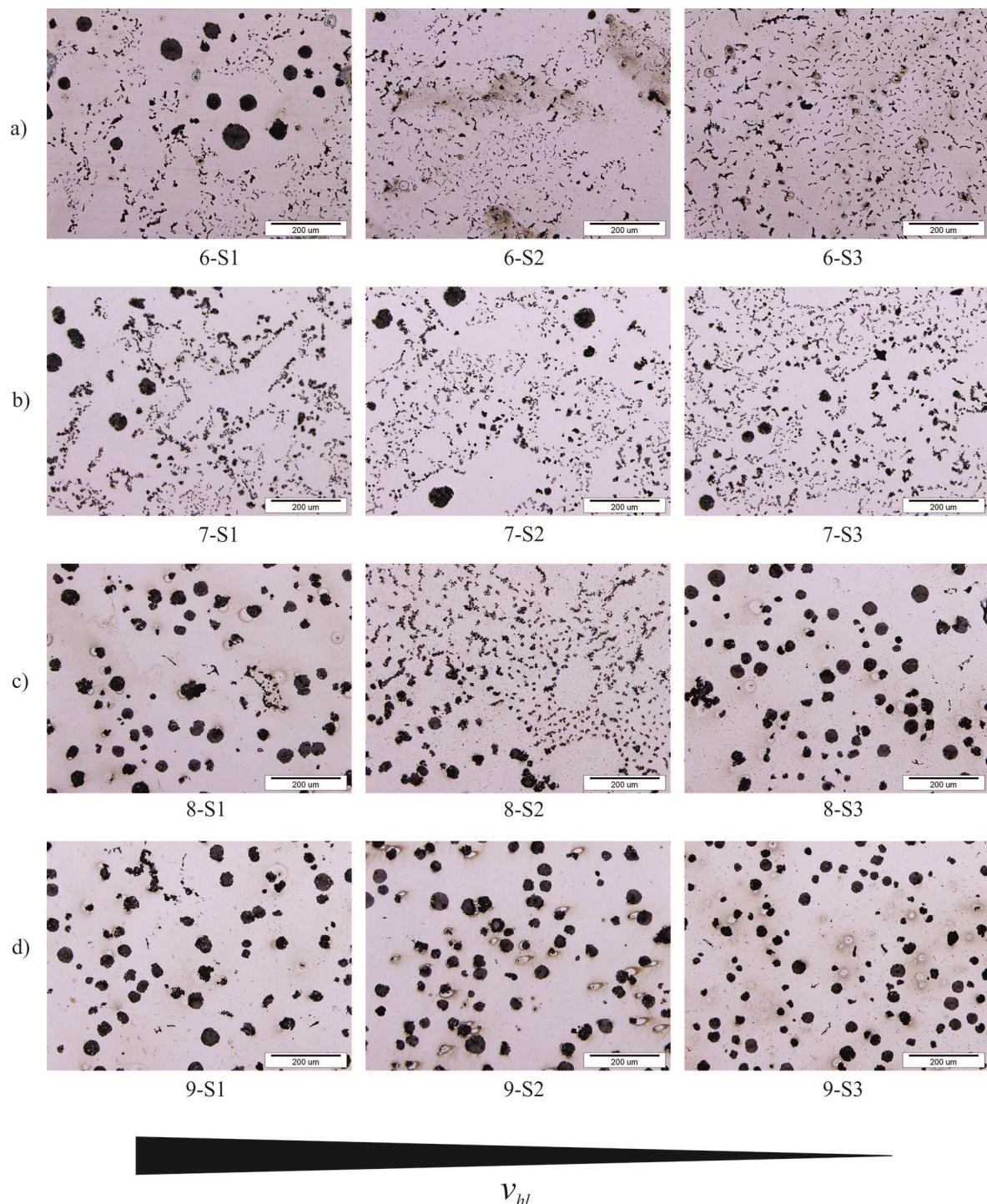
Slika 4.19 Mikrostruktura stožaca 6 do 9 (EN-GJS-400-15 s 3,5 % Si), polirano:
