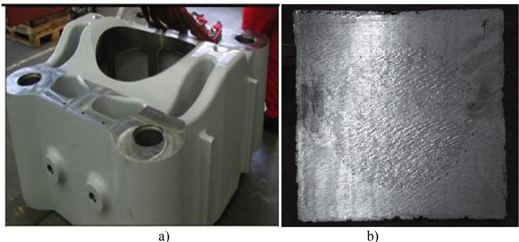
Slika 2.36 a) Karakterističan debelostijeni odljevak (dio preše), b) područje chunky grafta u toplinskom centru odljevka vidljivo kao tamnije područje nakon reza pilom [17]
