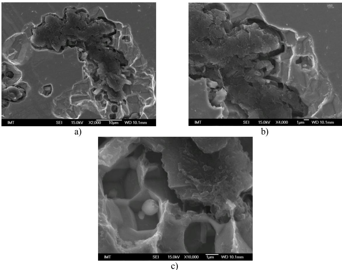
Slika 4.51 Uključci u chunky grafitu nakon dubokog nagrizanja (uzorak 11-S2): a) manje povećanje, b) veće povećanje, c) veliko povećanje
