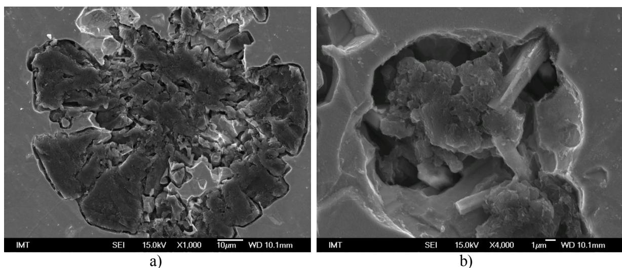
Slika 4.52 SEM slika uključaka u prijelaznim oblicima grafita (11-S2), duboko nagrizanje, a) manje povećanje b) veće povećanje
