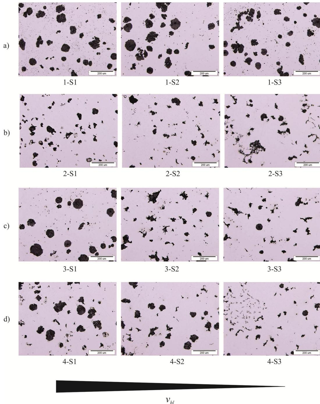
Slika 4.18 Mikrostruktura stožaca 1 do 4 (EN-GJS-400-15), polirano: a) cijepljenje u lonac, b) cijepljenje u lonac + 0,01 % Bi, c) cijepljenje u mlaz, d) cijepljenje u mlaz + 0,01 % Bi
