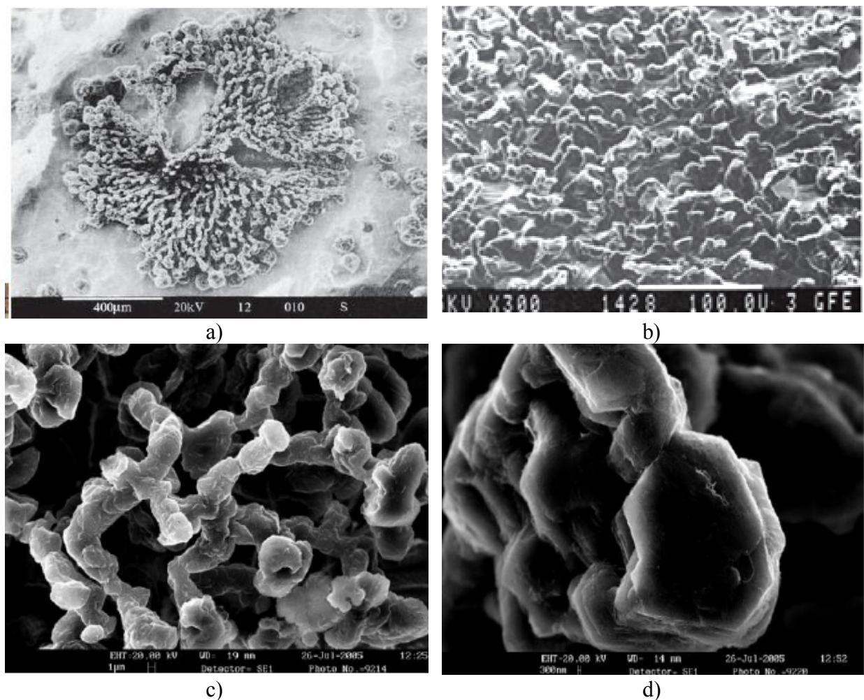
Slika 2.38 Mikrostruktura chunky grafita (SEM, duboko nagrizanje): a) celija chunky grafita, b) celija chunky grafita, veće povećanje, c) niti chunky grafita, veće povećanje, d) nodula na kraju niti chunky grafita, veliko povećanje) [9,17]
