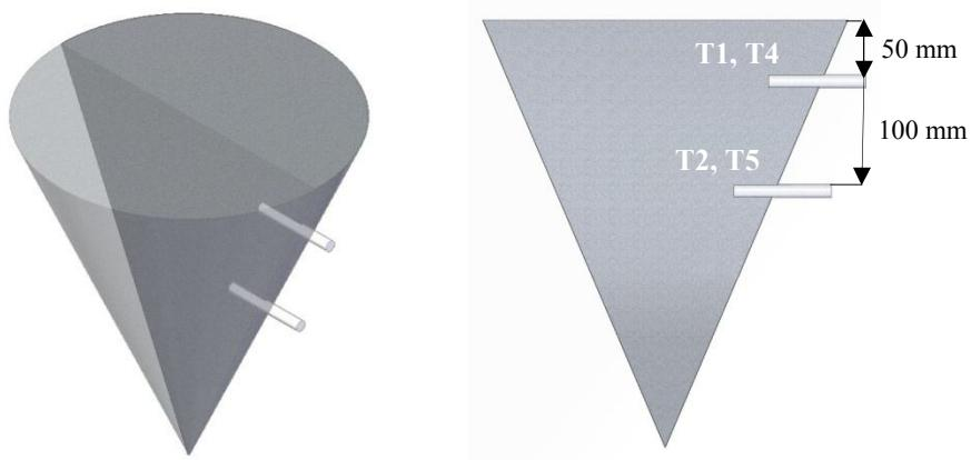
Slika 3.17 Shematski prikaz smještanja termoparova u odljevak
