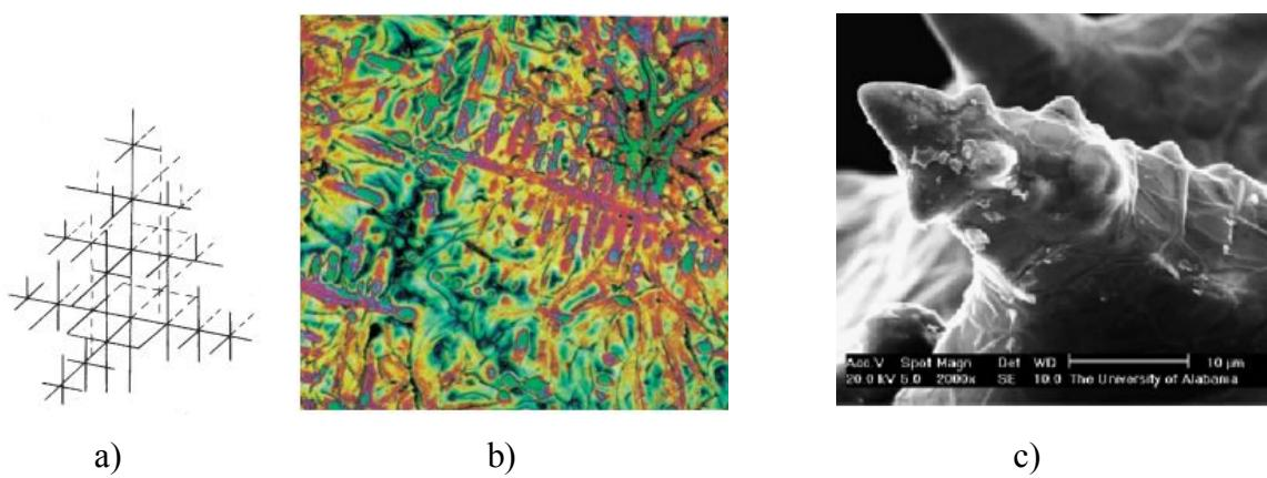
Slika 2.14 Morfologija primarnog austenitnog dendrita: a) shematski prikaz, b) nagrizanje u boji, c) SEM slika [65]
