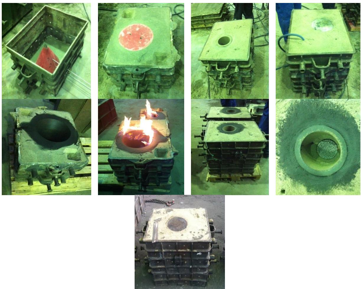
3.11 Izrada kalupa  $\text{CO}_2$  postupkom
