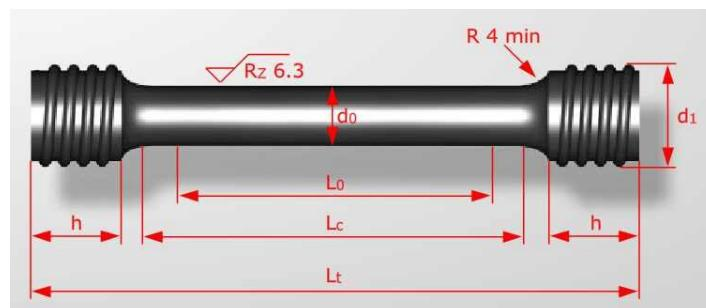
Slika 3.27 Oblik epruvete B za statičko vlačno ispitivanje
