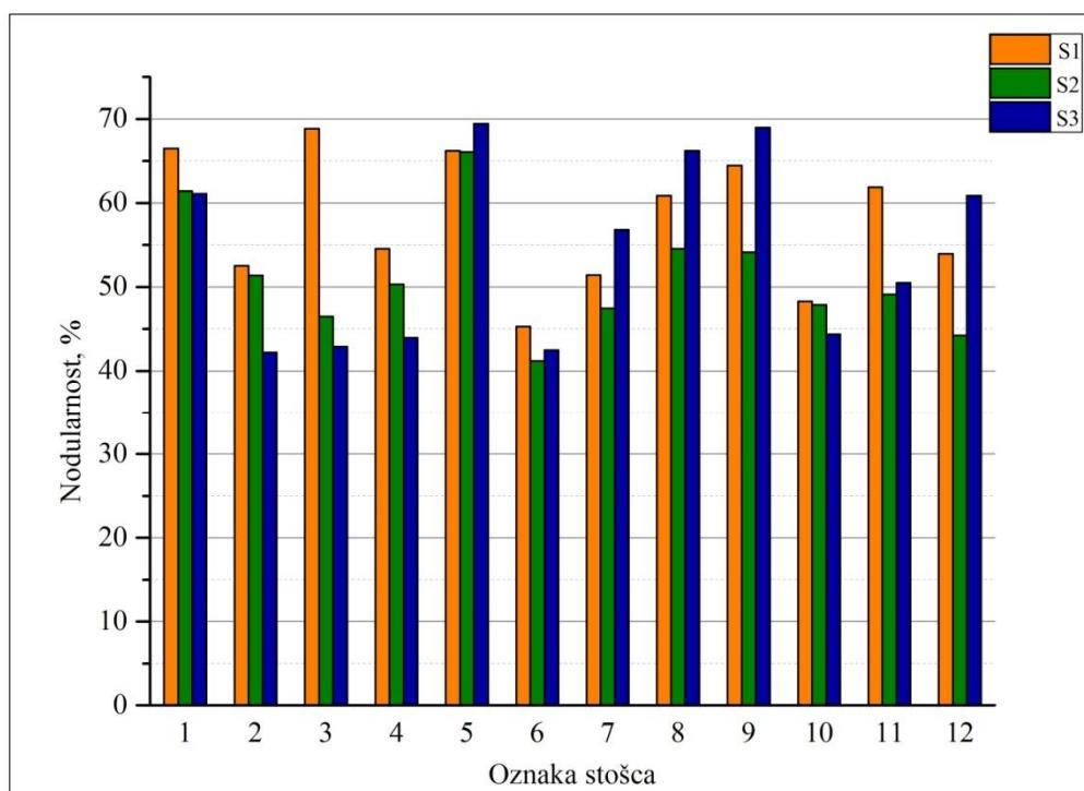
Slika 4.21 Raspodjela nodularnosti u uzorcima za metalografska ispitivanja
