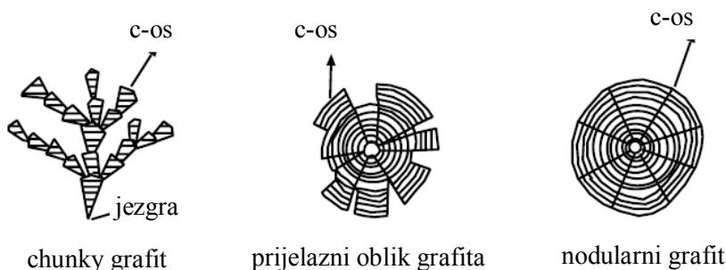
Slika 2.41 Shematski prikaz piramidalnog rasta chunky grafita [95]
