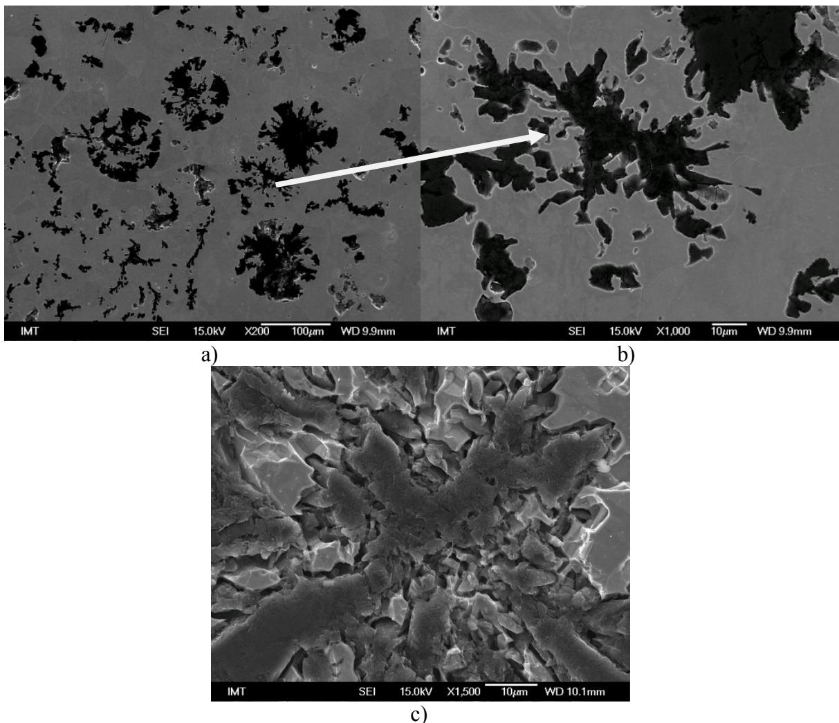
Slika 4.40 SEM slika prijelaznog oblika grafita (uzorak 11-S2): a) manje povećanje, b) veće povećanje, c) nakon dubokog nagrizanja
