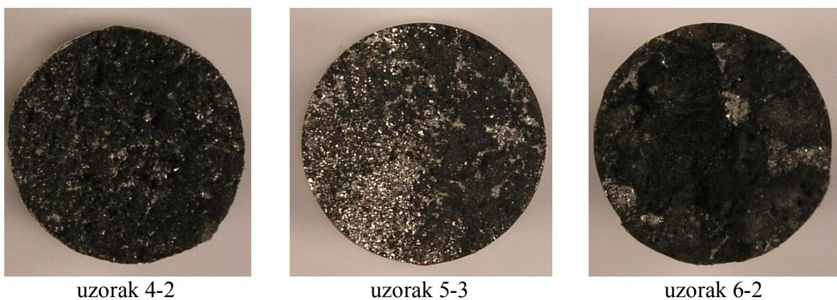
Slika 4.74 Prijelomne površine epruveta za statičko vlačno ispitivanje
