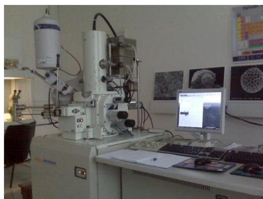
Slika 3.22 FE SEM JEOL-JSM-6500 F uređaj
