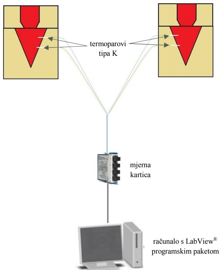
Slika 3.16 Shematski prikaz snimanja krivulja hlađenja u odljevku
