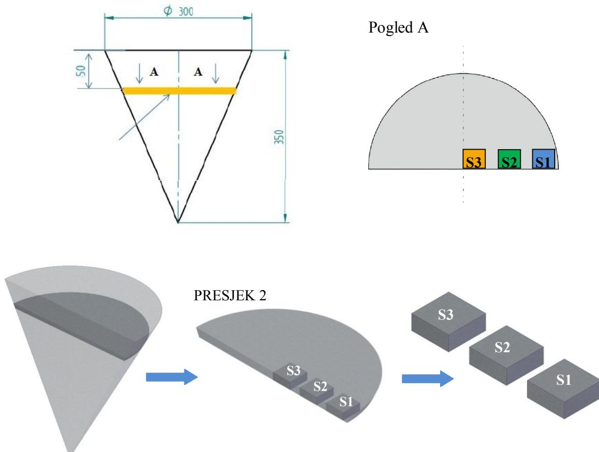
Slika 3.19 Shematski prikaz uzimanja uzoraka za mikroanalizu
