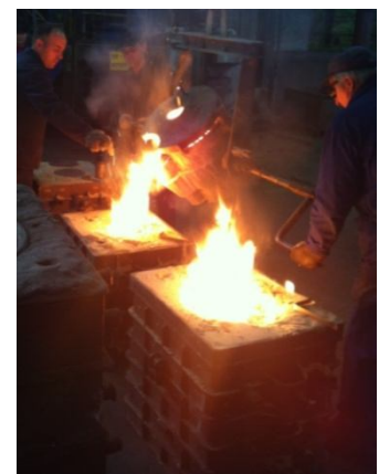
Slika 3.8 Cijepljenje u mlaz
