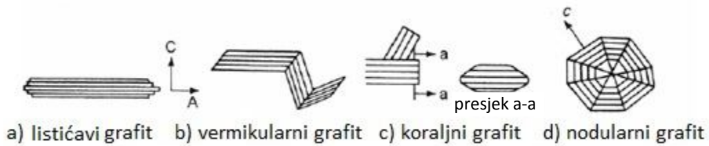
Slika 2.18 Rast različitih tipova grafita [68]
