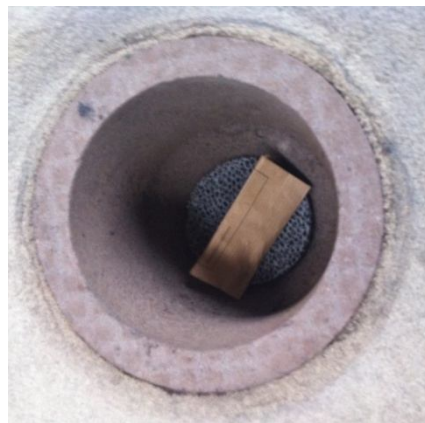
Slika 3.10 Dodavanje bizmuta na filter
