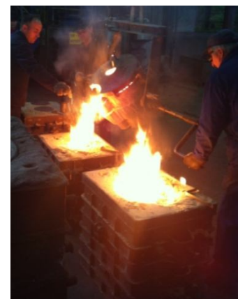
Slika 3.8 Cijepljenje u mlaz
