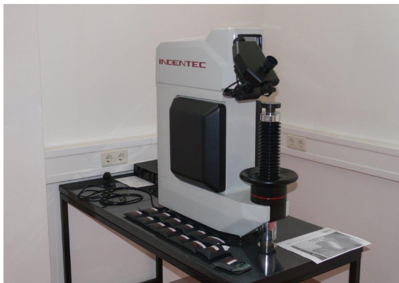
Slika 5.17 Referentni tvrdomjer Indentec 5030 TKV
