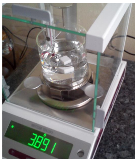
Slika 5.14 Određivanje Arhimedove gustoće [99]
