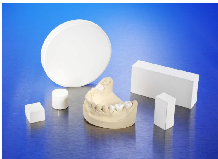
Slika 2.18 Predsinterirana ZrO_2 keramika za proizvodnju zubnih implantata [31]
