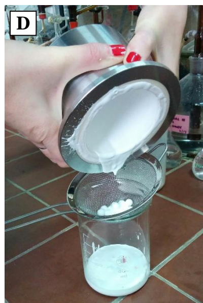
Slika 5.5 Priprava keramičkih suspenzija: (A) planetarni kuglični mlin Retsch PM 100; (B) pozicioniranje posude za miješanje u planetarnom kugličnom mlinu; (C) otvorena posuda mlina nakon provedene homogenizacije; (D) filtracija suspenzije (odvajanje keramičkih kuglica).
