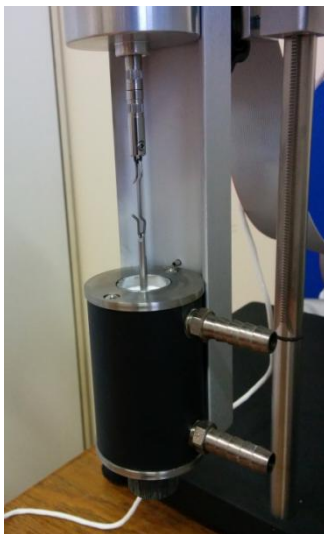
Slika 3.16 (A) Dio rotacijskog viskozimetar Brookfield DV-III Ultra – komora za male uzorke s uronjenim vretenom; (B) geometrija vretena rotacijskog viskozimetra [93]
