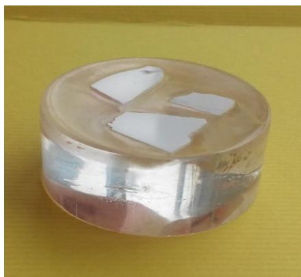
Slika 5.15 Zaliveni uzorci za keramografsku pripremu
