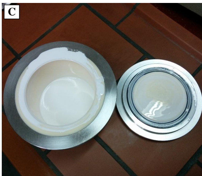
Slika 5.5 Priprava keramičkih suspenzija: (A) planetarni kuglični mlin Retsch PM 100; (B) pozicioniranje posude za miješanje u planetarnom kugličnom mlinu; (C) otvorena posuda mlina nakon provedene homogenizacije; (D) filtracija suspenzije (odvajanje keramičkih kuglica).
