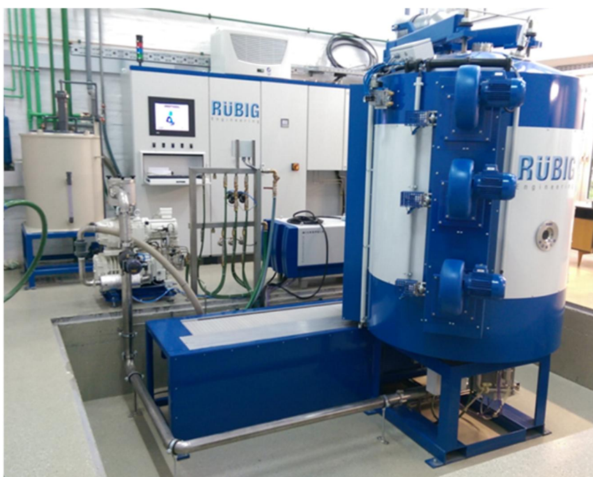
Slika 40. Uređaj MICROPULS PACVD PC 70/90 (Rübige GmbH&Co KG)
