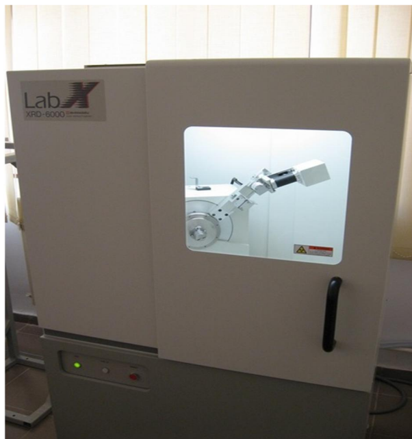
Slika 52. Difraktometar Shimadzu XRD-6000
