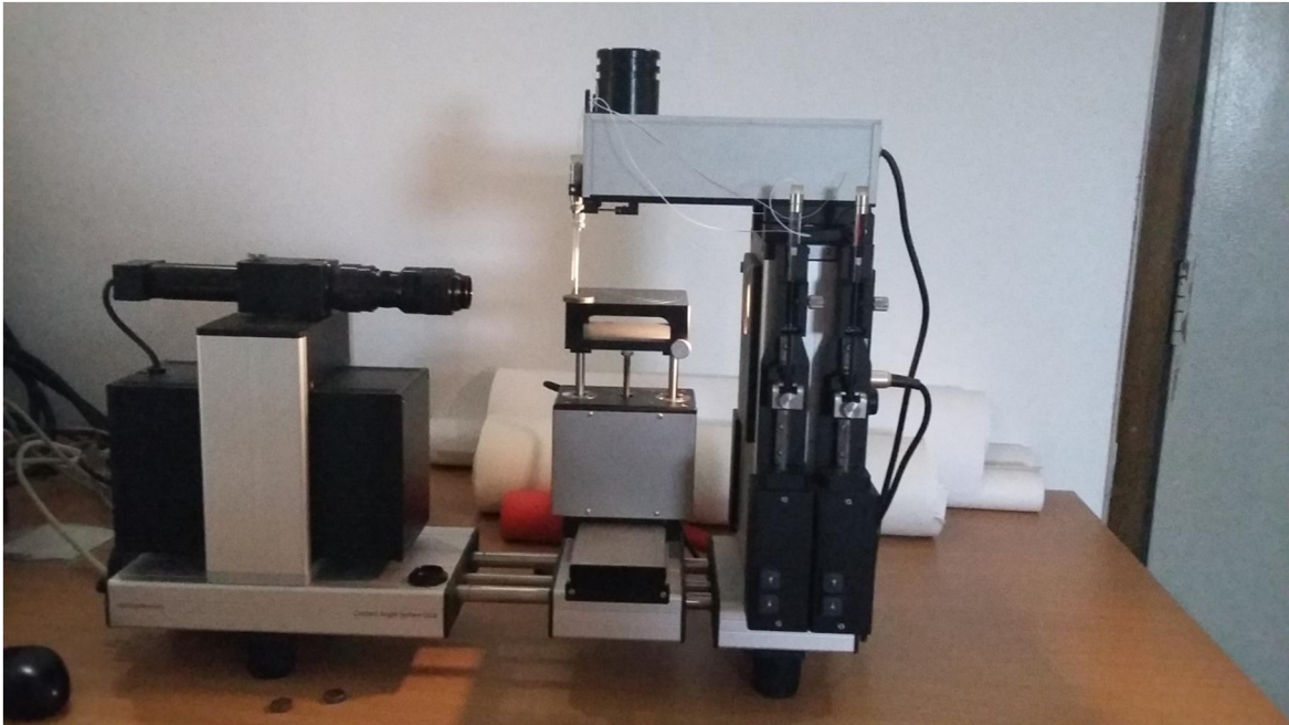
Slika 78. Uredaj za ispitivanje kuta kvašenja Dataphysics OCA30
