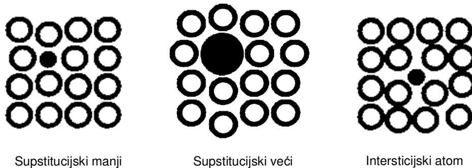
Slika 10: Shematski prikaz supstitucijskih i intersticijskih stranih atoma u kristalnoj rešetci.
