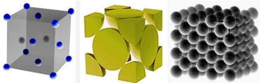
Slika 15: Prostorno plošna kristalna rešetka – FCC.
