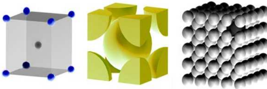
Slika 16: Prostorno centrirana kristalna rešetka – BCC.
