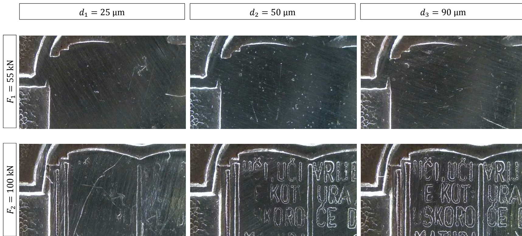
Slika 120: Detalji knjige na otkivcima različite veličine kristalnih zrna kod sila kovanja 55 kN i 100 kN.
