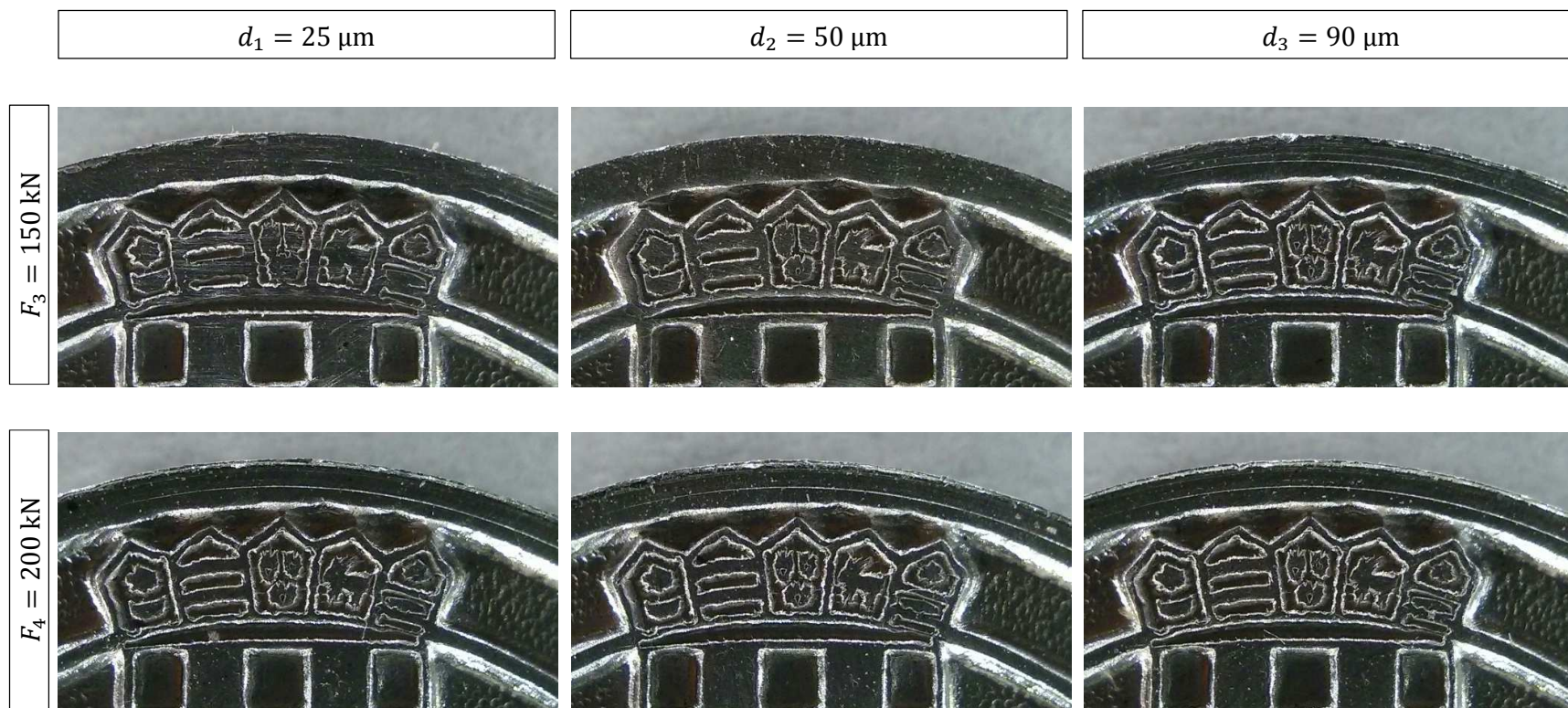
Slika 119: Detalji grba na otkivcima različite veličine kristalnih zrna kod sila kovanja 150 kN i 200 kN.
