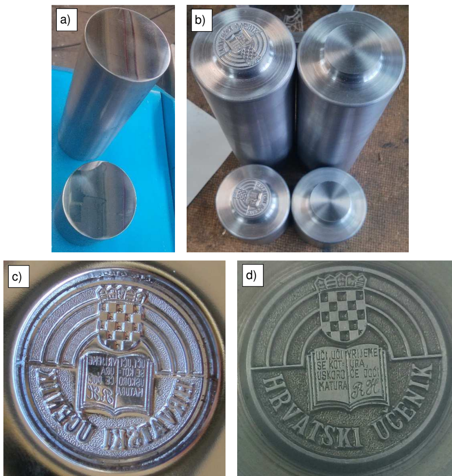
Slika 56: Prikaz žiga alata a) prije i b) nakon, utiskivanja. c) utisnuta geometrija. d) master žig.
