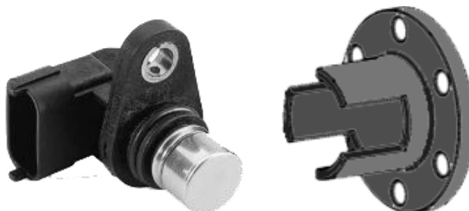
Slika 2.12. Hallov senzor (lijevo) i asimetričan prsten na bregastom vratilu (desno)
