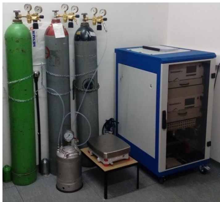
Slika 2.44. Analizator ispušnih plinova i pripadajuće boce s radnim i kalibracijskim plinovima
