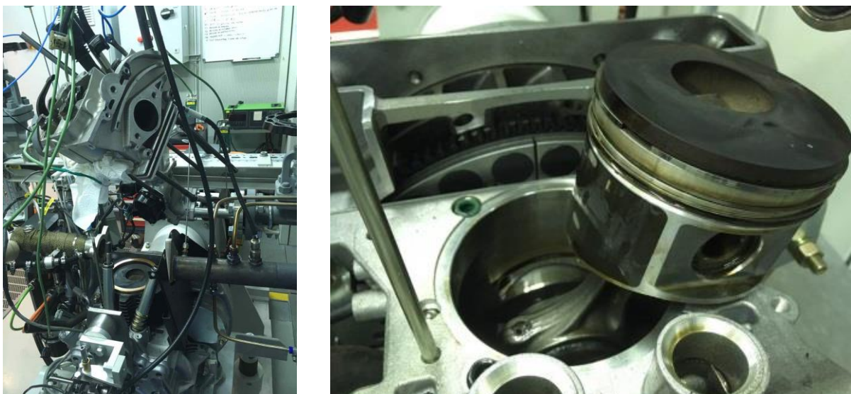
Slika 2.9. Karakteristične faze u postupku izmjene kompresijskog omjera
