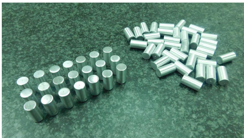
Slika 5.1 Uzorci iz aluminija korišteni za eksperimentalna bušenja
