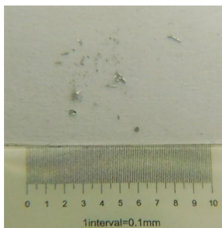
Slika 6.2 Primjer veličine odvojenih čestica kod bušenja potpomognutoga vibracijama
