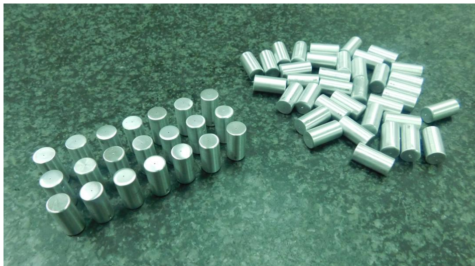
Slika 5.1 Uzorci iz aluminija korišteni za eksperimentalna bušenja
