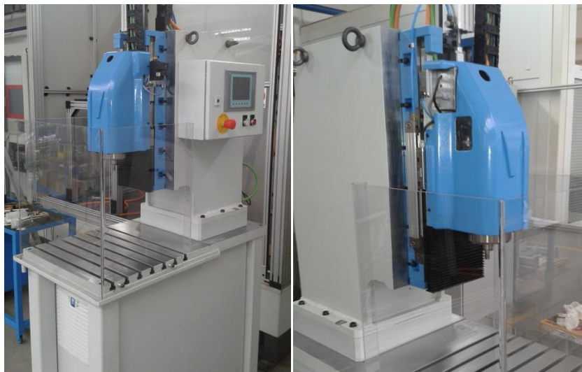
Slika 4.2 Stroj za mikrobušenje
