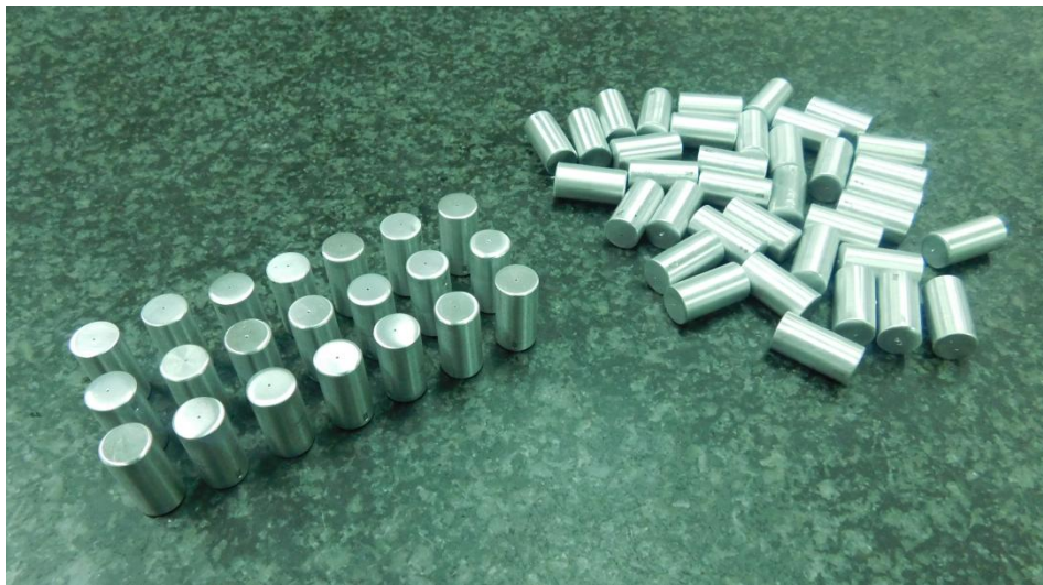
Slika 5.1 Uzorci iz aluminija korišteni za eksperimentalna bušenja
