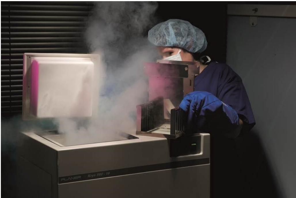
Slika 35. Uređaj za kontrolirano zamrzavanje Planer PLC, UK
