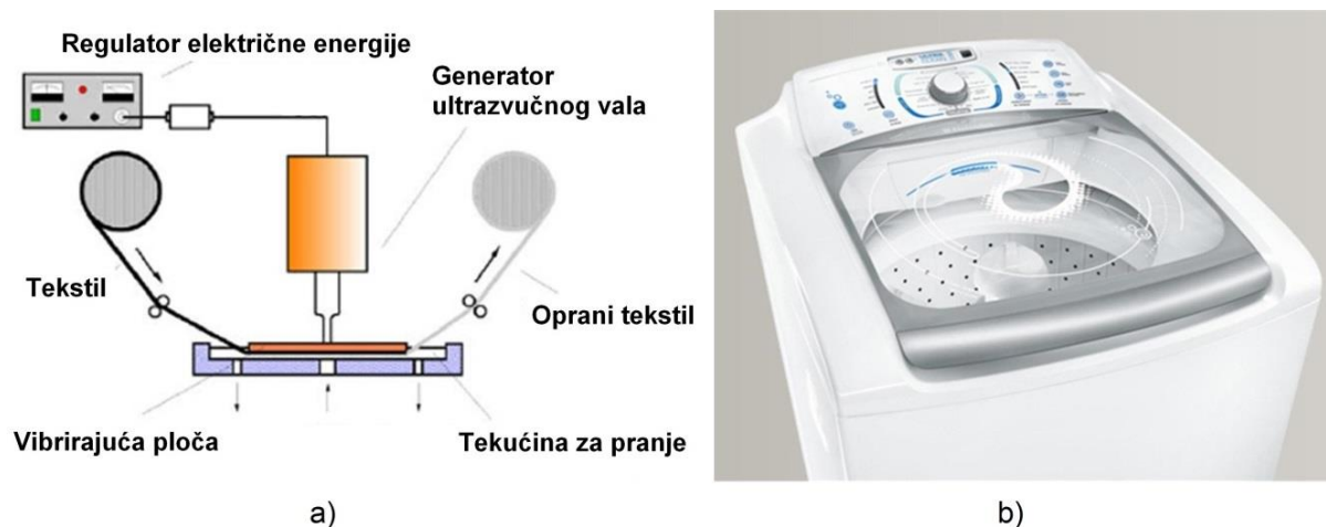
Slika 3.3. a) Sustav za ultrazvučno pranje tekstila [285]; b) Electrolux Ultra Clean perilica rublja s olovkom za uklanjanje manjih mrlja ultrazvukom [286]
