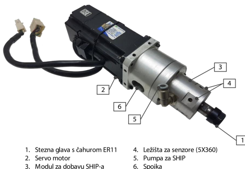
Slika 3.5 Modul glavnog prigona ispitnog stroja
