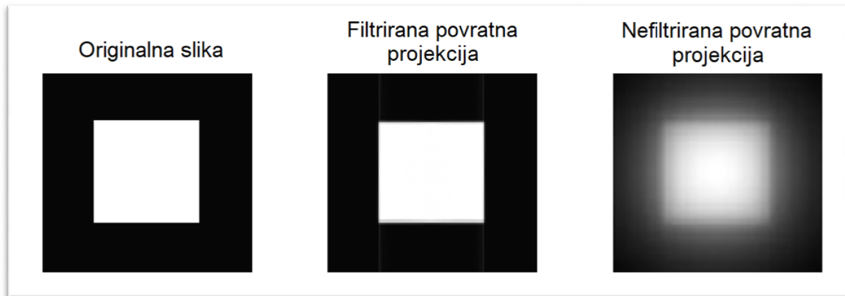
Slika 2-16. Inverzna Radonova transformacija [5].
