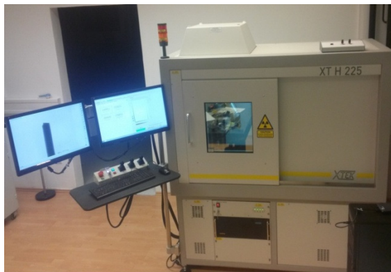
Slika 2-4. Industrijski CT skener Nikon XT H 225.
