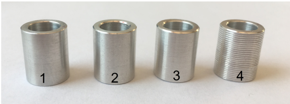
Slika 4-24. Prikaz četiri aluminijska cilindra različite površinske hrapavosti.
