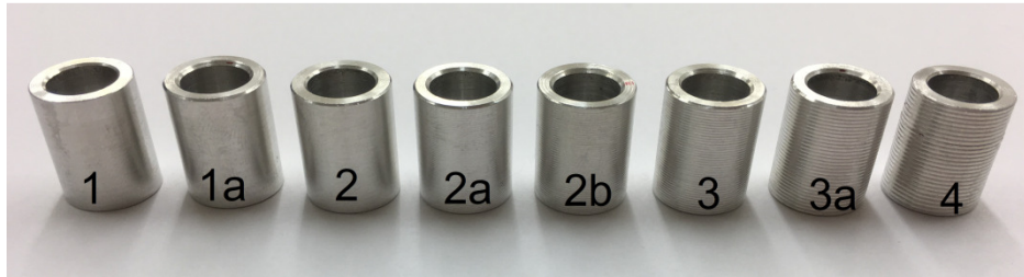
Slika 4-27. Osam aluminijskih cilindara različitih površinskih hrapavosti.
