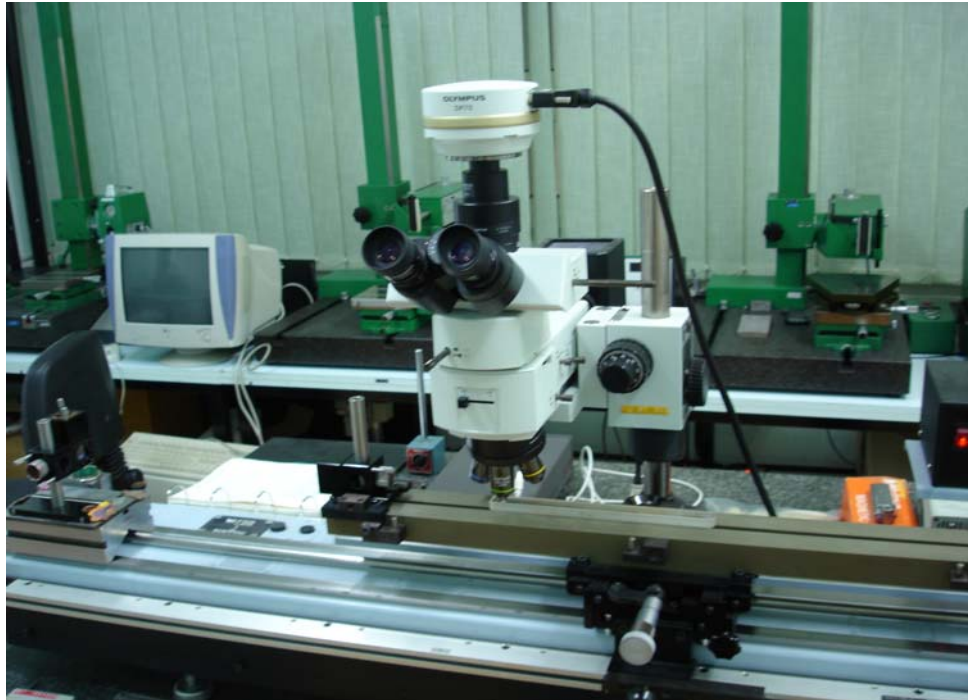
Slika 36. Uređaj za umjeravanje preciznih mjernih skala [7]
