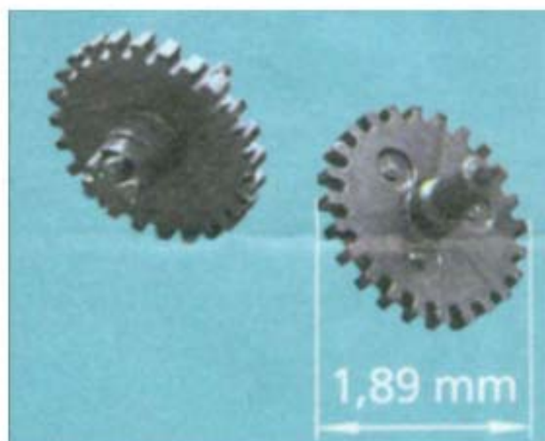
Slika 5. Prikaz mikrozapčanika promjera 1,89 mm i mase 0,0008 g [4]
