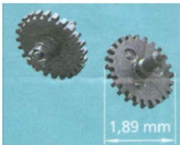
Slika 5. Prikaz mikrozupčanika promjera 1,89 mm i mase 0,0008 g [4]
