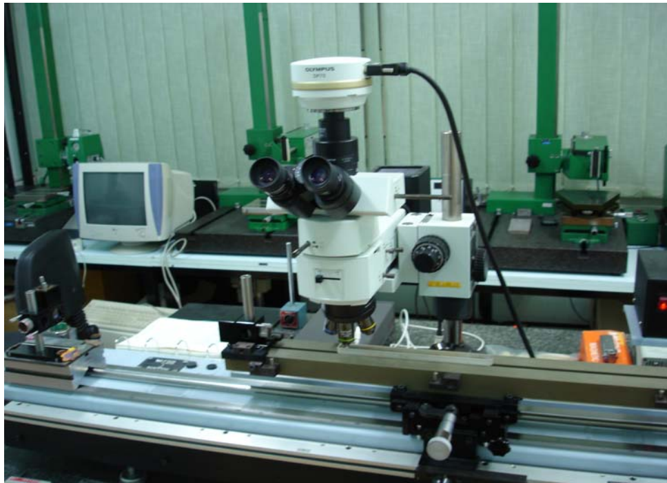
Slika 36. Uređaj za umjeravanje preciznih mjernih skala [7]
