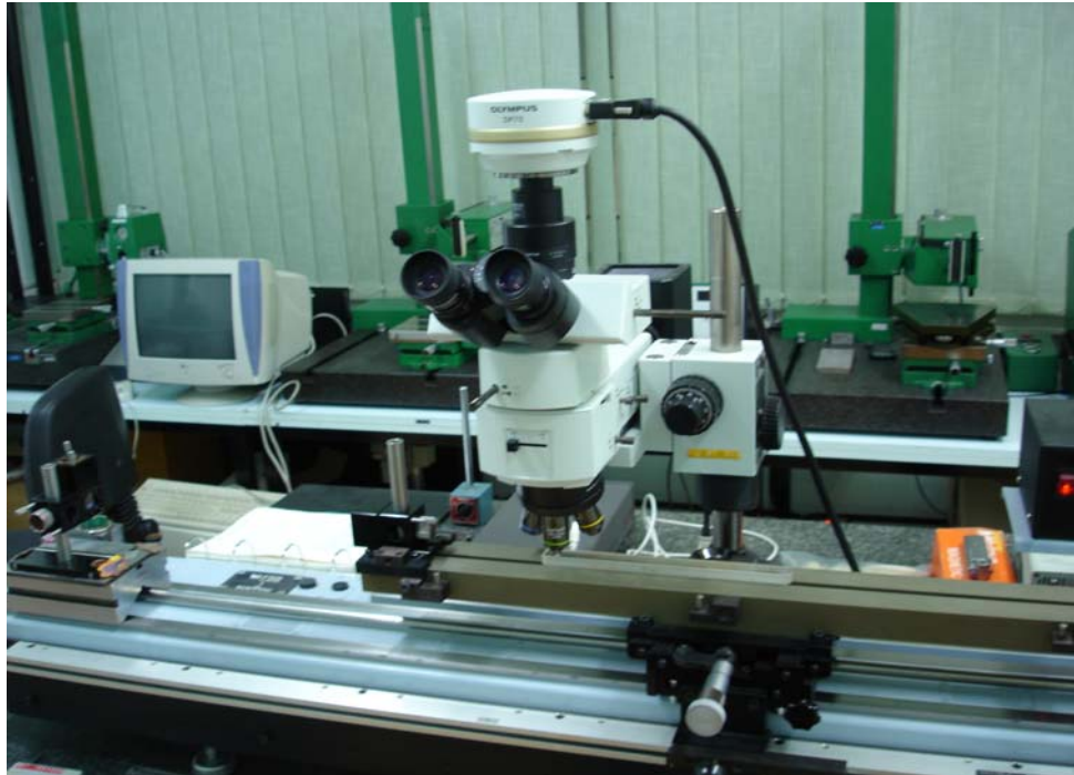
Slika 36. Uređaj za umjeravanje preciznih mjernih skala [7]
