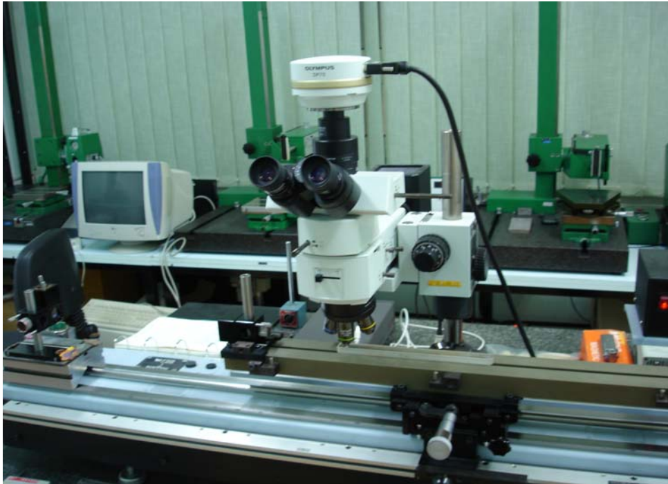
Slika 36. Uređaj za umjeravanje preciznih mjernih skala [7]
