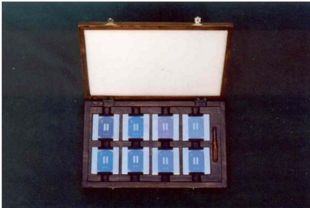
Slika 41. Set referentnih etalona hrapavosti LFSB-a [3]
