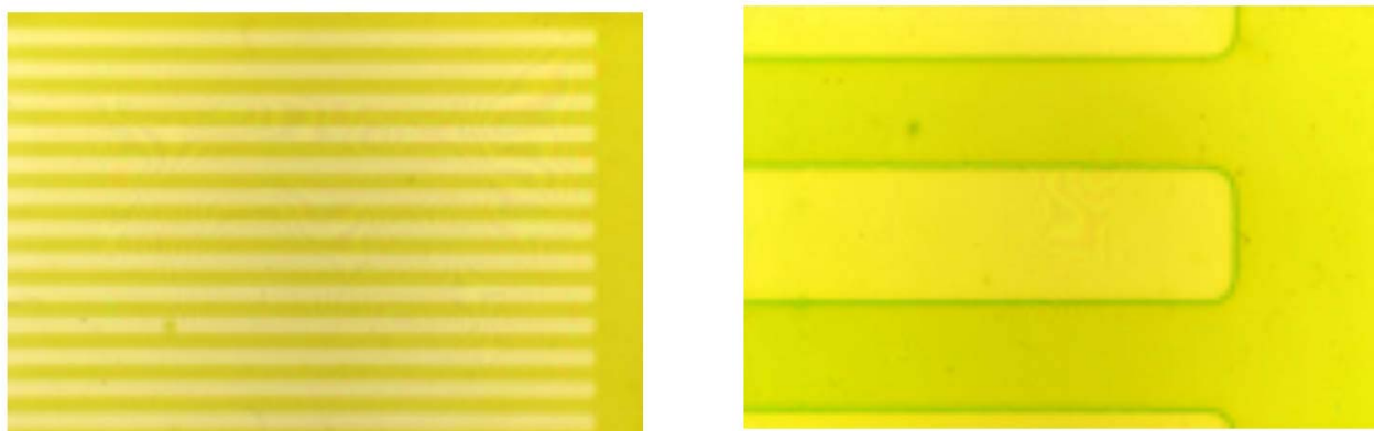
Slika 42. Uvećana slika brazdi referentnih etalona hrapavosti LFSB-a [3]
