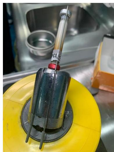
Slika 4. Kromatografska kolona  $^{99}\text{Mo}/^{99\text{m}}\text{Tc}$  generatora radionuklida
