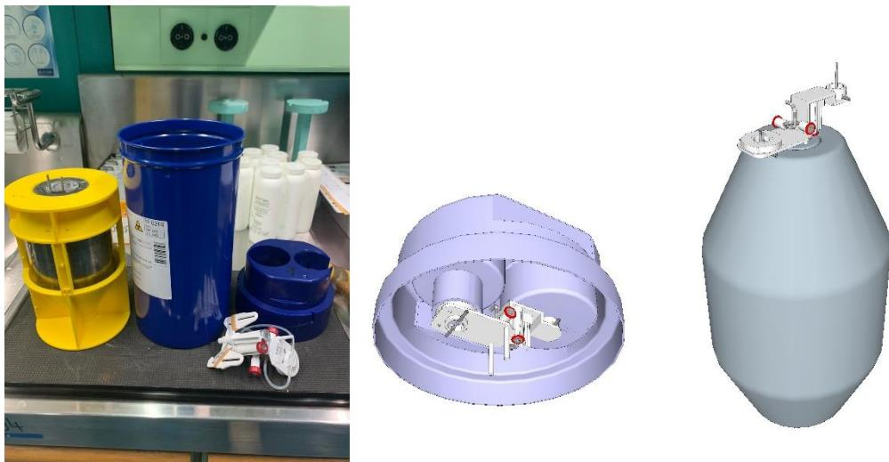
**Slika 9. Postupak rastavljanja iskorištenog  $^{99}\text{Mo}/^{99\text{m}}\text{Tc}$  generatora**
