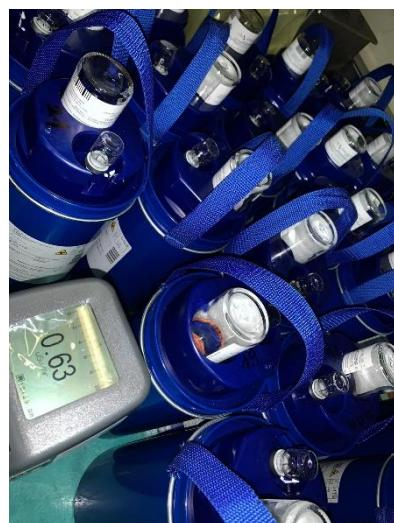
**Slika 8.**Iskorišteni  $^{99}\text{Mo}/^{99\text{m}}\text{Tc}$  generatori radionuklida
