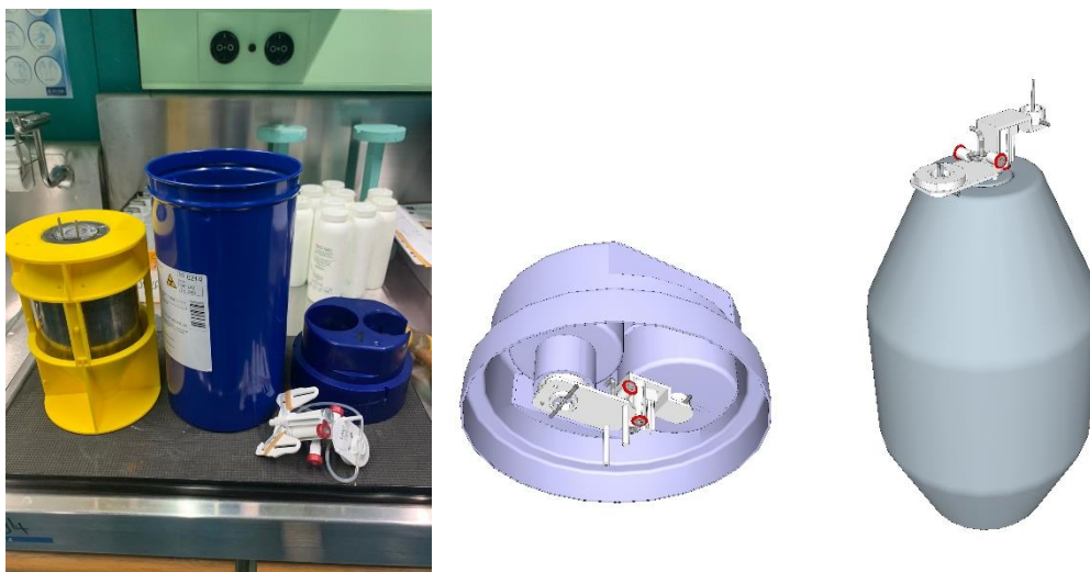
Slika 9. Postupak rastavljanja iskorištenog ^{99}\text{Mo}/^{99\text{m}}\text{Tc} generatora
