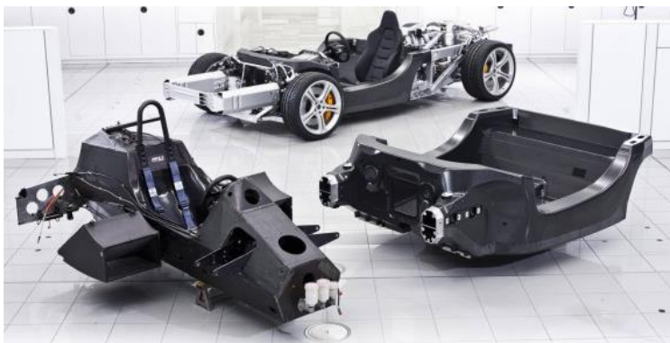
Slika 2. McLarenovi okviri od kompozita s ugljičnim vlaknima [2]
