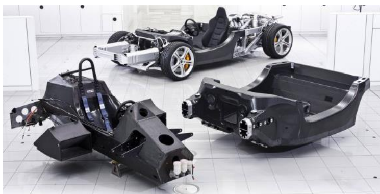
Slika 2. McLarenovi okviri od kompozita s ugljičnim vlaknima [2]
