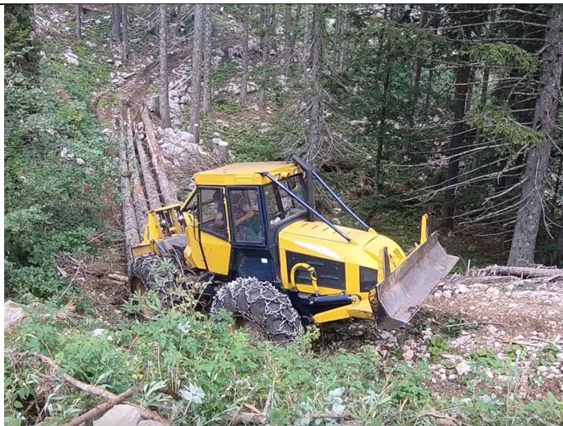
Slika 15. Mjesto na kojem vozilo sa teretom proklizuje [15]
