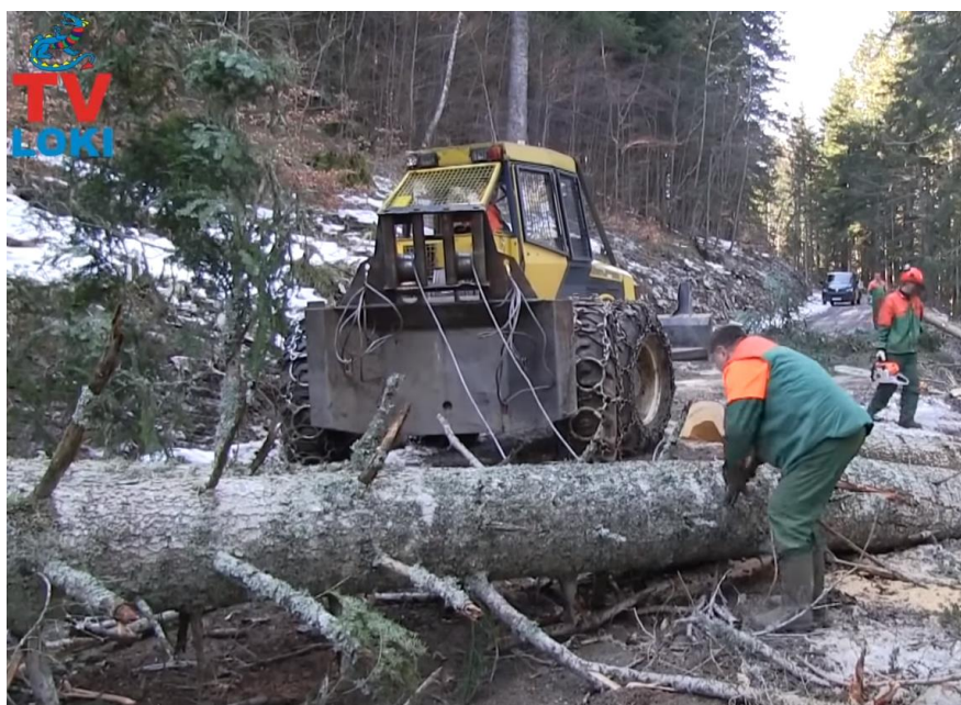
Slika 14. Povezivanje trupaca sa sajlama [14]
