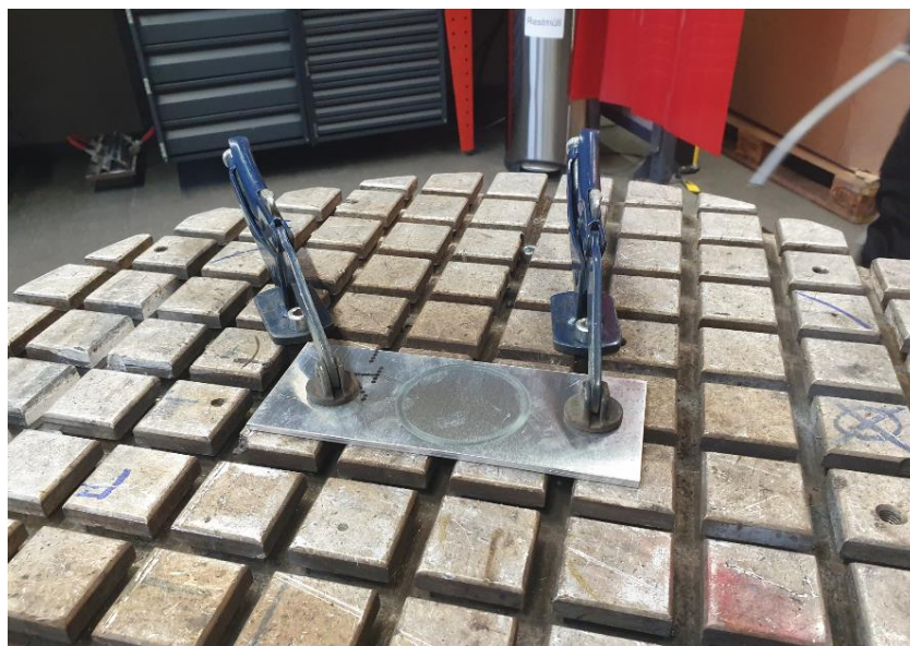
Slika 62. Podloga za izradu učvršćena stegama
