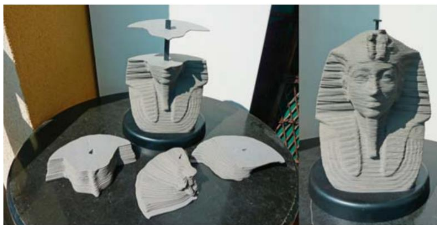
Slika 1. Princip aditivne proizvodnje [2]
