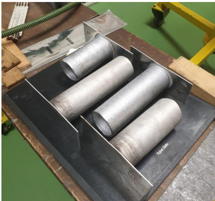
Slika 73. Uzorci spremni za snimanje – vodoravni položaj
