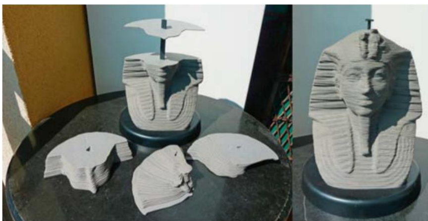
Slika 1. Princip aditivne proizvodnje [2]
