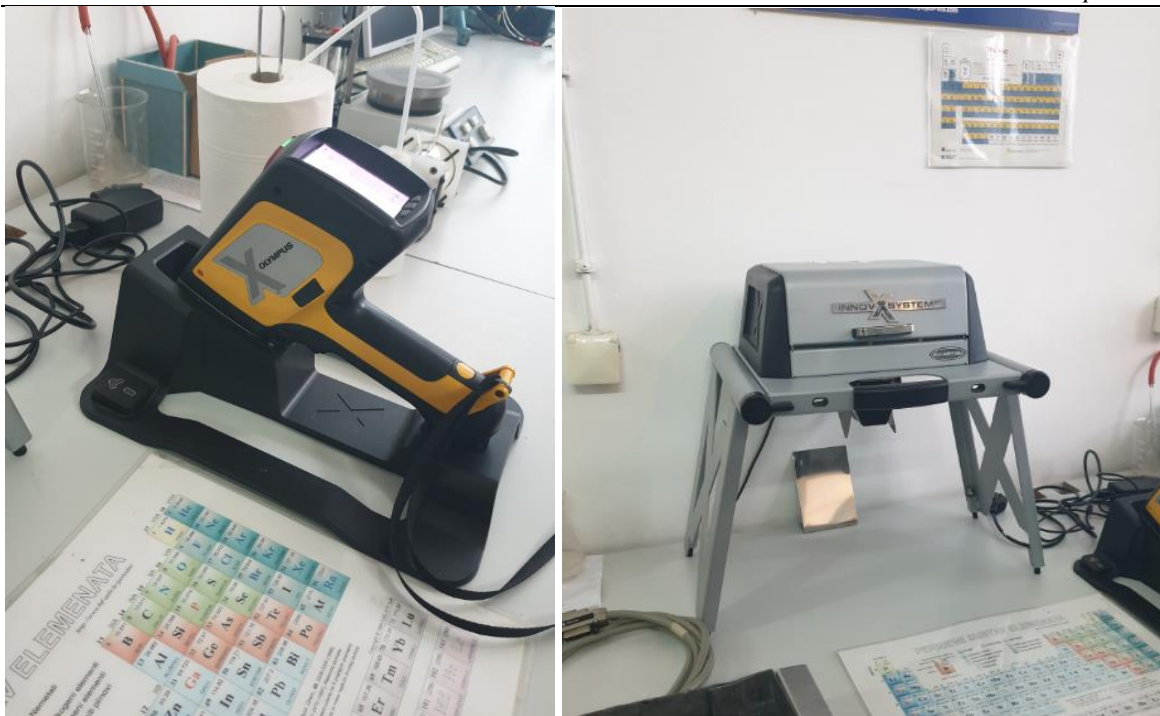
Slika 70. Olympus XRF uređaj za snimanje kemijskog sastava
