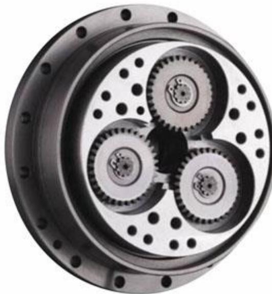
Slika 66. Planetarni prijenos<sup>[15]</sup>
