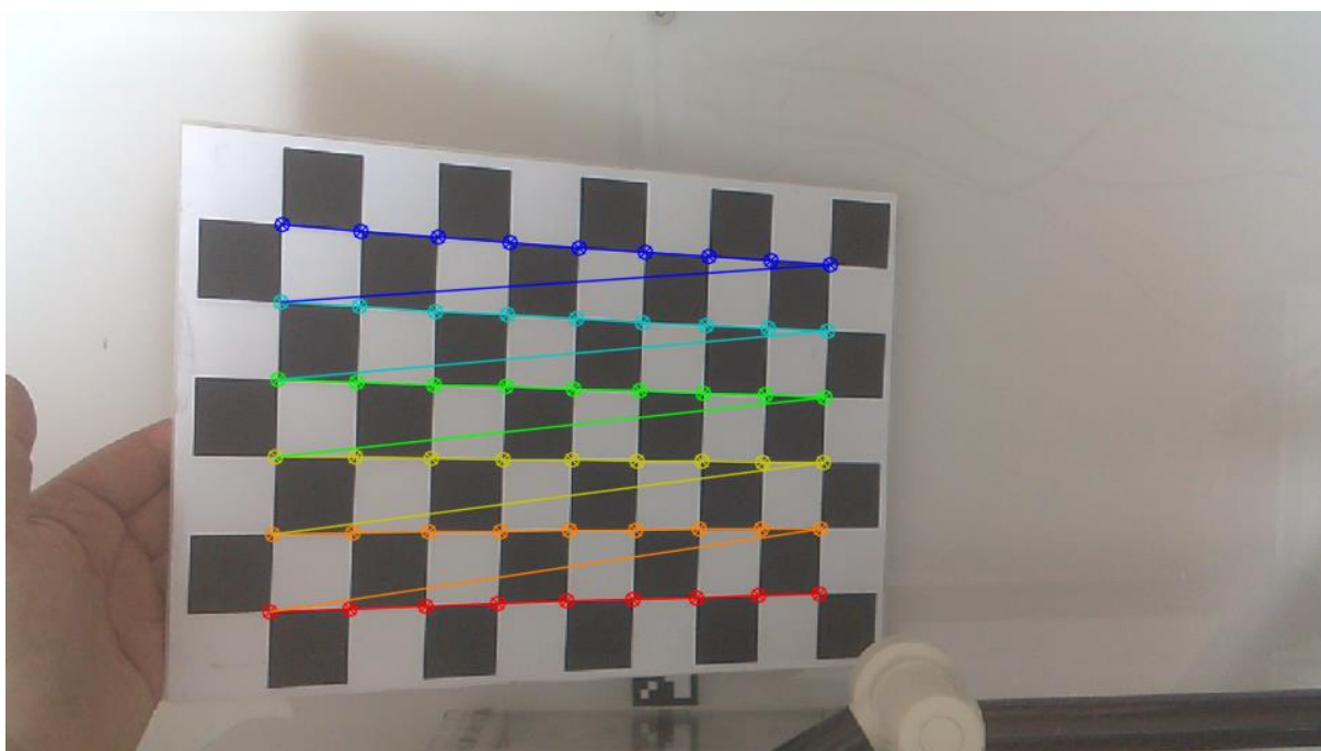
Slika 132. Kalibracija kamere, pronalazak točaka
