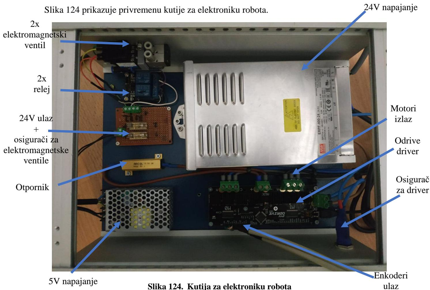
Slika 124. Kutija za elektroniku robota
