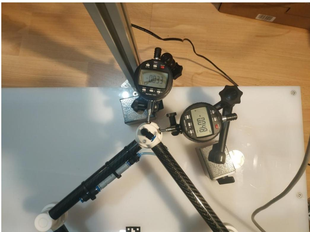
Slika 151. Mjerenje ponovljivosti, pozicija 1, robot primaknut
