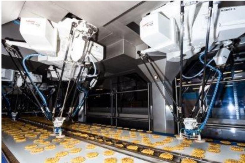
**Slika 3. Delta robot, operacija izuzmi-odloži<sup>[4]</sup>**
