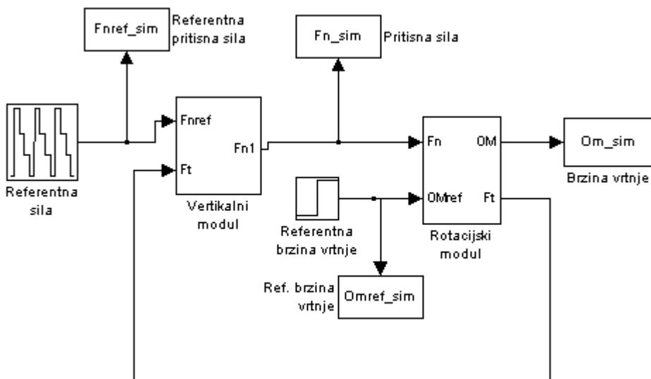
Slika 4.5.1 Model za ispitivaje trenja na rotirajućem modulu
