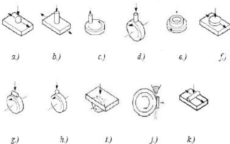
Slika 2.2.1 Osnovne metode ispitivanja trenja i trošenja
