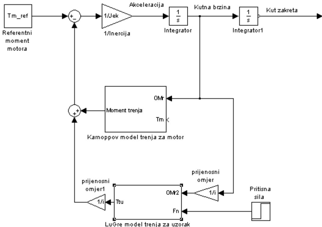
Slika 3.4.4 Simulink model modula za ostvarivanje rotirajućeg gibanja
