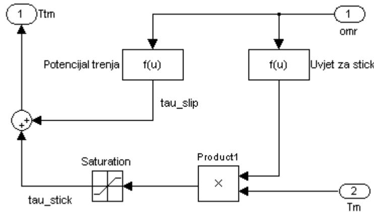
Slika 3.5.4 Karnopp-ov model trenja za motor vertikalne osi
