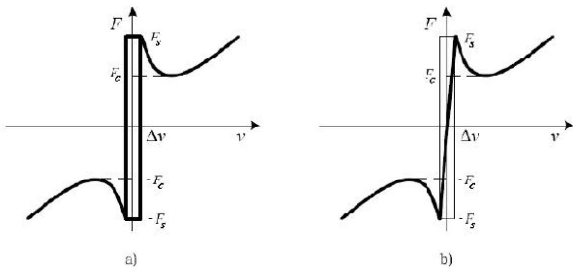
Slika 3.2.2 Karnoppov model a) klasični i b) modificirani
