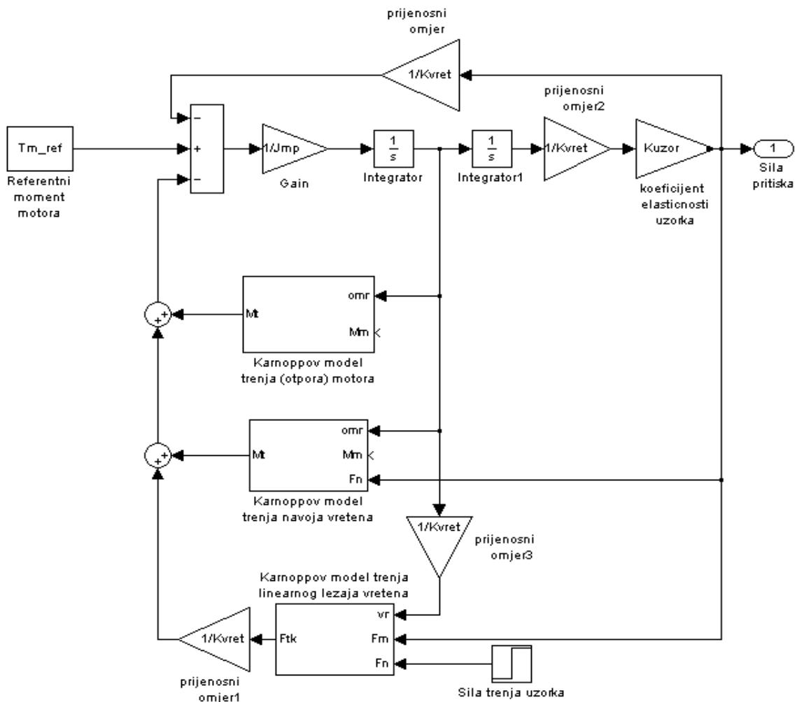
Slika 3.5.7 Matematički model dinamike za modul vertikalne osi
