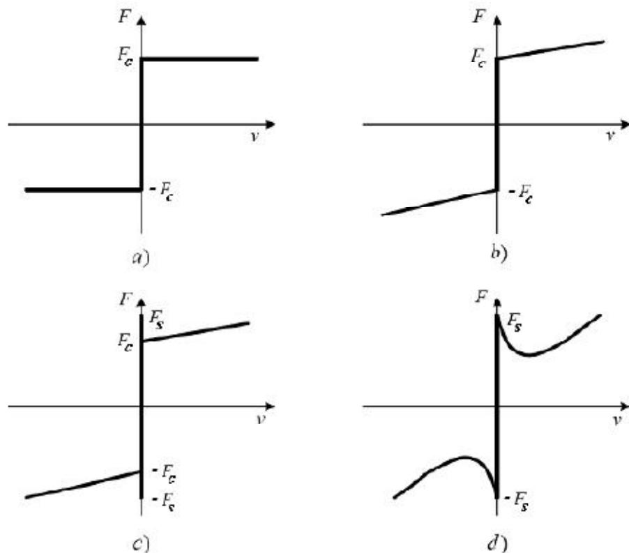
Slika 3.2.1 Klasični staticki modeli trenja: a) Coulombovo trenje, b) Coulombovo + viskozno trenje, c) Coulombovo + viskozno trenje+statičko trenje, d) Stribeckovo+viskozno trenje
