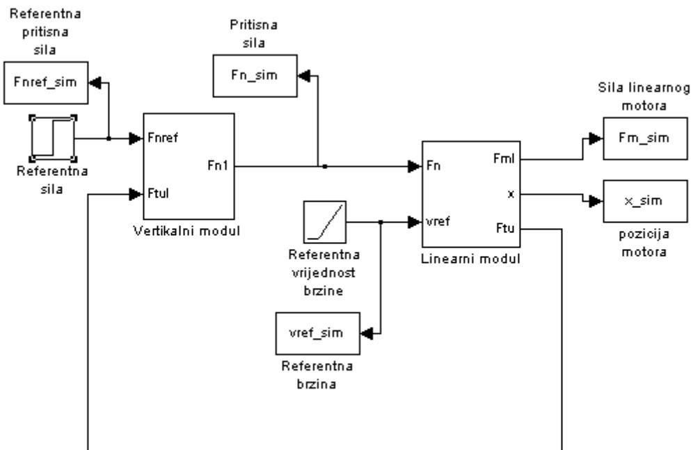
Slika 4.4.1 Model za ispitivaje trenja na linearnom modulu
