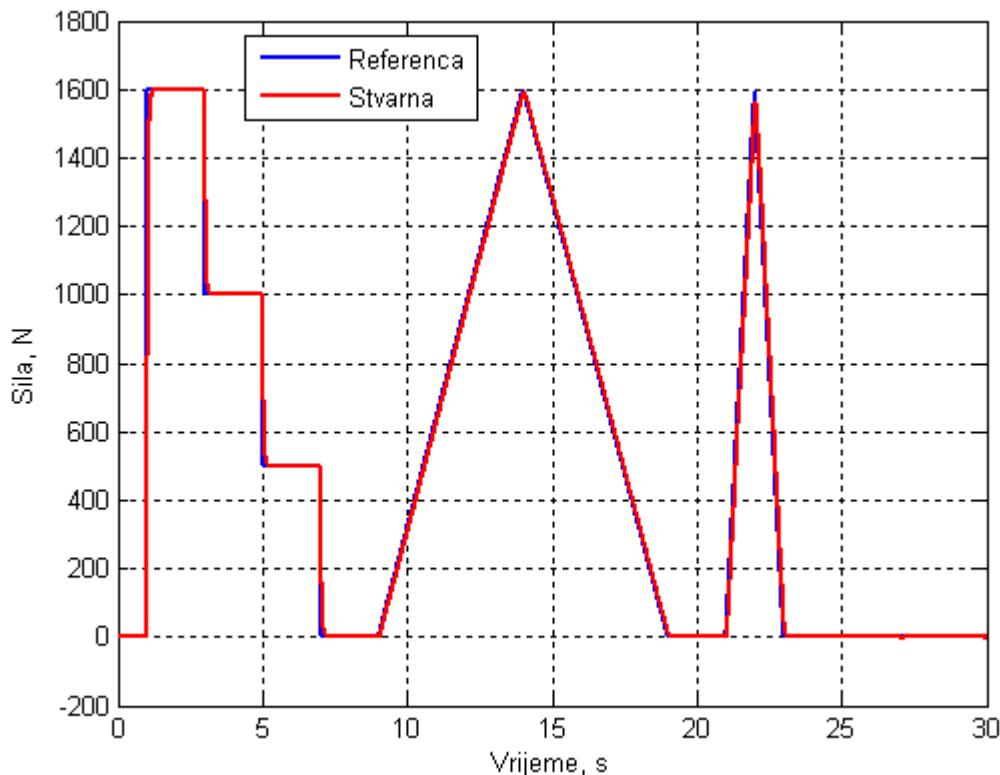
Slika 4.3.2 Simulacijski odziv regulacijskog kruga sile pritiskanja
