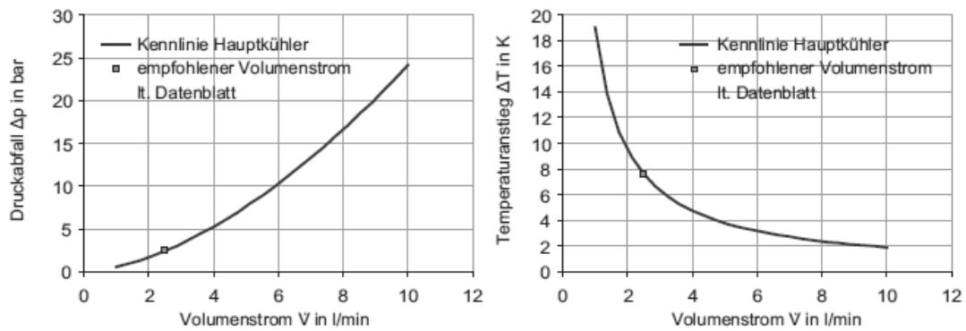
**Kennlinien Druckabfall Primärteil-Präzisionskühlung und Sekundärteilkühlung**
