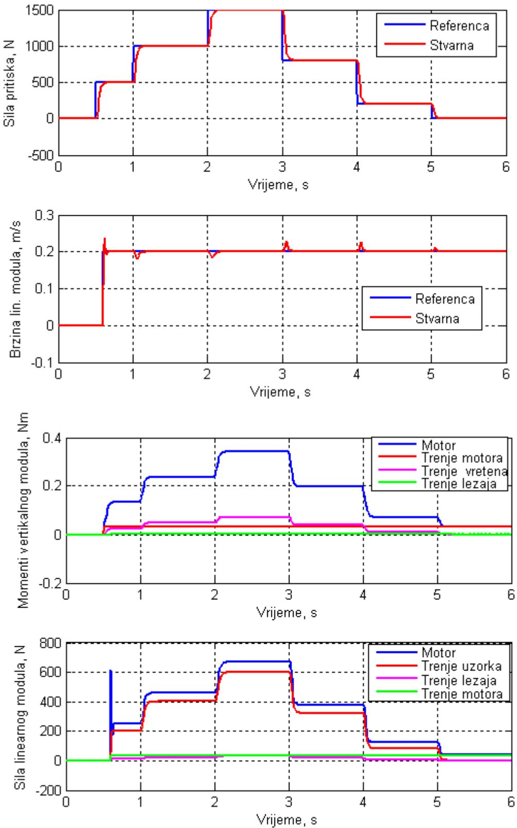
Slika 5.3.1 Rezultati simulacijskog odziva za eksperiment utjecaja promjene normalne sile uz malu konstantnu brzinu klizanja
