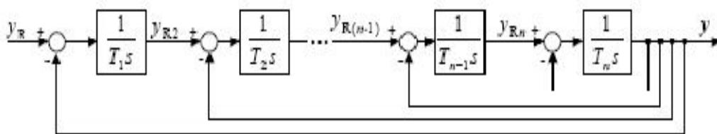
Slika 4.1 Blokovska shema kaskadne strukture linearног regulacijskog sustava.
