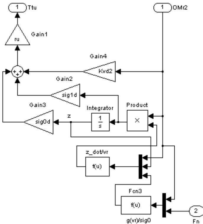
Slika 3.4.3 LuGre model trenja za uzorak rotirajućeg modula
