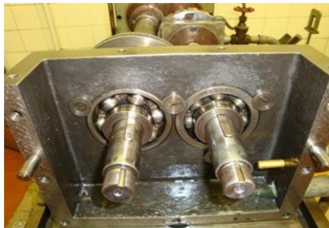
Slika 4.2.1. Osovine za montažu ispitnih zupčanika
