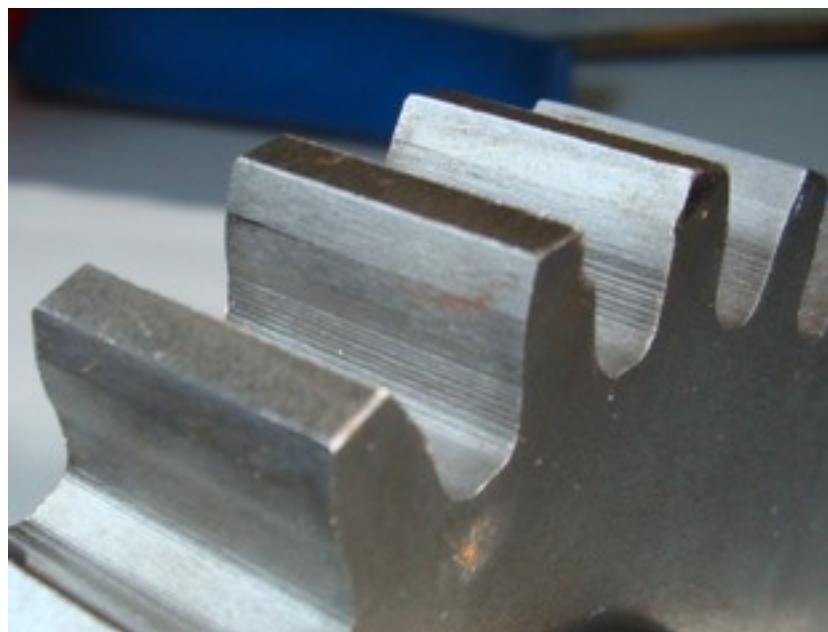
Slika 4.2.4.1 Površina zuba NL zupčanika prije ispitivanja
