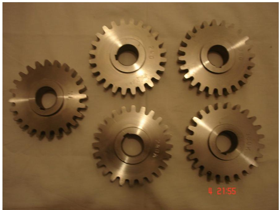
Slika 4.1.3. Izrađeni zupčanici spremni za toplinsku obradu i kugličarenje
