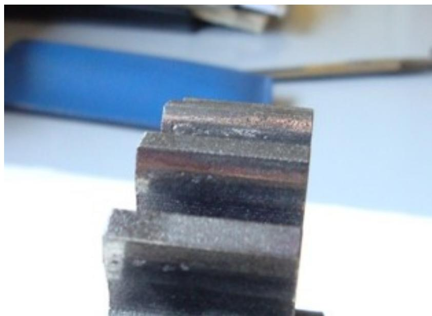
Slika 4.2.5.0. Površina zuba NL240K zupčanika nakon ispitivanja
