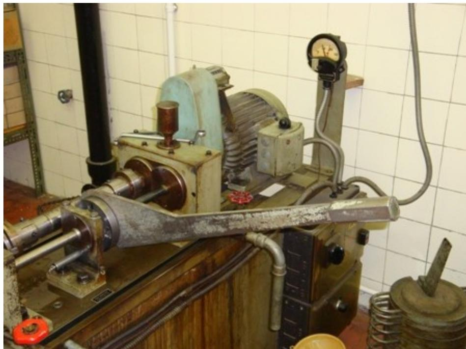
Slika 3.2. Spojka s polugom za nanošenje opterećenja
