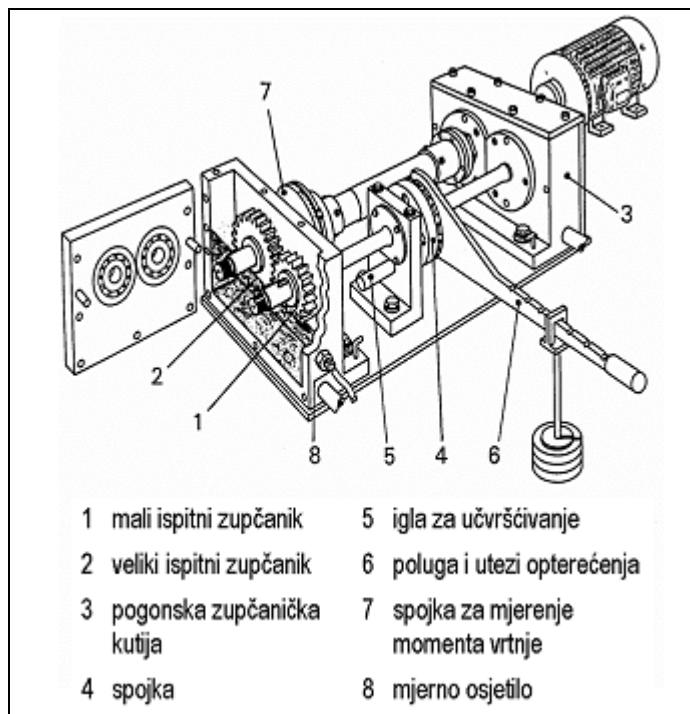
Slika 3.1. 3D prikaz FZG uređaja s dijelovima
