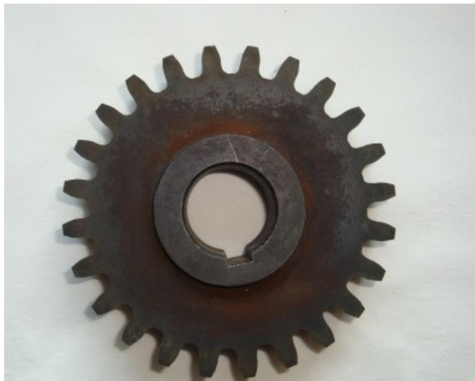
Slika 4.1.1.3. Izgled zupčanika nakon toplinske obrade
