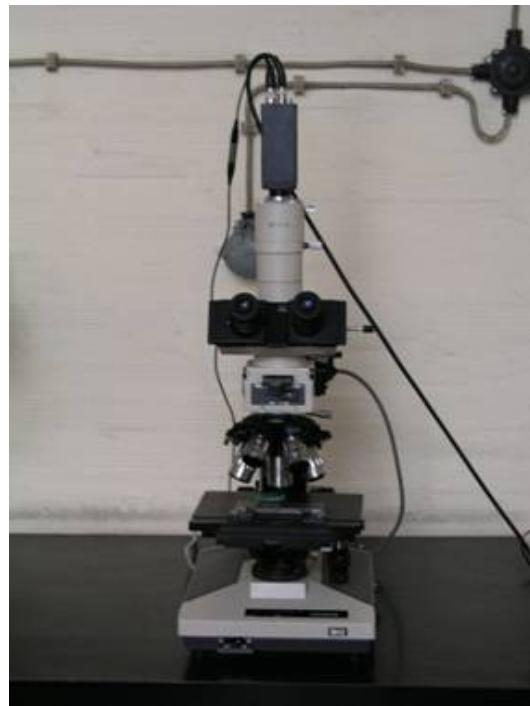
Slika 4.4.2.1. Olympus svjetlosni mikroskop sa CCD kamerom
