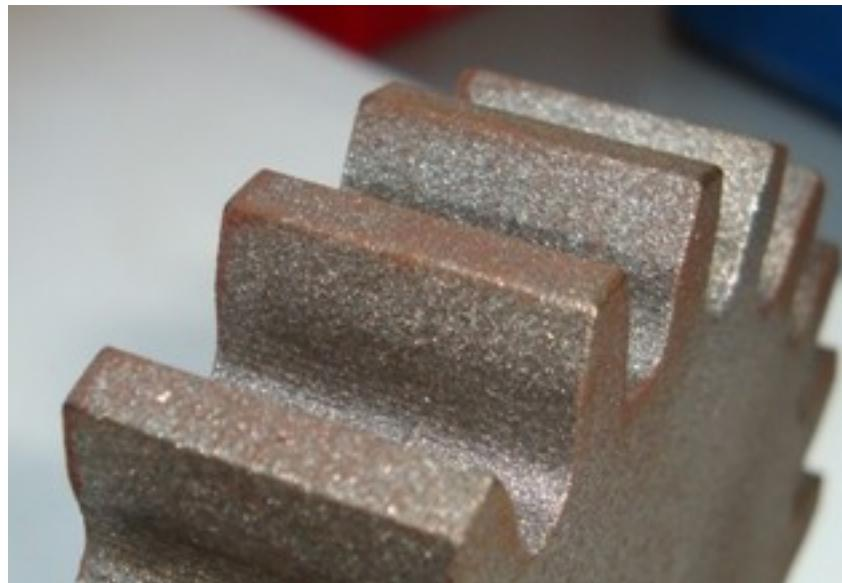
Slika 4.2.4.7. Površina zuba NL 380K zupčanika prije ispitivanja
