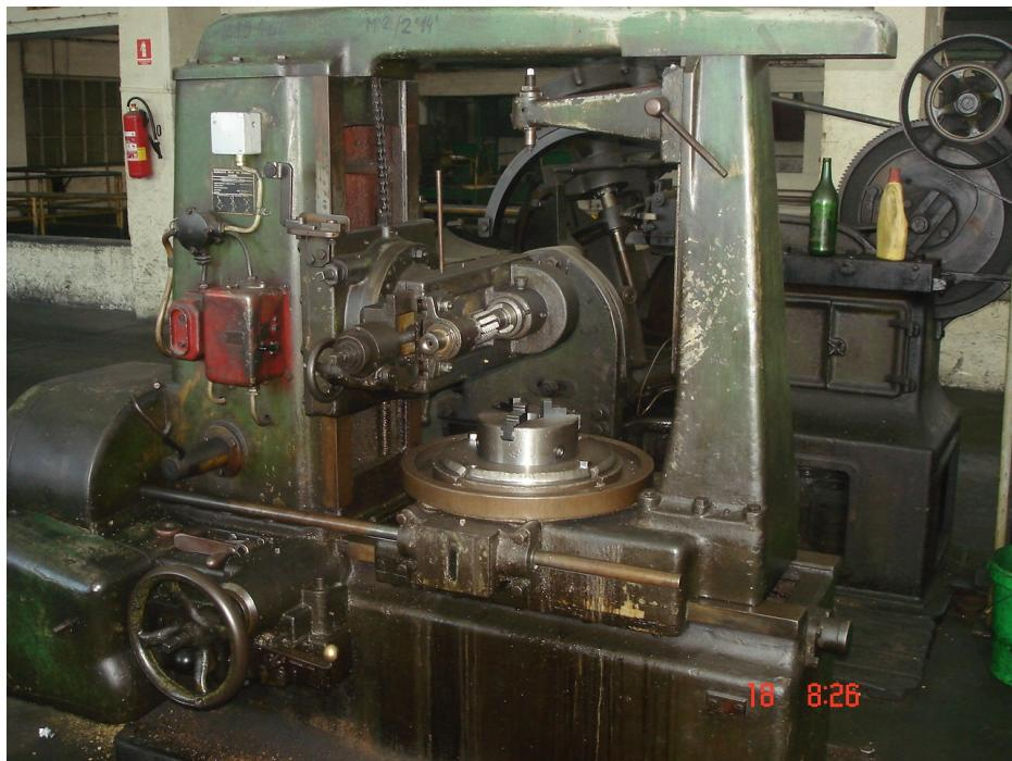
Slika 4.1.2. Glodalica za izradu zupčanika
