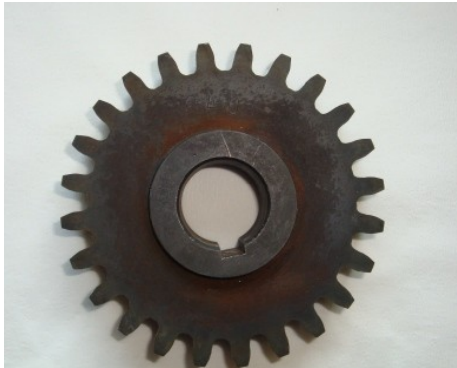
Slika 4.1.1.3. Izgled zupčanika nakon toplinske obrade
