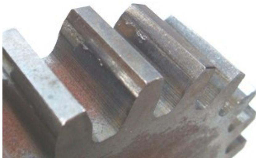
Slika 4.2.4.6 Površina zuba NL 240 zupčanika nakon ispitivanja
