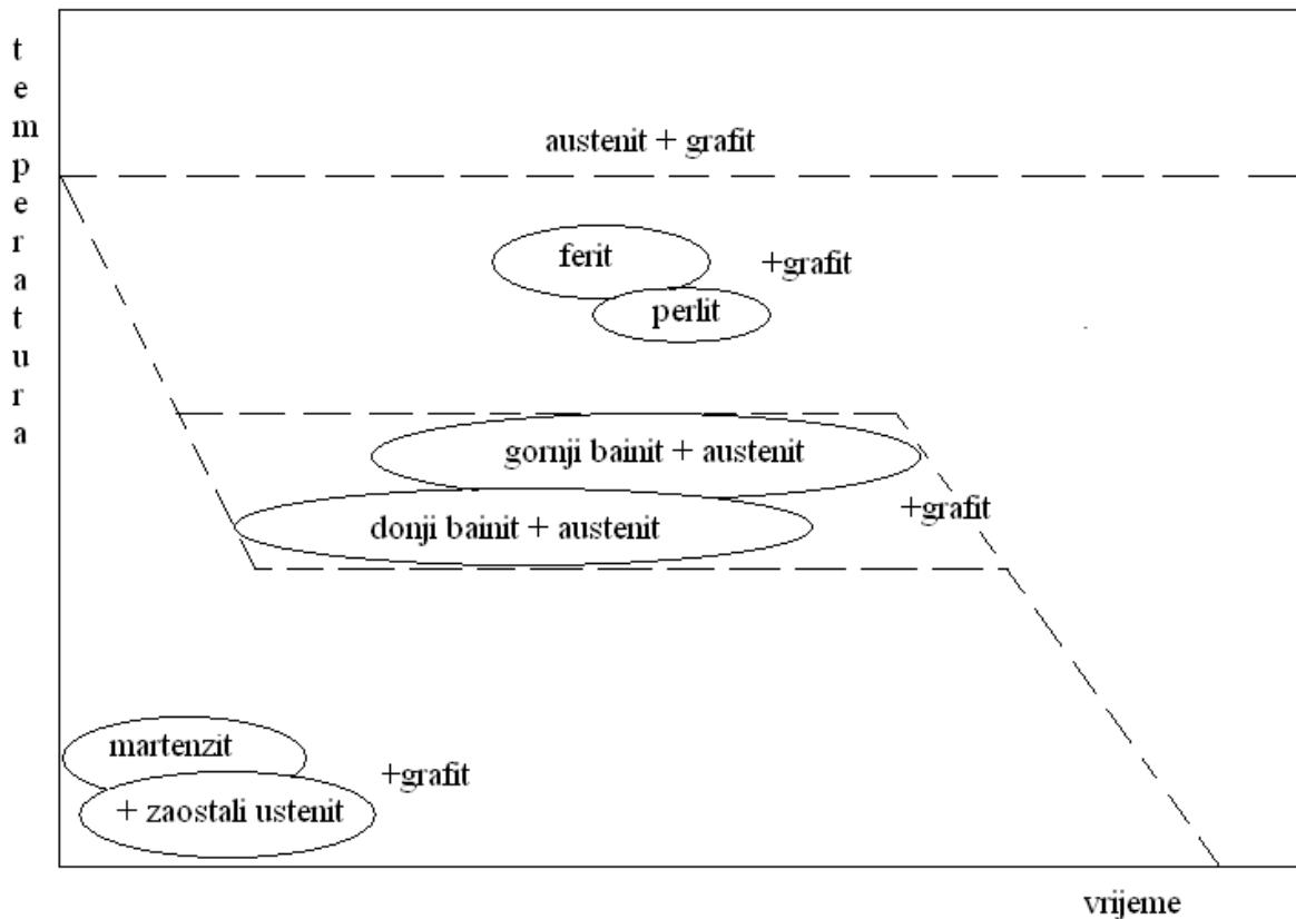
Slika 2.2. Shematski prikaz općenitog TTT- dijagrama nodularnoga lijeva [3]
