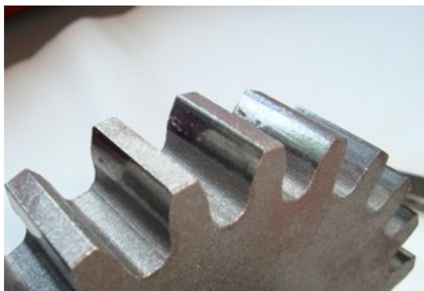
Slika 4.2.4.8. Površina zuba NL 380K zupčanika nakon ispitivanja
