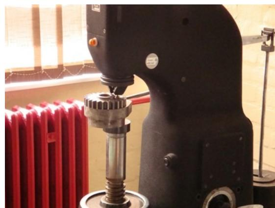
Slika 4.3.1.2. Uređaj za ispitivanje tvrdoće po Brinellu
