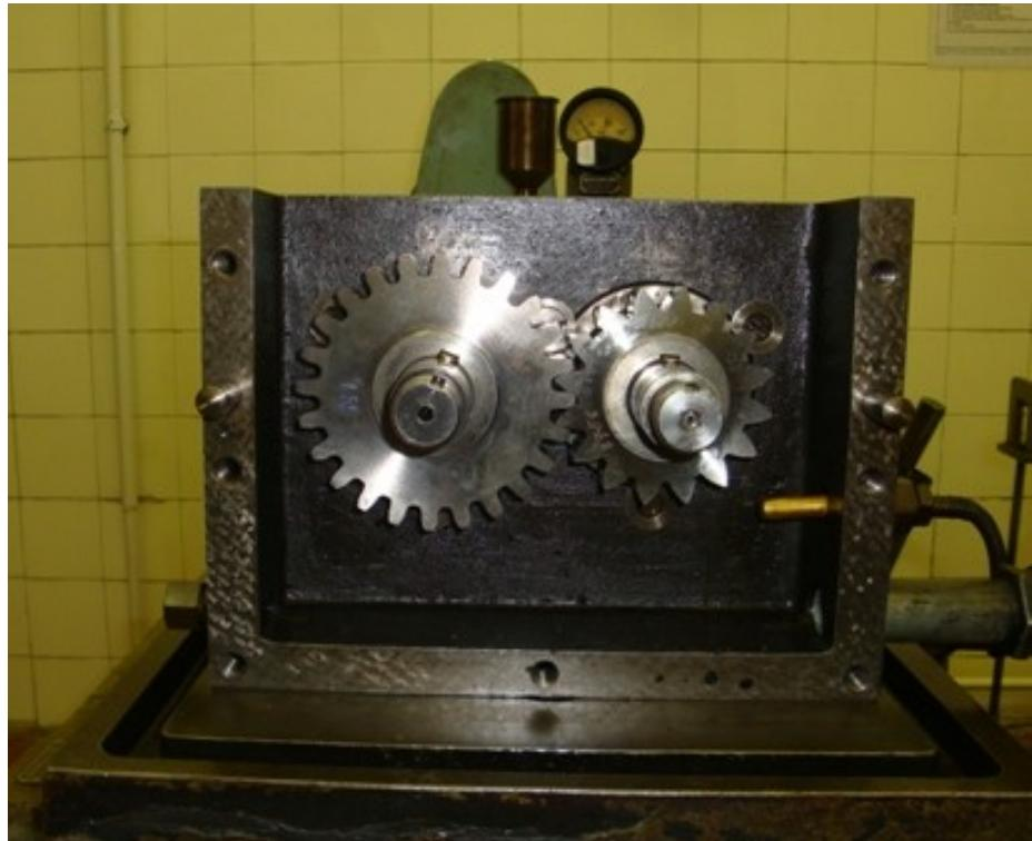
Slika 3.6. Montirani zupčanici na osovine
