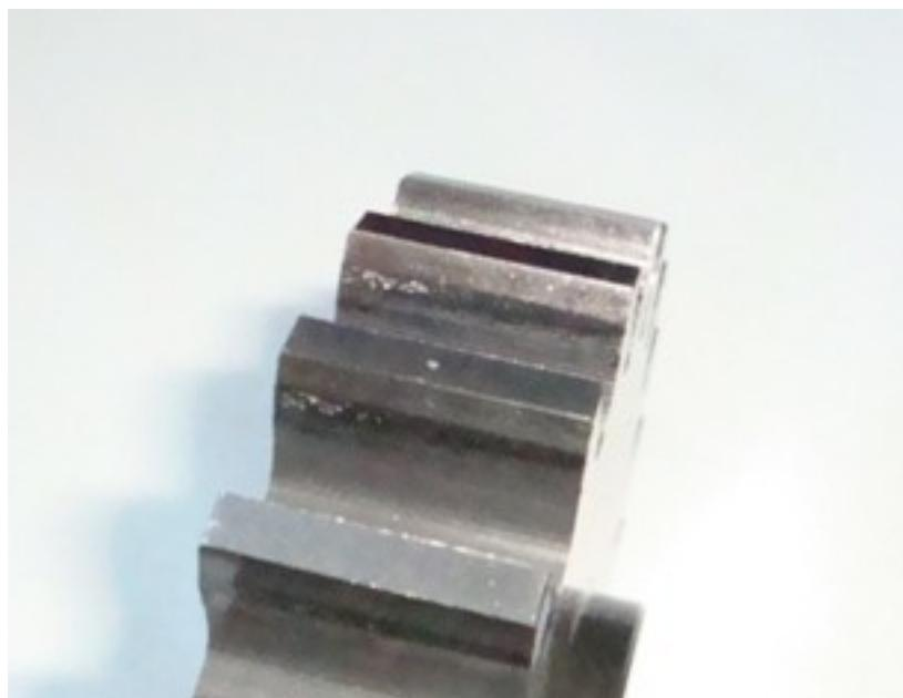
Slika 4.2.4.2. Površina zuba NL zupčanika nakon ispitivanja
