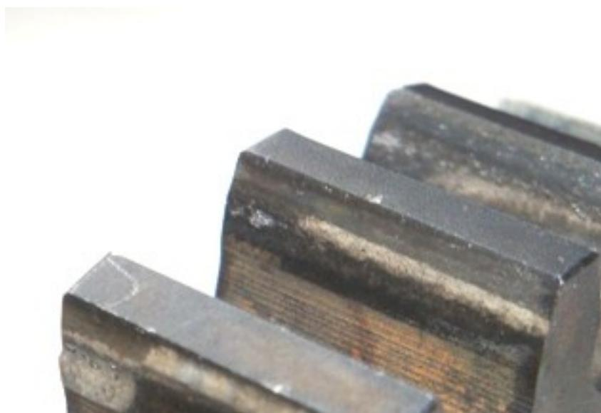
Slika 4.2.4.4. Površina zuba NL 380 zupčanika nakon ispitivanja
