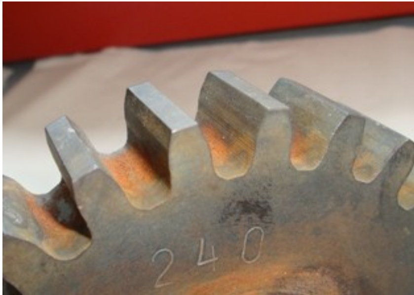
Slika 4.2.4.5 Površina zuba NL 240 zupčanika prije ispitivanja
