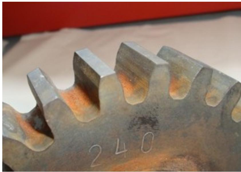
Slika 4.2.4.5 Površina zuba NL 240 zupčanika prije ispitivanja
