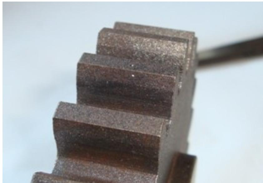
Slika 4.2.4.9 Površina zuba NL240K zupčanika prije ispitivanja
