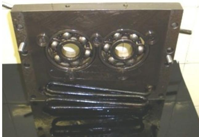
Slika 4.2.2. Električni grijač za postizanje startne temperature ulja
