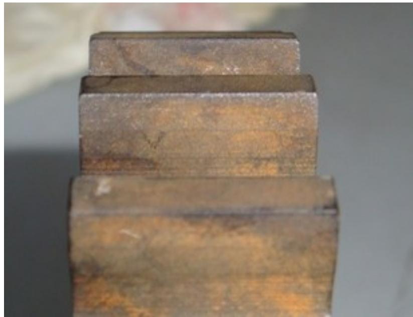
Slika 4.2.4.3. Površina zuba NL 380 zupčanika prije ispitivanja
