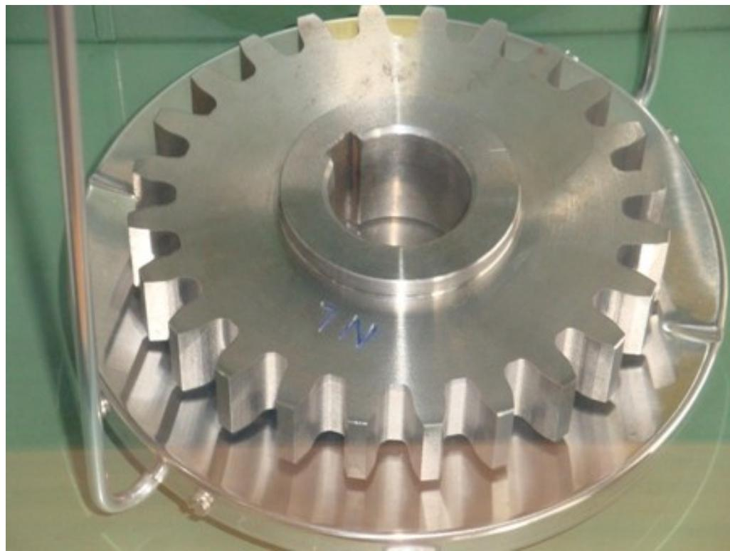
Slika 3.5. Veći ( pogonski) zupčanik s evolventnim oblikom zuba
