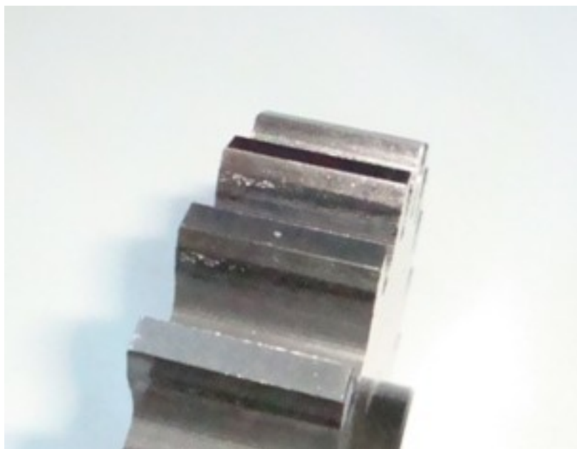
Slika 4.2.4.2. Površina zuba NL zupčanika nakon ispitivanja
