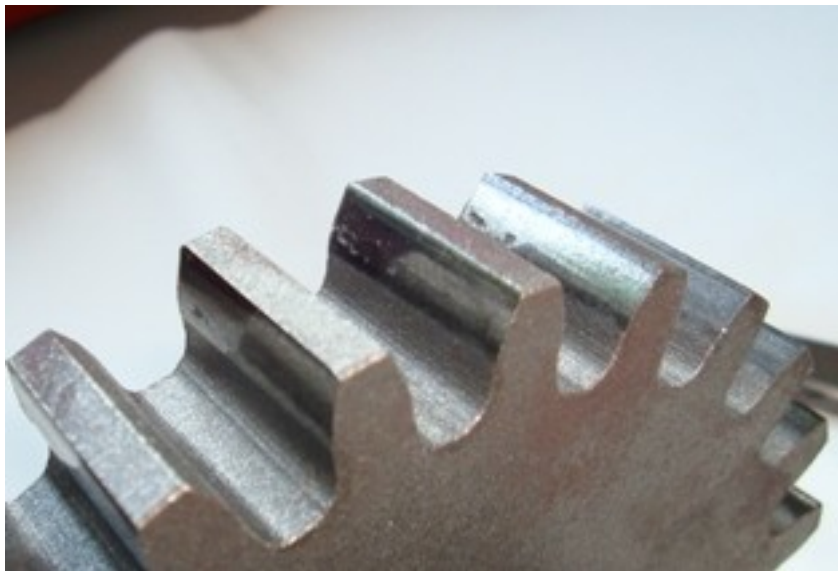
Slika 4.2.4.8. Površina zuba NL 380K zupčanika nakon ispitivanja
