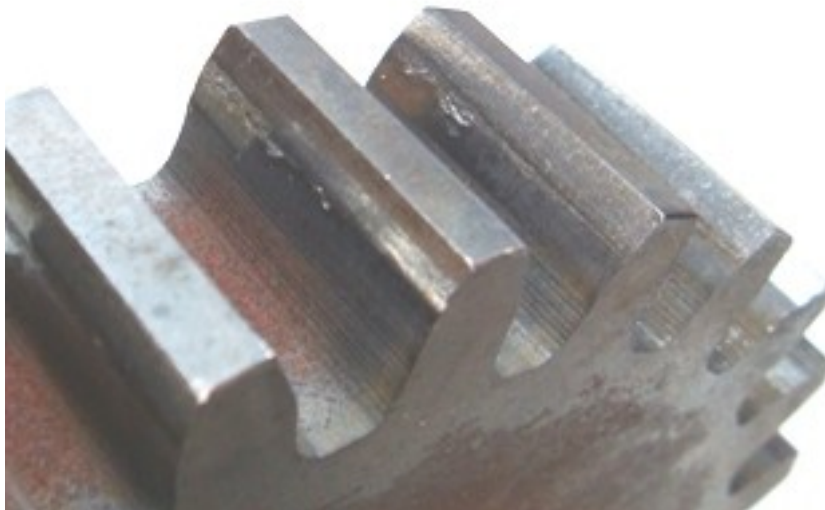
Slika 4.2.4.6 Površina zuba NL 240 zupčanika nakon ispitivanja
