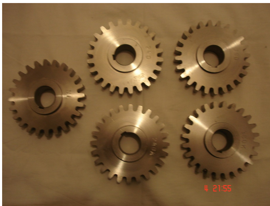
Slika 4.1.3. Izrađeni zupčanici spremni za toplinsku obradu i kugličarenje
