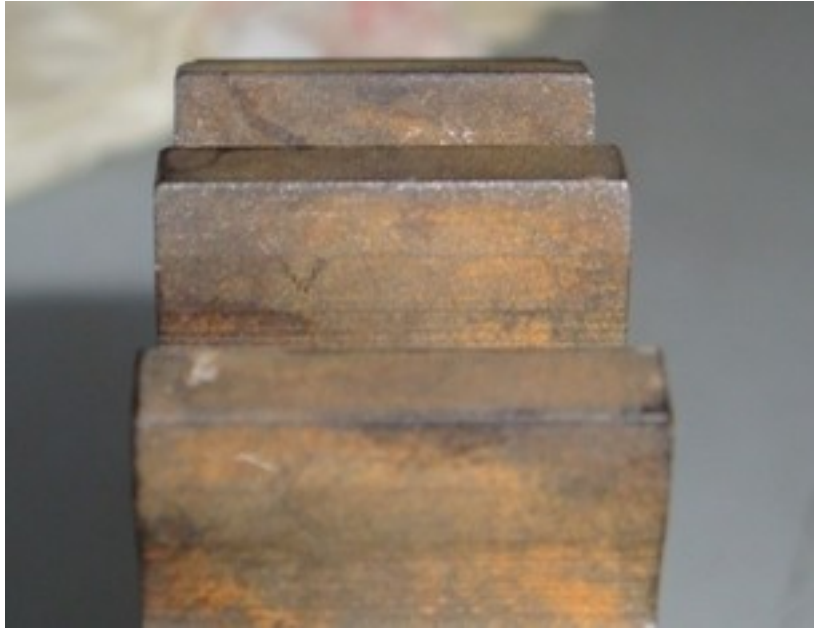
Slika 4.2.4.3. Površina zuba NL 380 zupčanika prije ispitivanja
