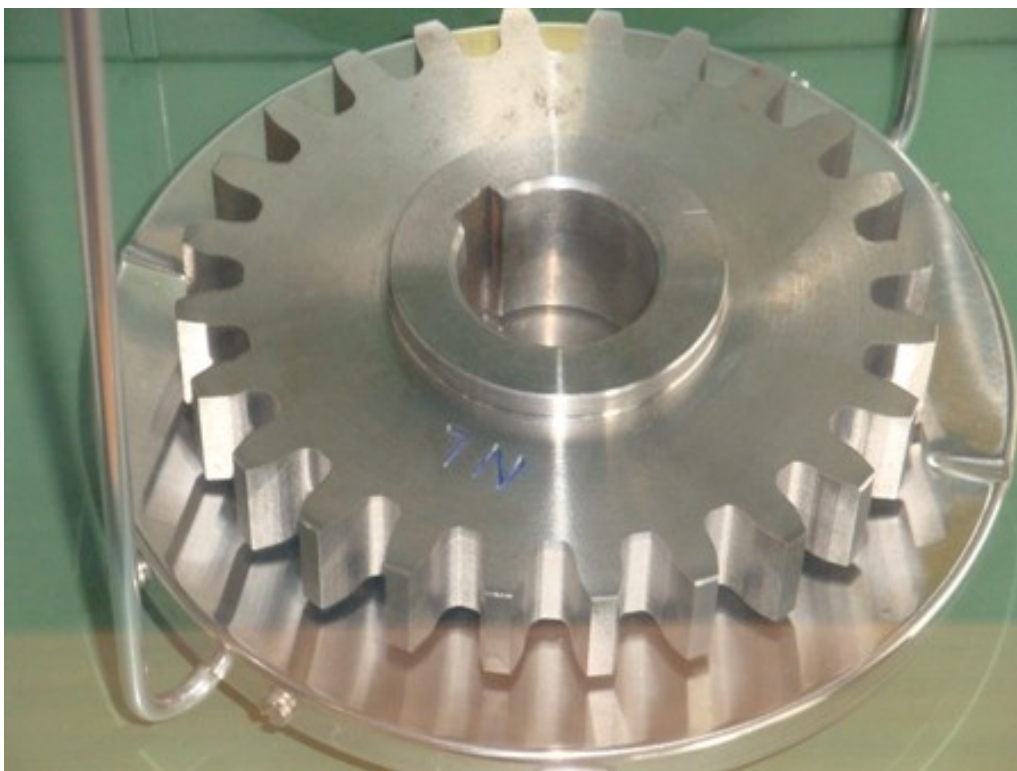
Slika 3.5. Veći ( pogonski) zupčanik s evolventnim oblikom zuba
