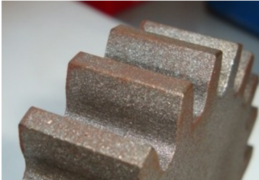
Slika 4.2.4.7. Površina zuba NL 380K zupčanika prije ispitivanja
