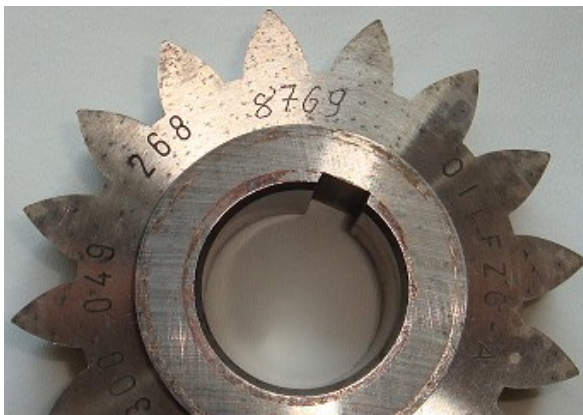
Slika 3.4. Oblik boka zuba manjeg zupčanika
