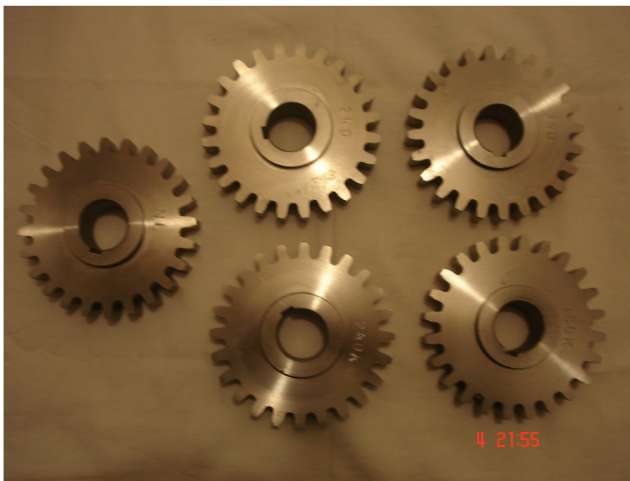
Slika 4.1.3. Izrađeni zupčanicu spremni za toplinsku obradu i kugličarenje
