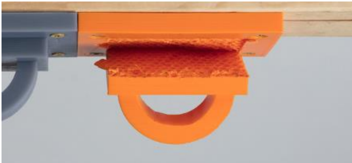
Slika 4. Primjer slomljenog modela pod opterećenjem
