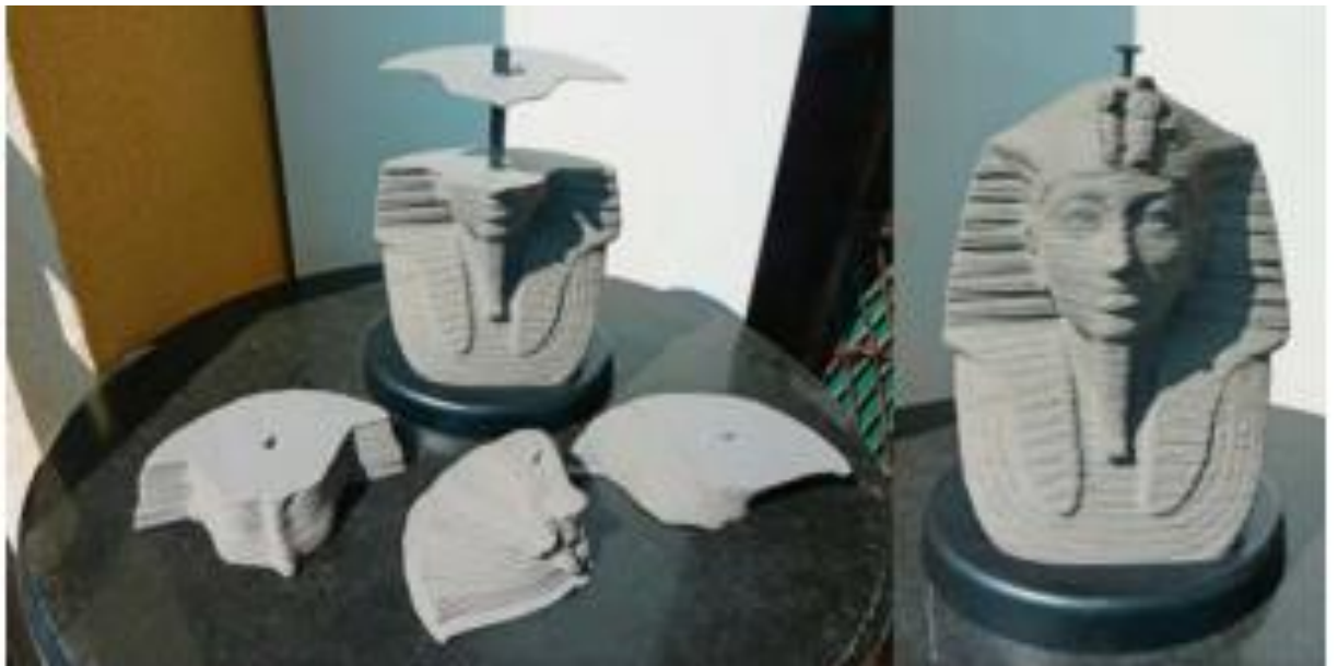
Slika 1. Princip aditivnih postupaka proizvodnje prototipova: a – prikaz slaganja slojeva, b – 3D tvorevina [3]
