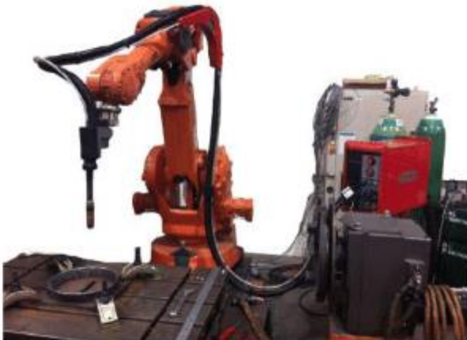
Slika 8. Robot za zavarivanje sa šest osi gibanja [6]
