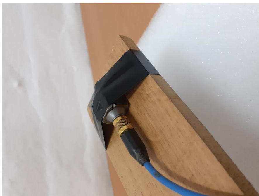
Slika 4.6 uzorak pričvršćen trakom za aktuator
