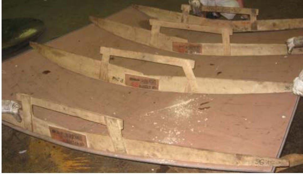
Slika 14. Kontrola zakrivljenosti drvenim šablonama
