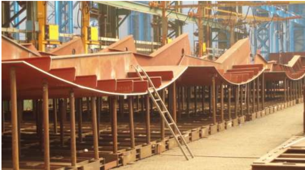
Slika 52. Izrada zakrivljenih sekcija na podesivim uporama (jiggovima)
