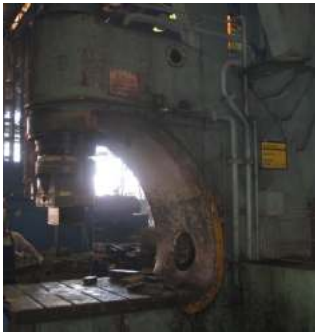
Slika 15. G preša za oblikovanje limova
