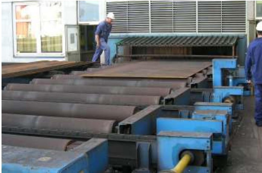
Slika 7. Valjčasta staza na ulazu u predobradu
