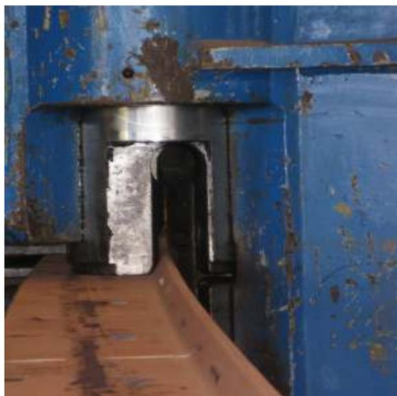
Slika 16. Preša za savijanje profila metodom uzdužnog pomaka
