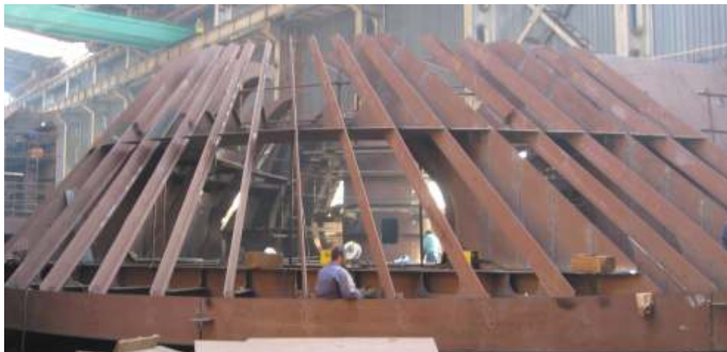
Slika 46. Lepezasta rebra i proveza 5. palube
