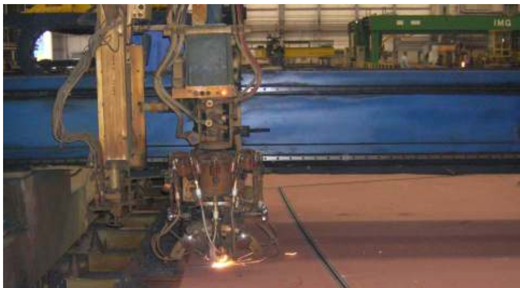
Slika 10. Stroj za rezanje limova acetilenom i kisikom (oxy)
