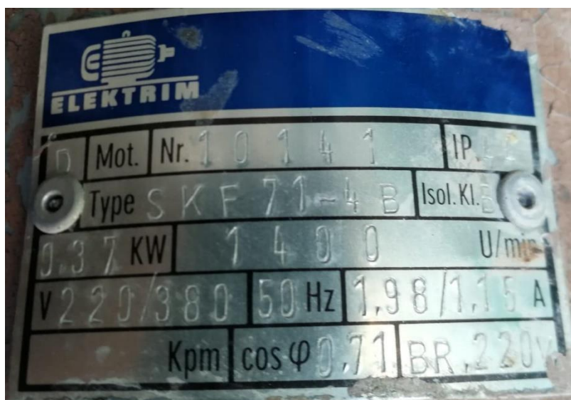
Slika 27: Pločica elektromotora Elektrim SKF 71-4B
