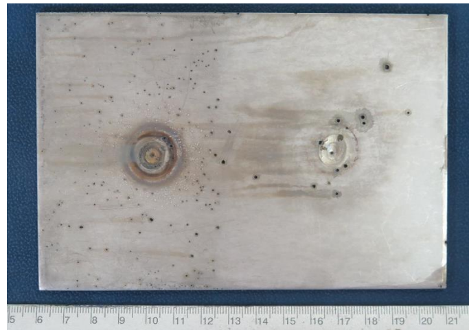
Slika 30. Uzorak čelika AISI 316Ti (EN 1.4571) nakon korozijskog ispitivanja. Nešto manja otpornost od čelika AISI 316L.
