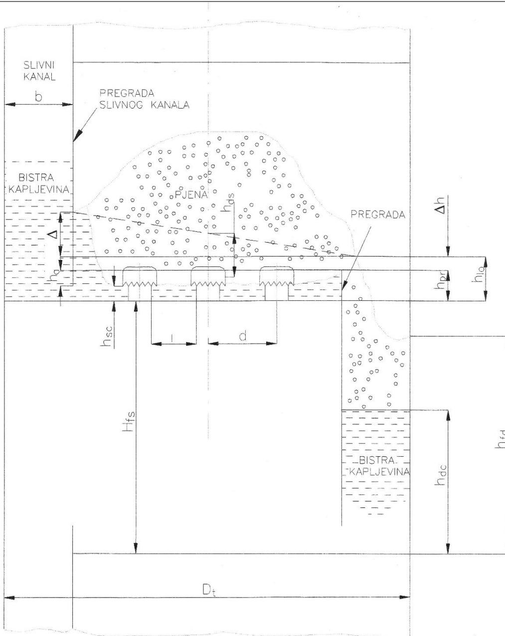
Slika 25. Presjek kolone po visini uz prikazane dimenzije
