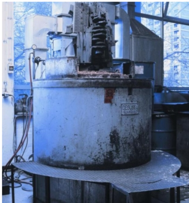
Slika 46: Pe za nitriranje Tenifer postupkom, [20]
