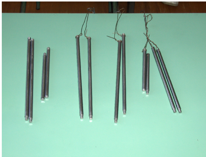
Slika 48: Uzorci vezani čeličnom žicom
