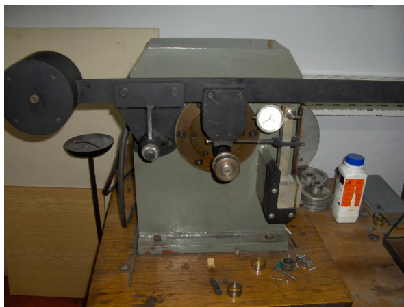
Slika 83: Uređaj za ispitivanje otpornosti na adhezijsko trošenje
