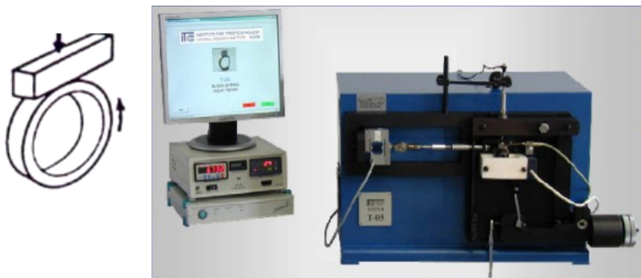
Slika 23: Prikaz uređaja za ispitivanje bloc on ring, [8]
