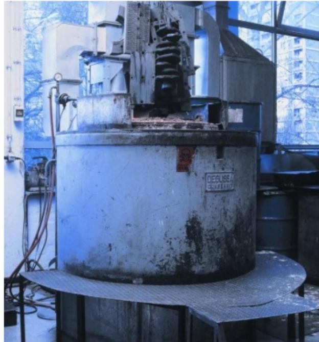
Slika 46: Pe za nitriranje Tenifer postupkom, [20]
