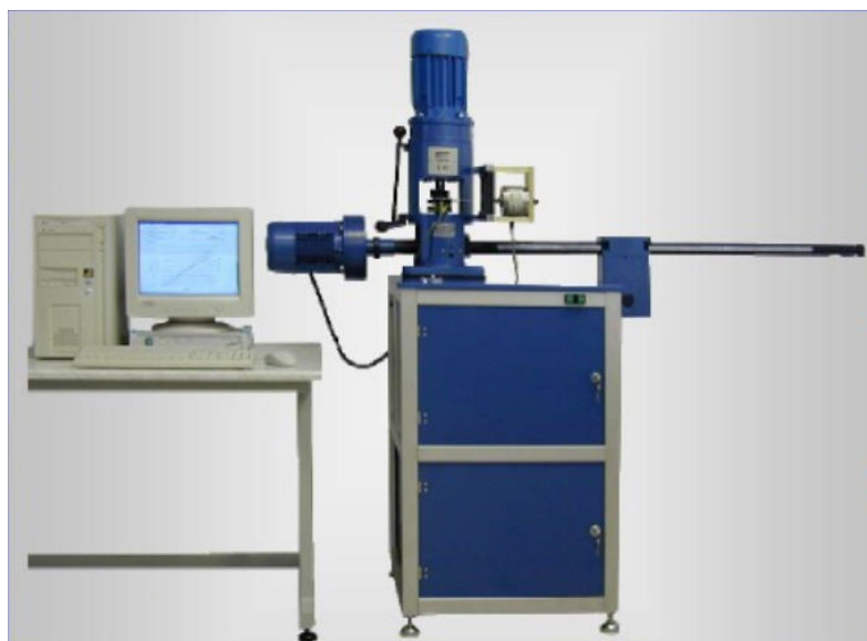
Slika 19: Prikaz uređaja za ispitivanje metodom 4 kuglice, [8]
