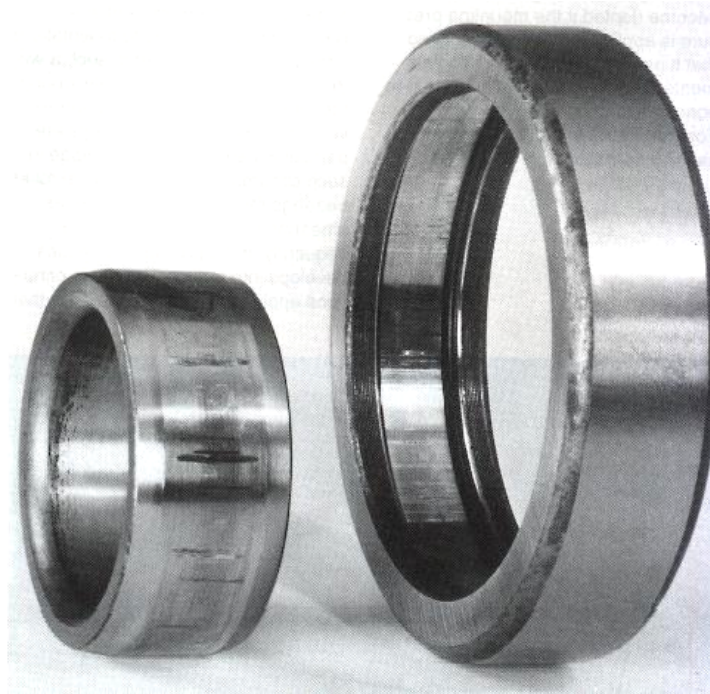
Slika 2: Istrošenost unutarnjeg i vanjskog prstena valjanog ležaja, [4]
