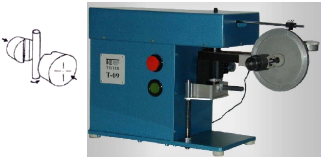
Slika 24: Prikaz uređaja za ispitivanje bloc on pin, [8]
