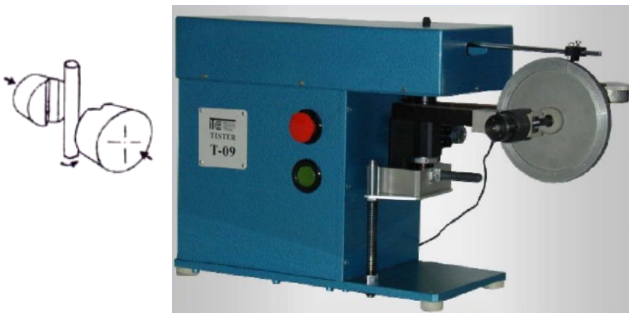
Slika 24: Prikaz uređaja za ispitivanje bloc on pin, [8]
