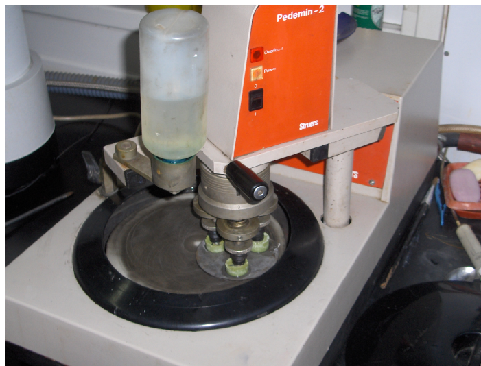
Slika 61: Uređaj za brušenje i poliranje, [20]
