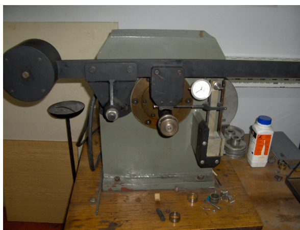
Slika 83: Uređaj za ispitivanje otpornosti na adhezijsko trošenje
