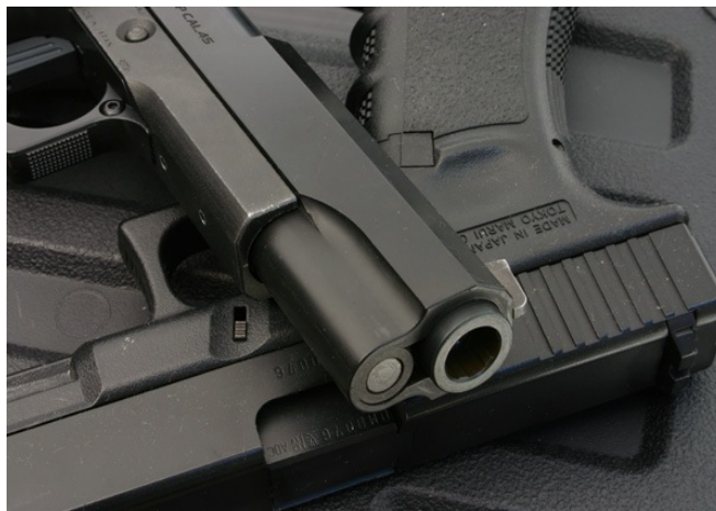
Slika 45: Oružje obrađeno oksidacijom, [18]
