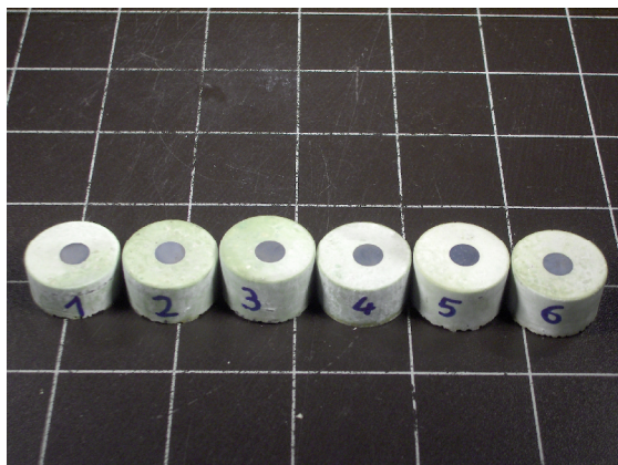
Slika 60: Izgled uzoraka nakon vađenja iz kalupa
