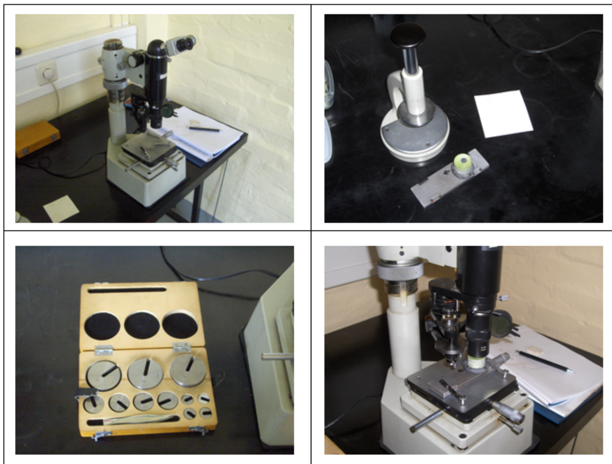
Slika 69: Mjerenje mikrotvrdo e
