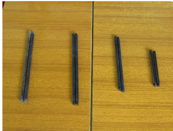
Slika 55: Uzorci nakon toplinsko kemijske obrade
