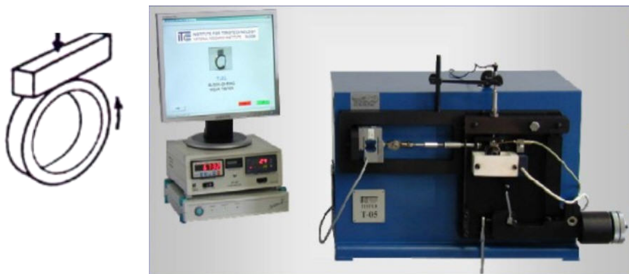
Slika 23: Prikaz uređaja za ispitivanje bloc on ring, [8]
