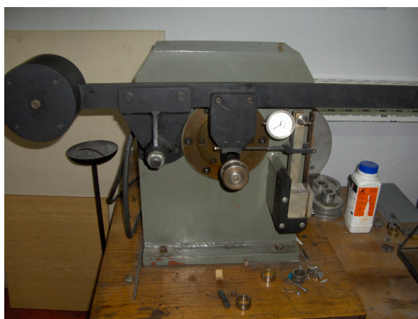
Slika 83: Uređaj za ispitivanje otpornosti na adhezijsko trošenje
