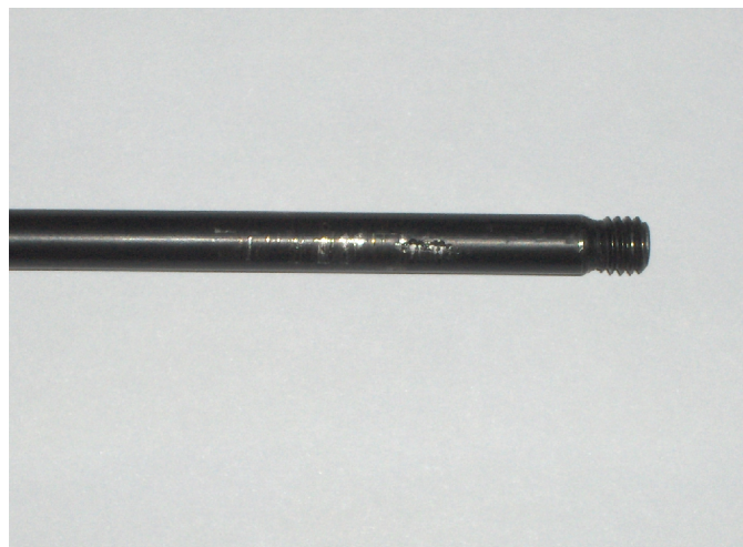
Slika 32: Primjer mehaničkog oštećenja klipnjače
