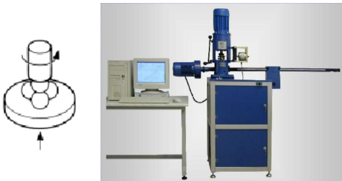
*Slika 19: Prikaz uređaja za ispitivanje metodom 4 kuglice, [8]*
