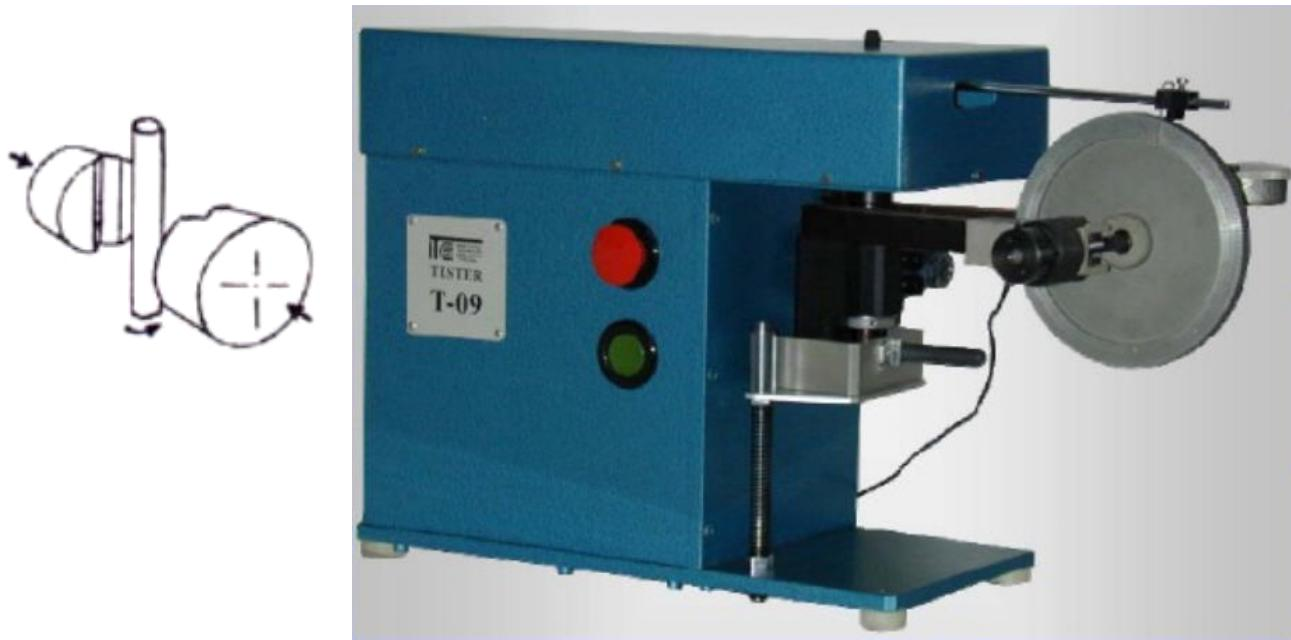
Slika 24: Prikaz uređaja za ispitivanje bloc on pin, [8]
