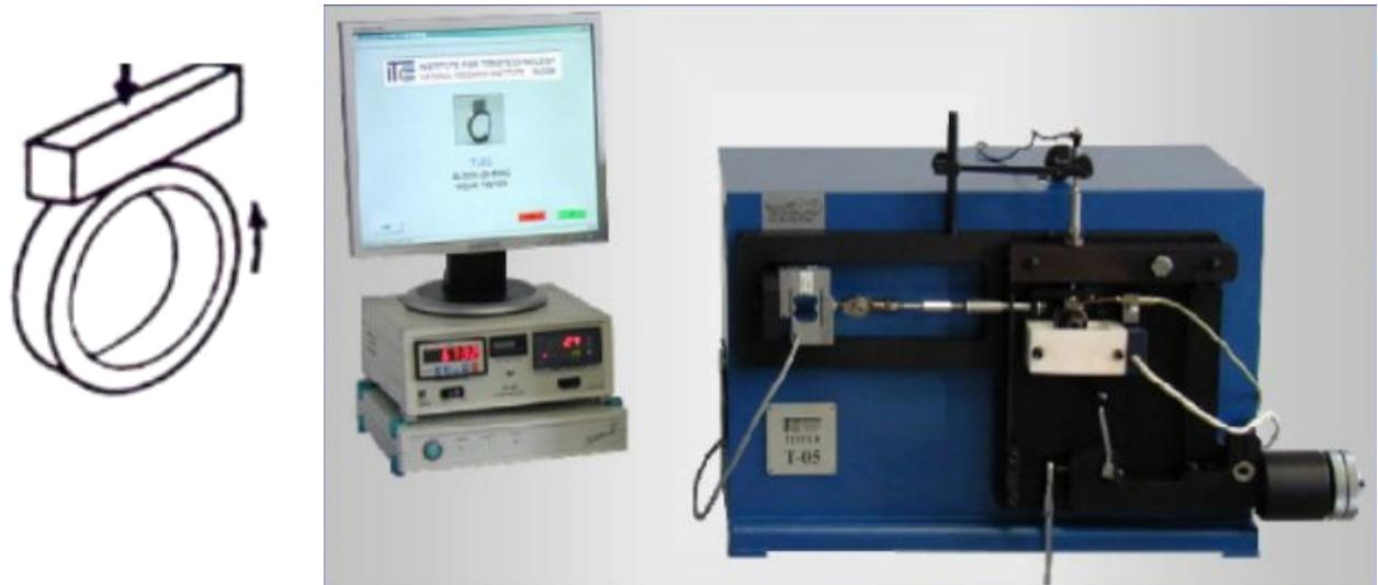
Slika 23: Prikaz uređaja za ispitivanje bloc on ring, [8]
