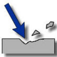
Slika 10: Erozjsko trošenje, [7]
