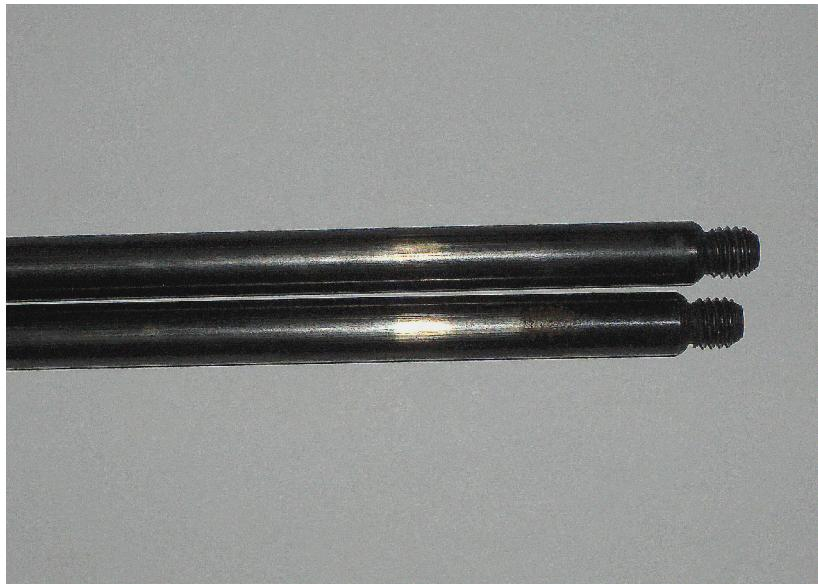
Slika 33: Primjer istrošenosti klipnja.
