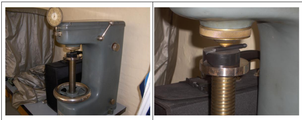
Slika 79: Mjerenje makrotvrdo e
