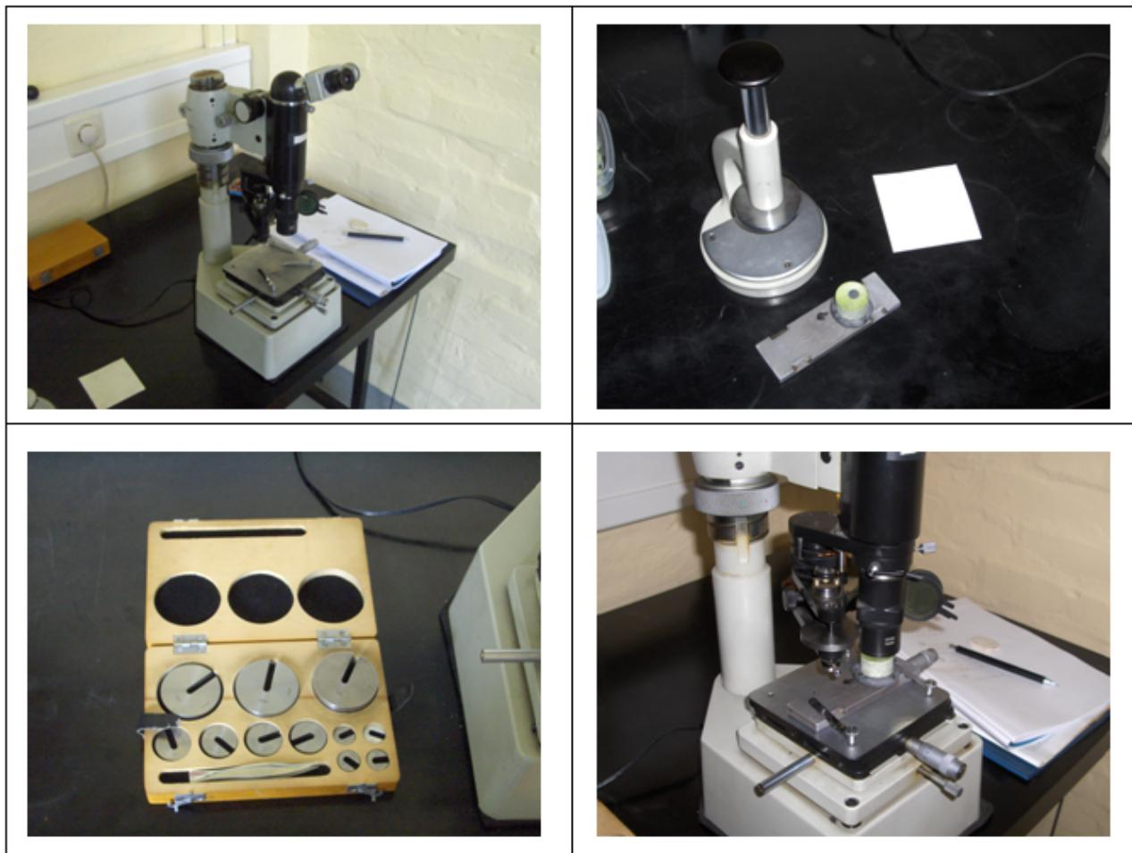
Slika 69: Mjerenje mikrotvrdoće
