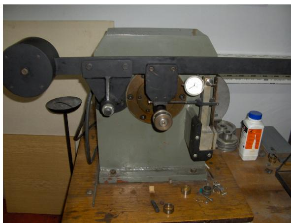
*Slika 83: Urejava za ispitivanje otpornosti na adhezijsko trošenje*
