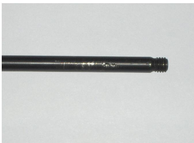
Slika 32: Primjer mehaničkog oštećenja klipnja.
