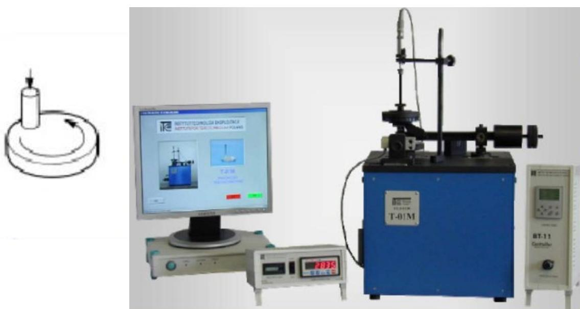
*Slika 22: Prikaz uređaja za ispitivanje pin on disc, [8]*
