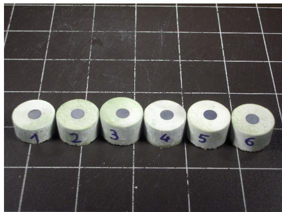
*Slika 60: Izgled uzoraka nakon vanja iz kalupa*
