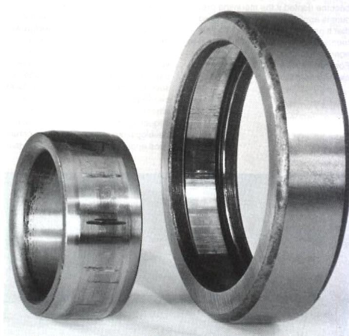
Slika 2: Istrošenost unutarnjeg i vanjskog prstena valjanoog ležaja, [4]
