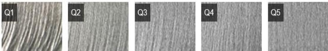
Slika 15. Kvaliteta površine reza ovisno o posmičnoj brzini [15]
