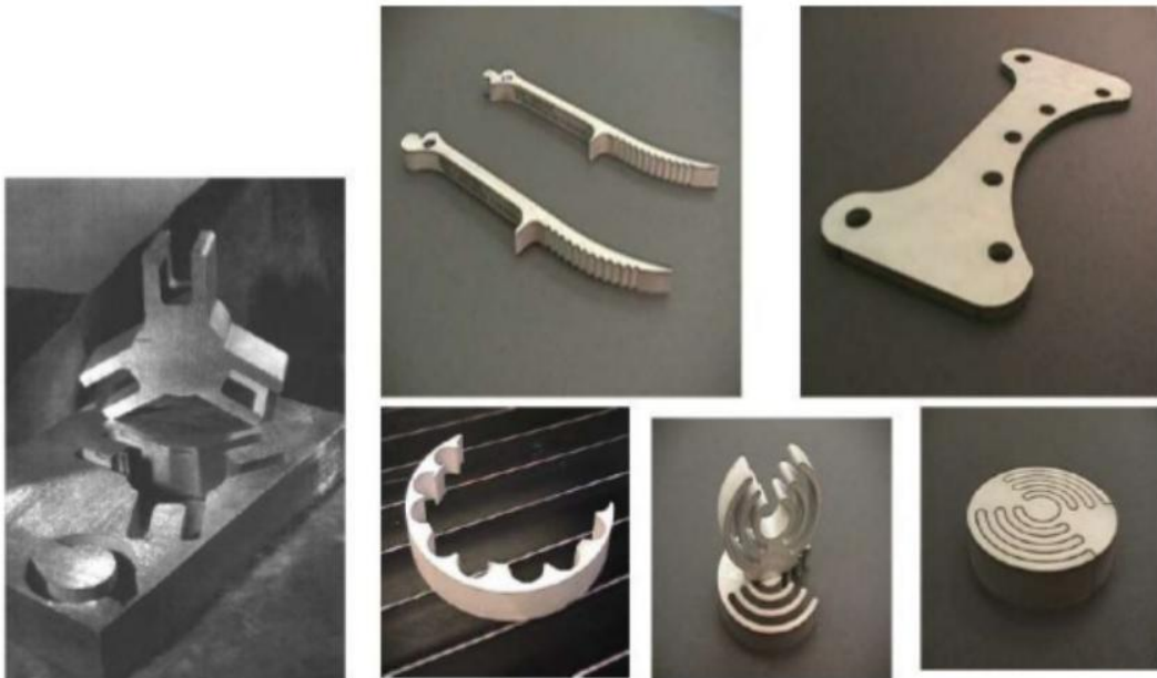
Slika 12. Dijelovi izrađeni AWJM postupkom [17]
