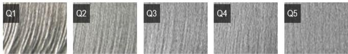
Slika 15. Kvaliteta površine reza ovisno o posmičnoj brzini [15]
