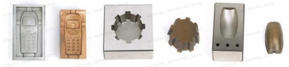
Slika 22. Prikaz izrade kalupa pomoću EDM žiga [23]
