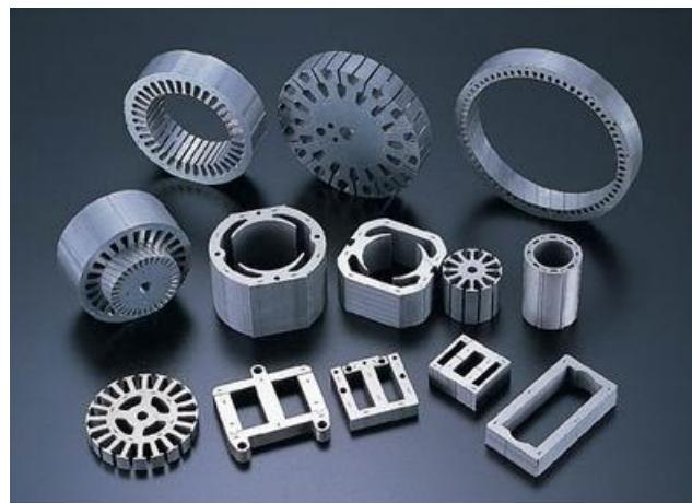
Slika 29. Dijelovi izrađeni primjenom WEDM postupka [30]
