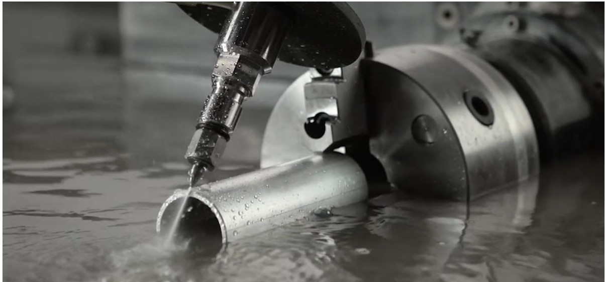
Slika 16. Višeosna AWJM obrada [20]
