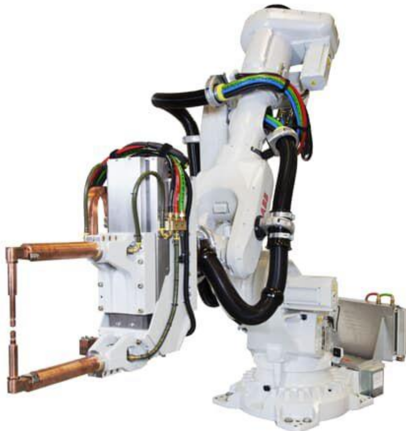
Slika 16. Robot za točkasto elektrootporno zavrivanje [23]
