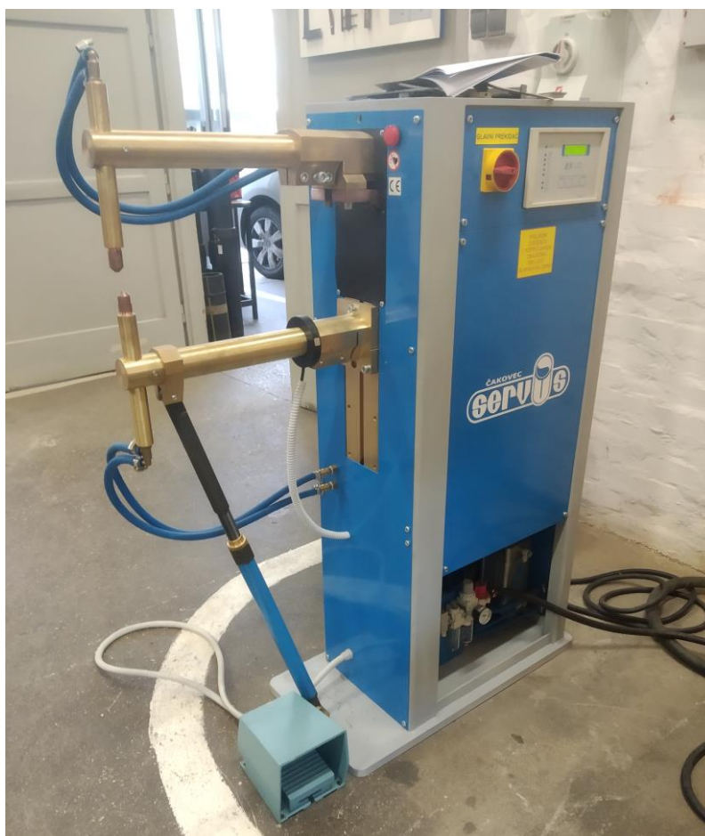
Slika 18. Stroj za točkasto elektrootporno zavarivanje TV – 15 PKS
