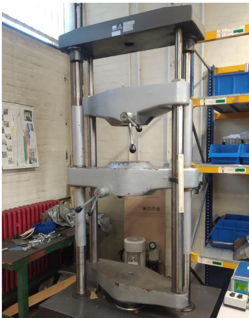
Slika 30. Kidalica EU 40 mod
