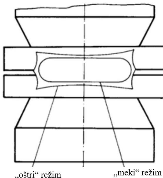
Slika 7. Prikaz oblika zavara ovisno o režimu zavarivanja [9]
