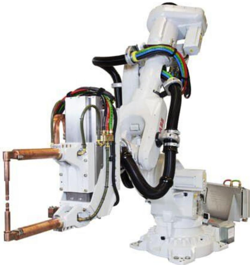
**Slika 16. Robot za točkasto elektrootporno zavrvanje [23]**
