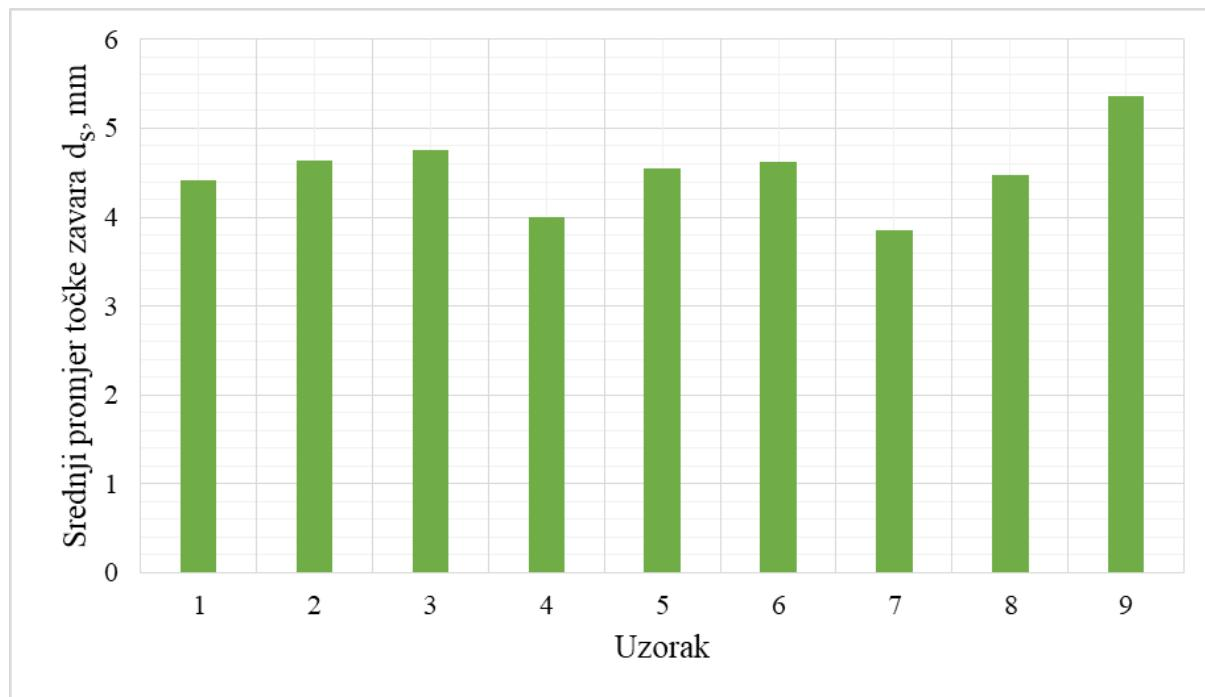
**Slika 28.** Grafički prikaz srednjeg promjera točke zavara
