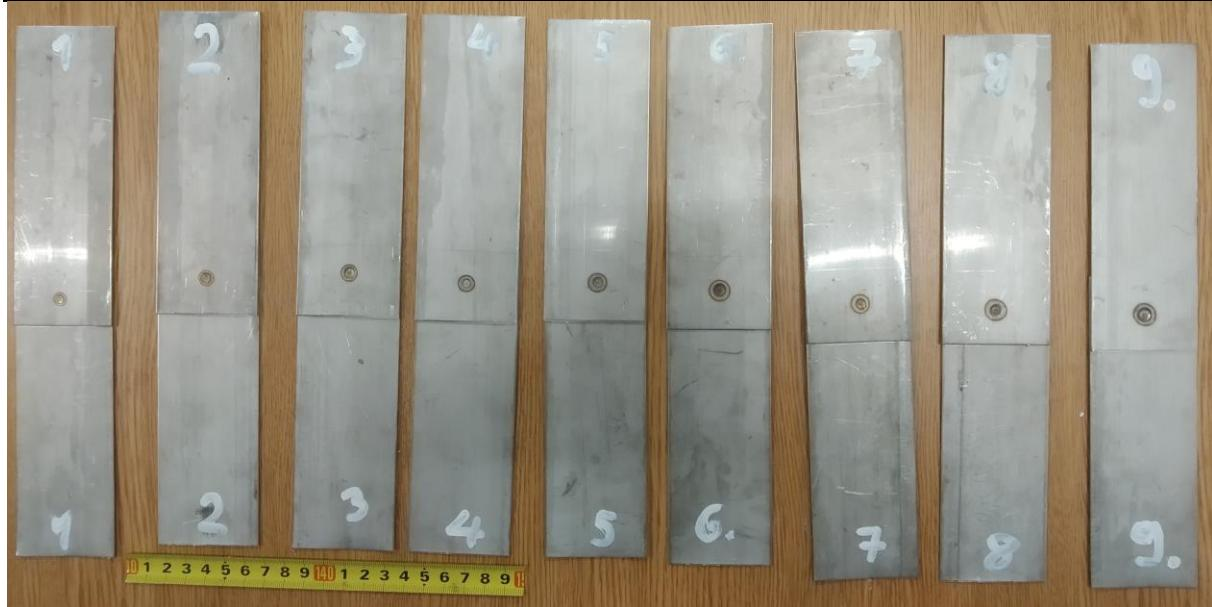
Slika 23. Gornja strana ispitnih uzoraka (kontakt: radni komad – pomicna elektroda)
