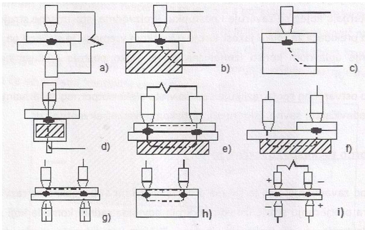
Slika 6. Osnovni načini izvođenja točkastog zavarivanja [1]
