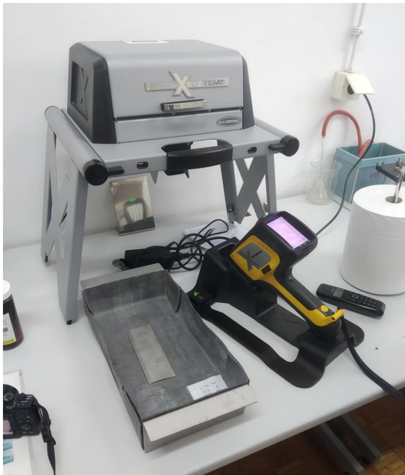
Slika 21. Oprema za analizu kemijskog sastava čelika
