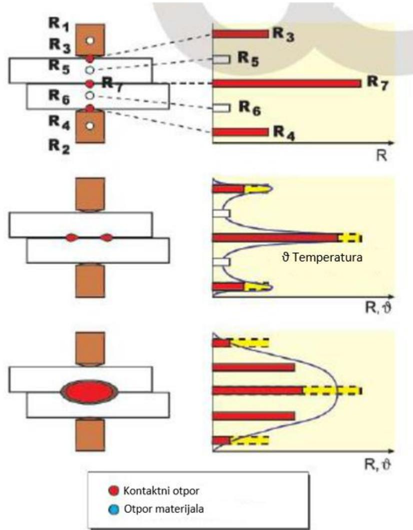
Slika 5. Vrijednosti otpora u ovisnosti o temperaturi [8]
