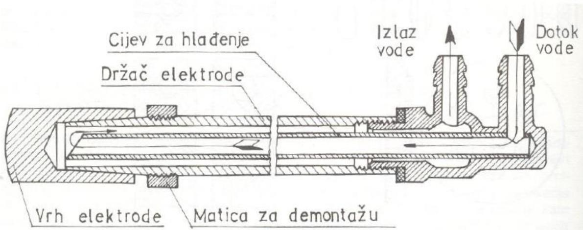
Slika 9. Cilindrična ravna elektroda za točkasto zavarivanje [8]
