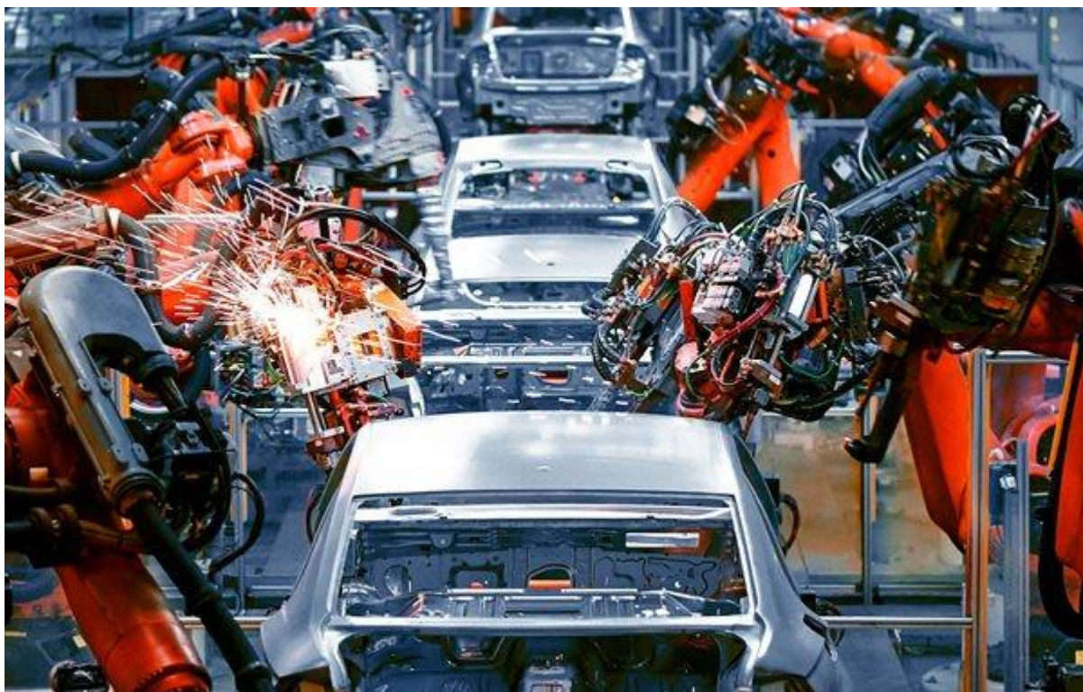
Slika 17. Primjena robotiziranog elektrootpornog točkastog zavarivanja u automobilskoj industriji [21]
