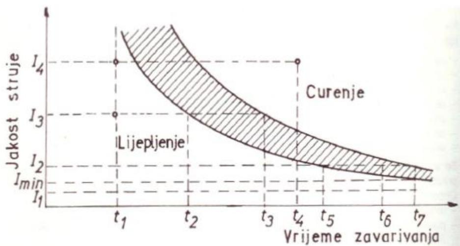
**Slika 8. Ovisnost jakosti struje i vremena zavarivanja kod točkastog zavarivanja (dijagram karakterističan za svaki metal) [8]**
