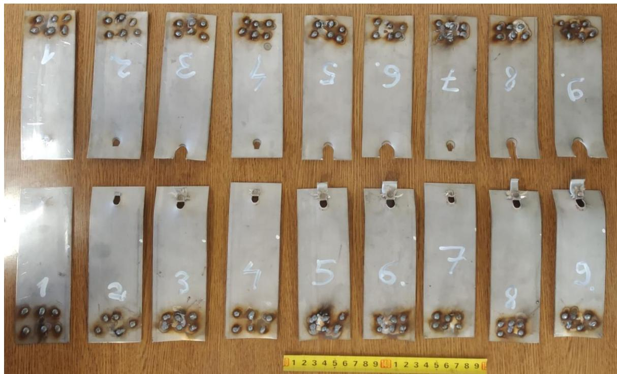
**Slika 31. Ispitni uzorci nakon ispitivanja na kidalici**
