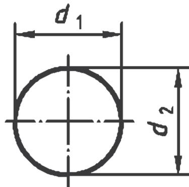
**Slika 27. Prikaz mjerenja promjera zavara prema normi ISO 14329 – 2003 [27]**
