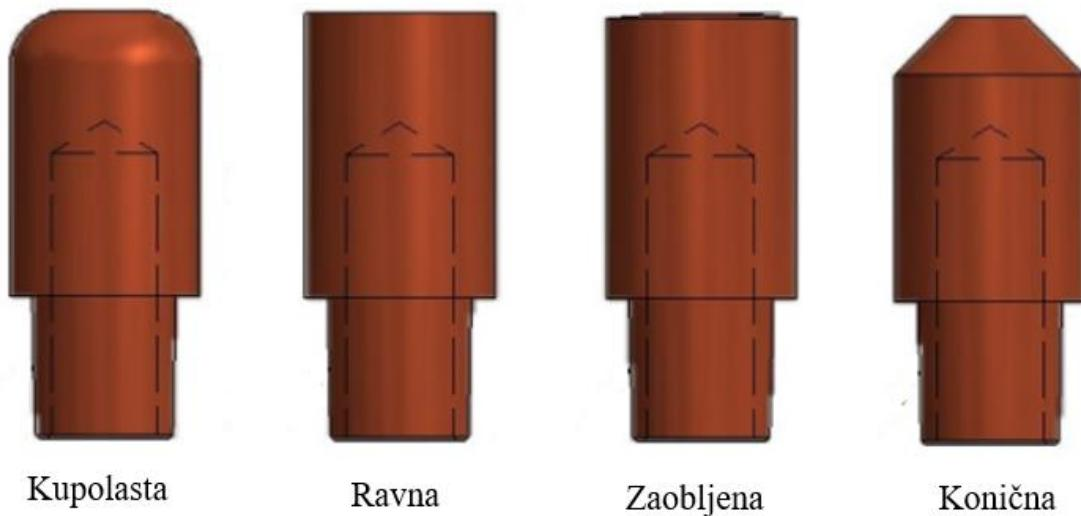
Slika 11. Najčešće korištene elektrode za točkasto elektrootporno zavarivanje [14]
