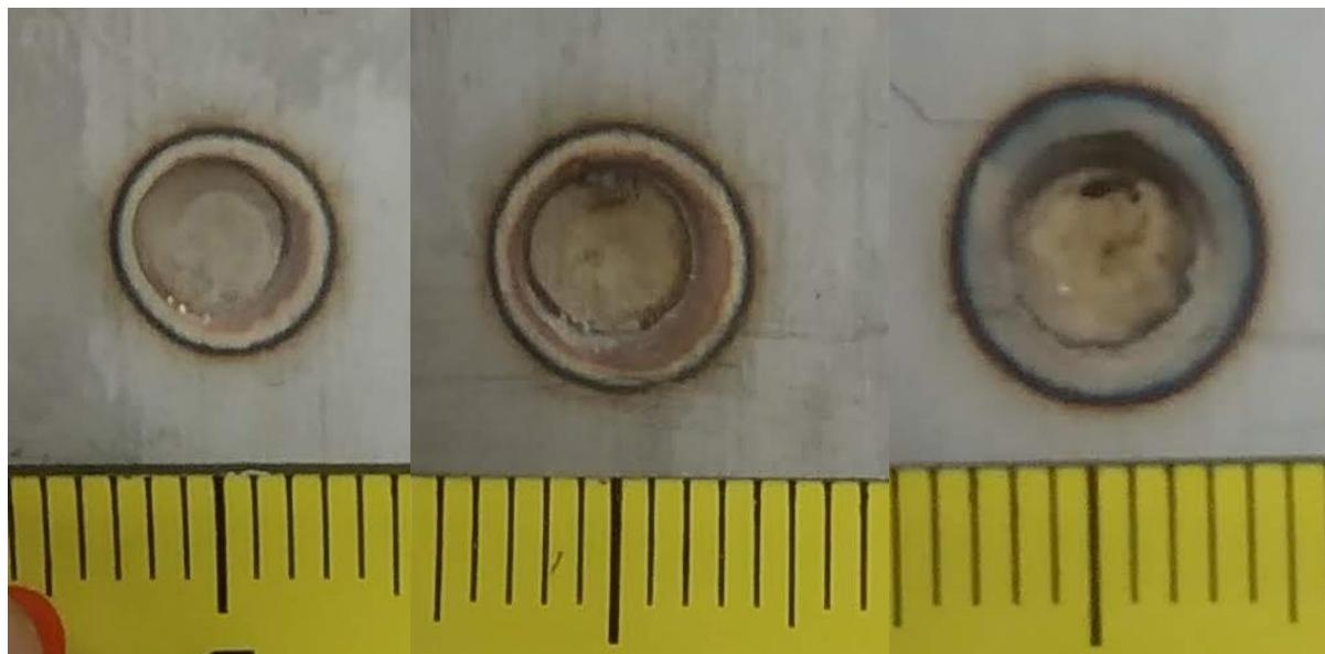
Slika 24. Prikaz zavara za ispitne uzorke 1, 2 i 3
