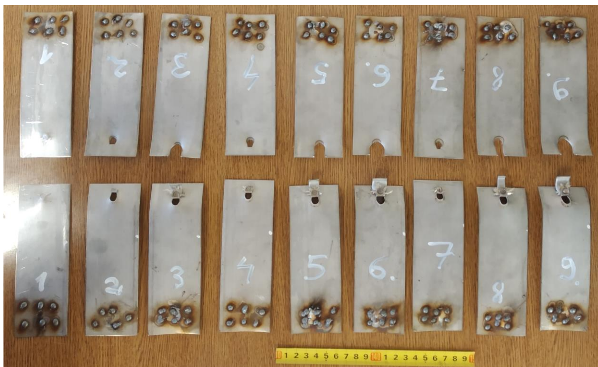
Slika 31. Ispitni uzorci nakon ispitivanja na kidalici
