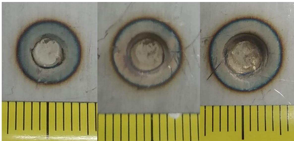
Slika 25. Prikaz zavara za ispitne uzorke 4, 5 i 6
