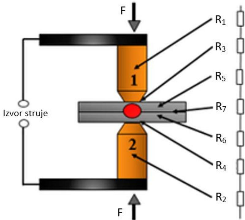
Slika 4. Otpori kod točkastog elektrootpornog zavarivanja [7]
