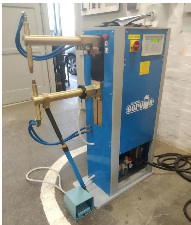
Slika 18. Stroj za točkasto elektrootporno zavarivanje TV – 15 PKS
