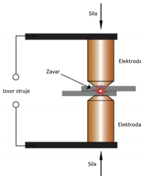
Slika 2. Opći prikaz točkastog elektrootpornog zavarivanja [5]
