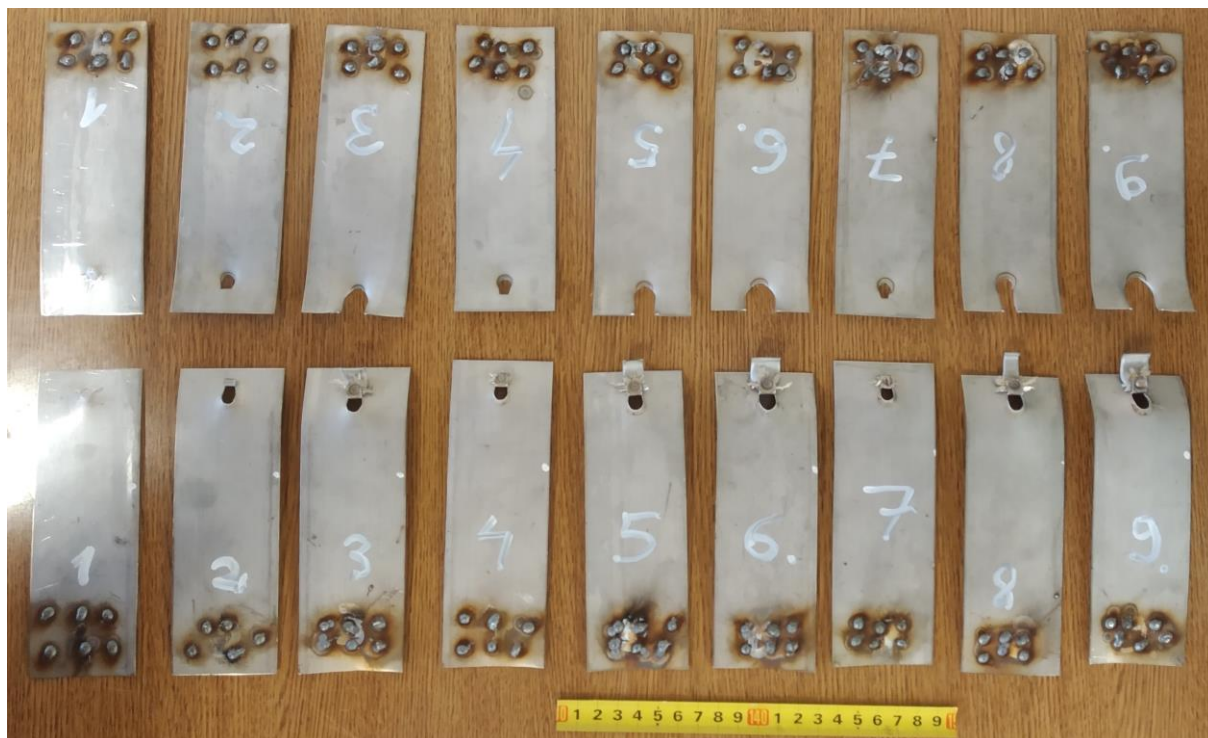
Slika 31. Ispitni uzorci nakon ispitivanja na kidalici
