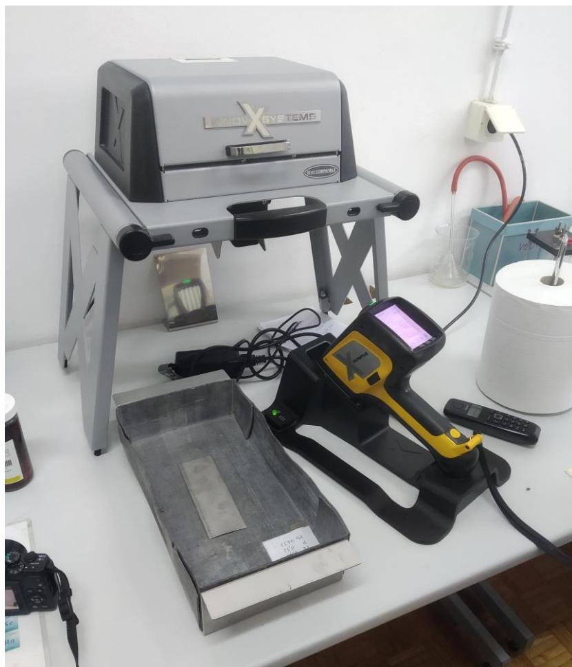
Slika 21. Oprema za analizu kemijskog sastava čelika
