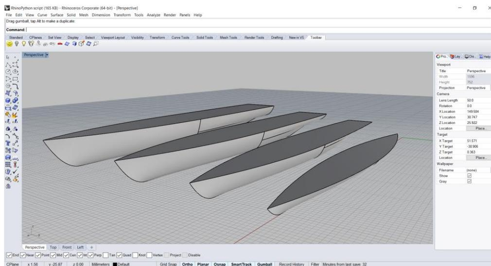
**Slika 23.** Volumeni dobiveni rezanjem brodske forme vodnim linijama [12]
