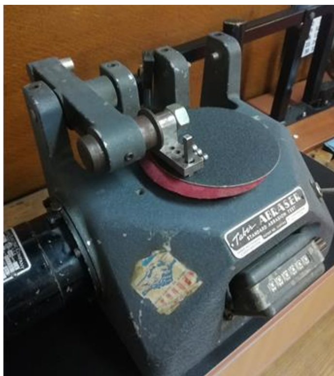
Slika 23. Uredaj za ispitivanje abrazijske otpornosti
