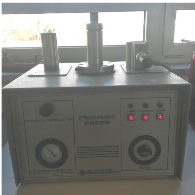
Slika 26. Uređaj za vruće ulijevanje uzoraka
