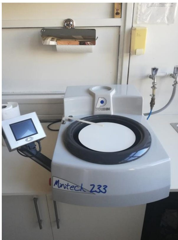
Slika 27. Uređaj za brušenje i poliranje
