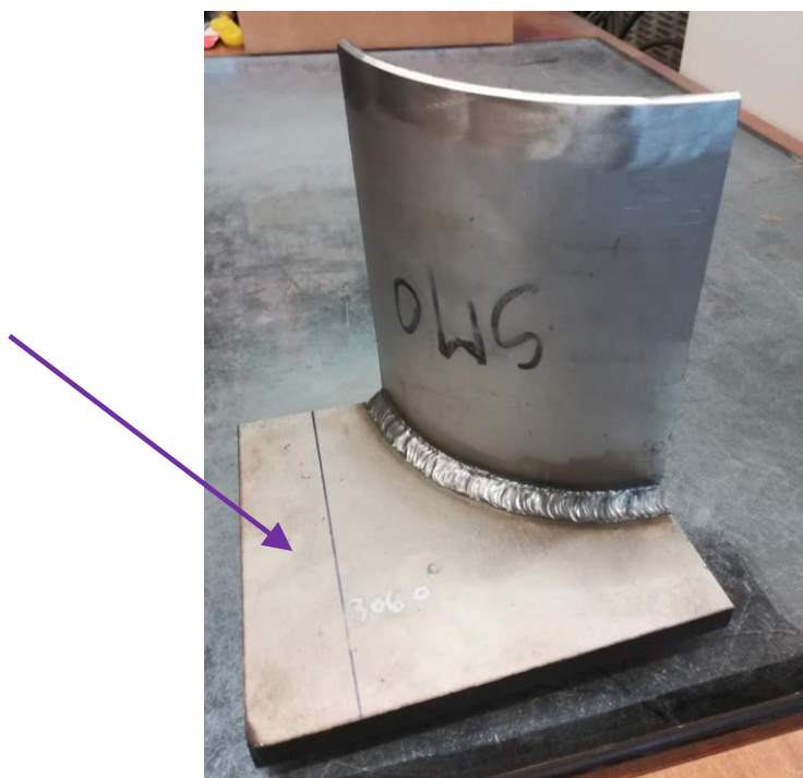
Slika 19. Čelična ploča iz koje su izrezani uzorci
