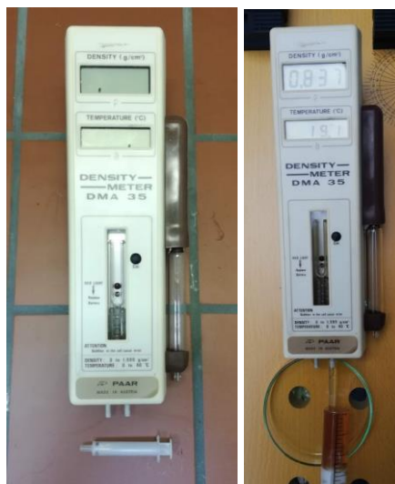
Slika 18. Prijenosni mjerjač gustoće DMA 35 i postupak mjerenja
