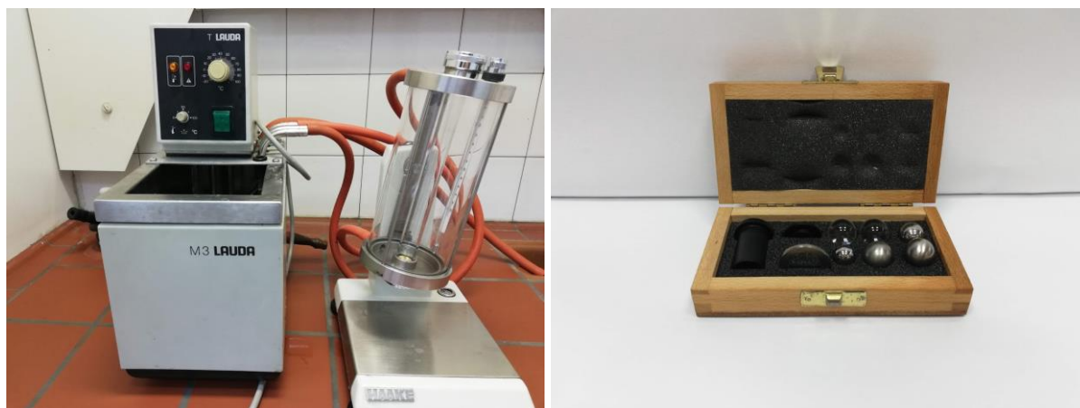
Slika 17. Höpplerov viskozimetar s pripadajućim kuglicama
