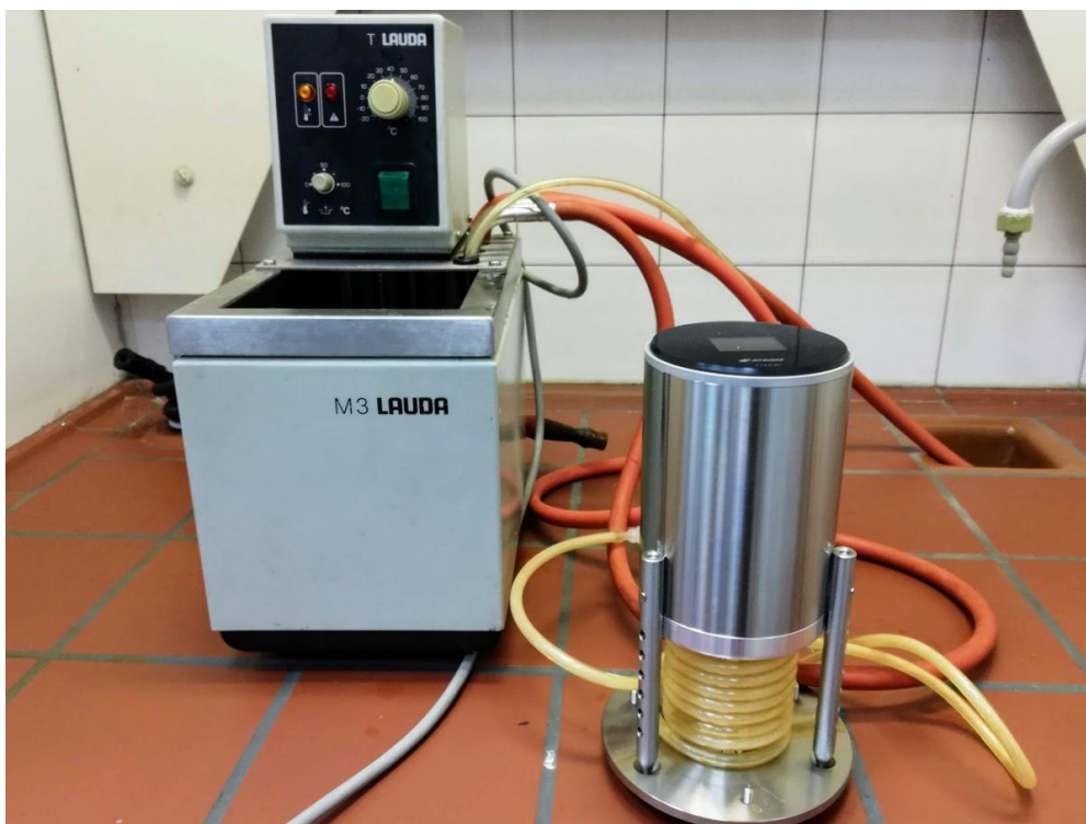
Slika 12. Linija za mjerenje viskoznosti rotacijskim viskozimetrom
