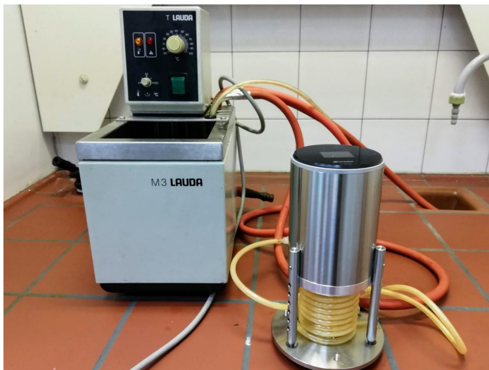
Slika 12. Linija za mjerenje viskoznosti rotacijskim viskozimetrom
