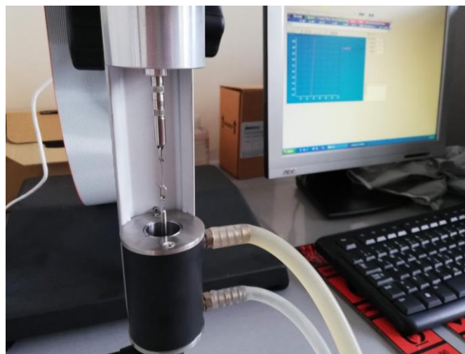
Slika 20. Komora, cilindar i visak
