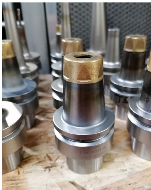
Slika 56. Coolcap prihvatni namijenjeni za hlađenje kroz glavno vreteno
