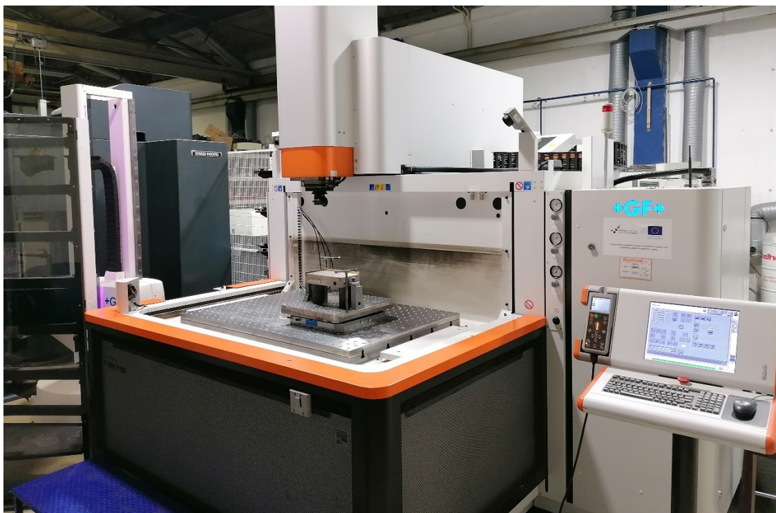
Slika 58. Eroziomat GF P800 s upravljačkom jedinicom
