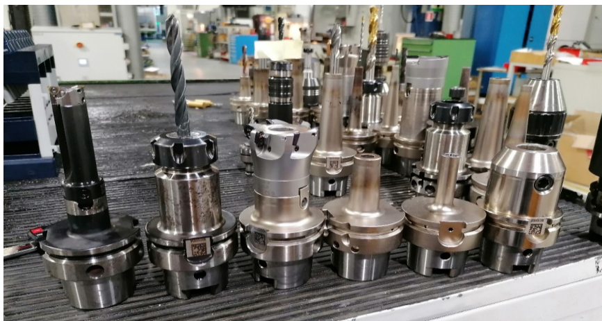
Slika 51. Nekoliko vrsta HSK prihvata alata
