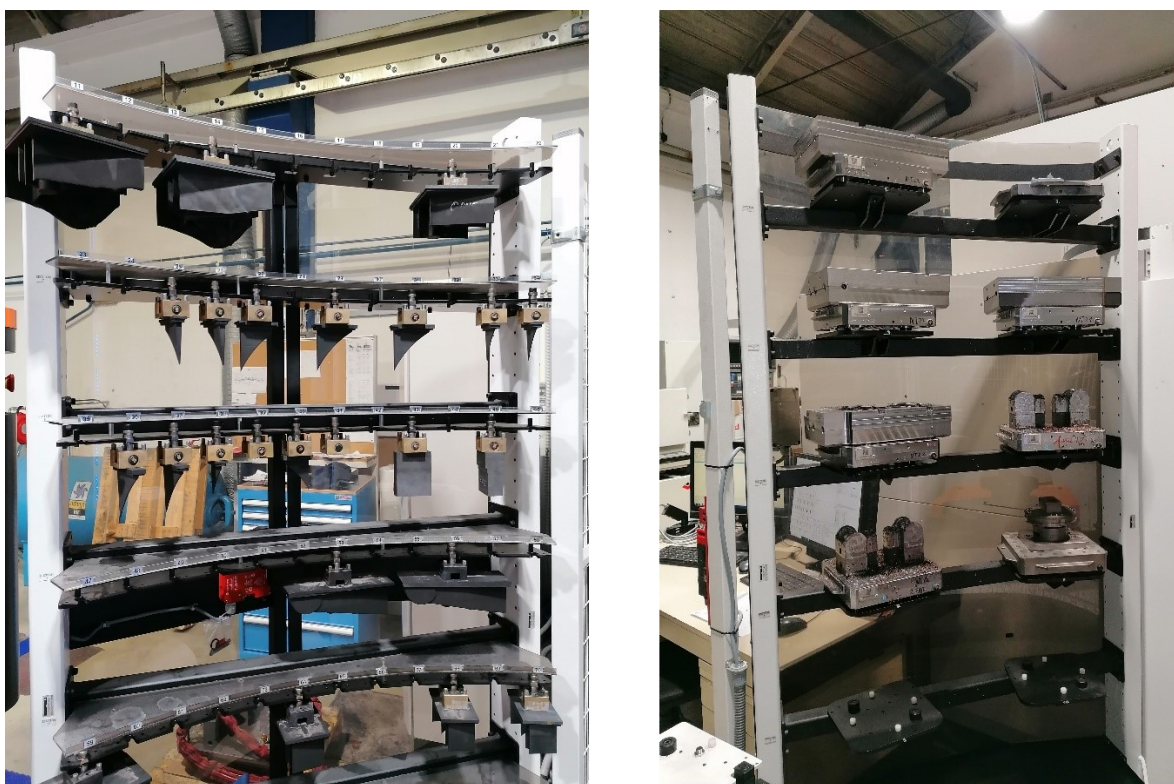
Slika 71. Spremište alata (elektroda) i obradaka
