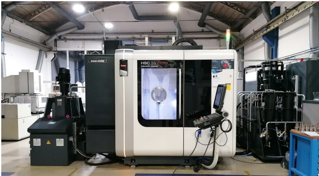
Slika 44. 5-osni glodači obradni centar DMG Mori HSC 55 Linear
